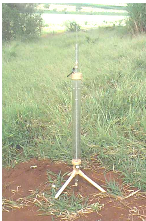
FIGURA 3.7 – Ensaio realizado com o Permeômetro Guelph no local AI1.
