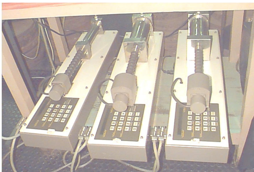
FIGURA 3.11 – Atuadores de pressão/volume utilizados na realização de ensaios do tipo tensão controlada.
