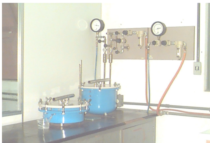
FIGURA 3.6 – Câmaras de pressão usadas para determinar a curva de retenção.
