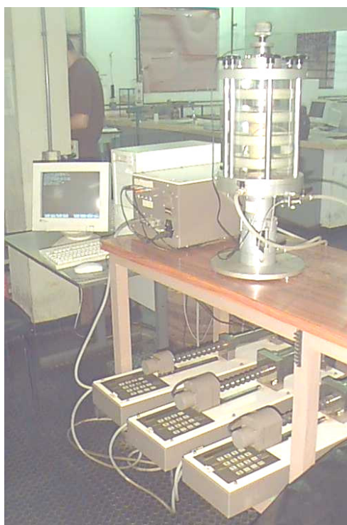
FIGURA 3.10 – Ensaio de compressão triaxial com a câmara de Bishop Wesley (GDS).
