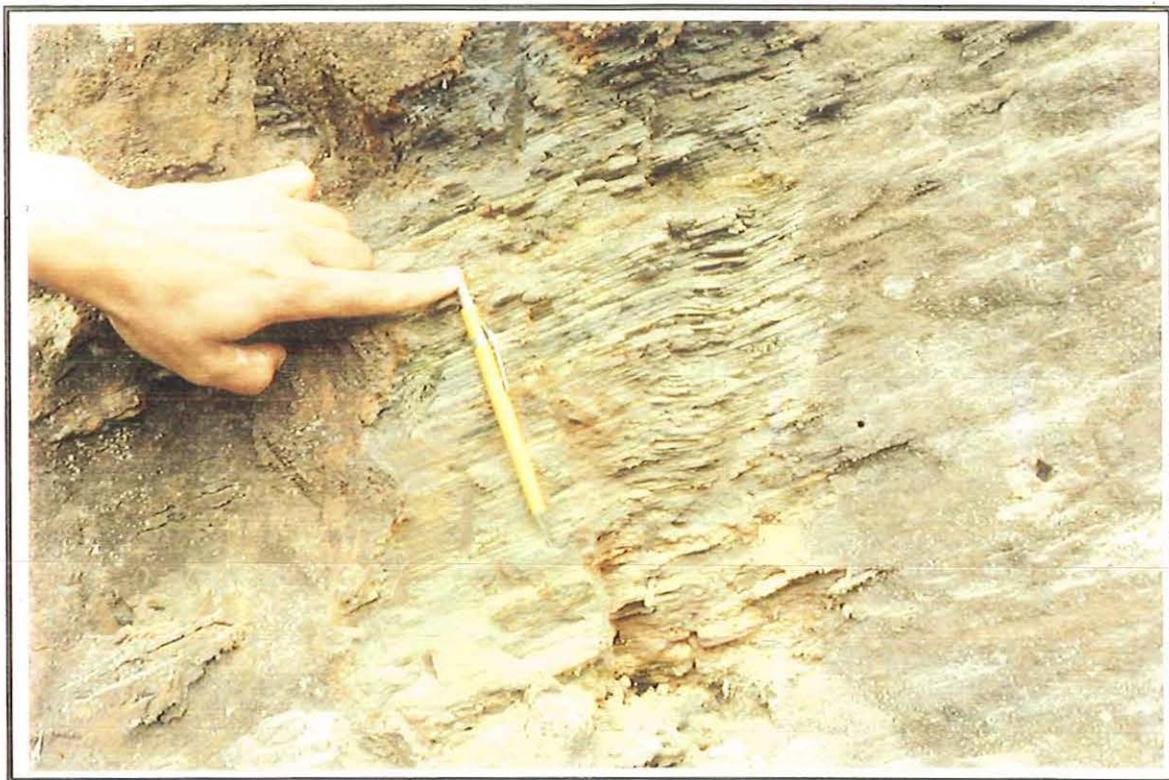
**FIGURA 4.7** - Afloramento de itabirito (mic), com presença de uma pequena falha.
