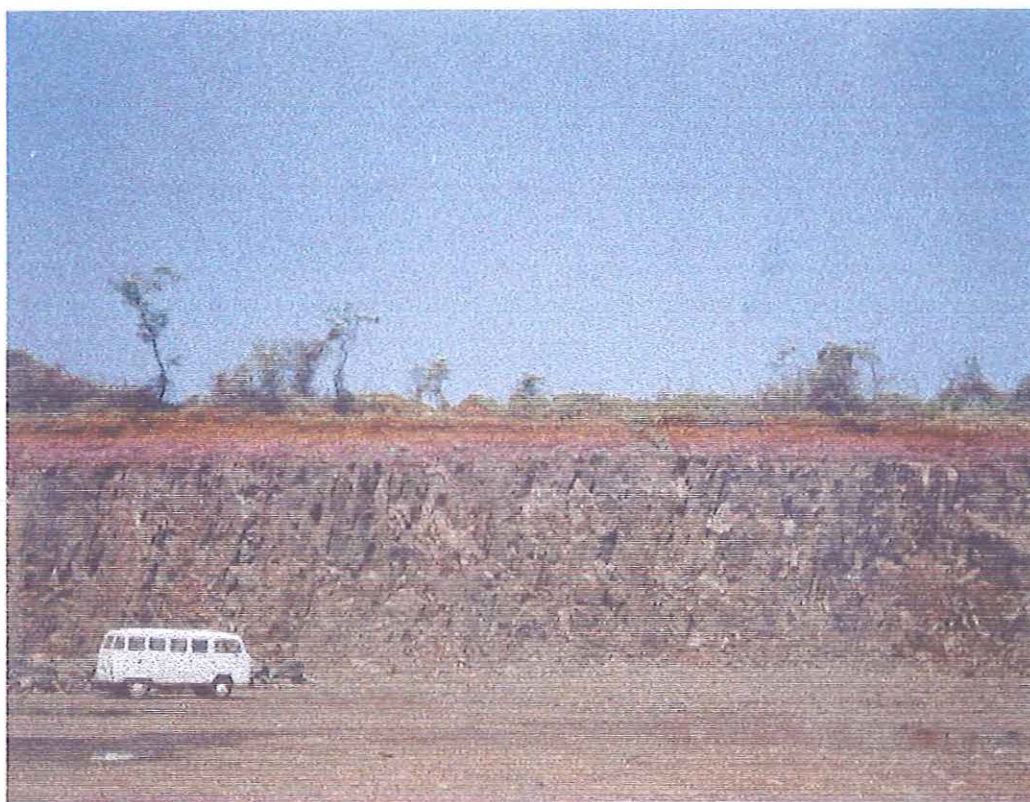
FIGURA 45. Solo residual de magmatitos basálticos, pouco profundo, ponto LM 26.
