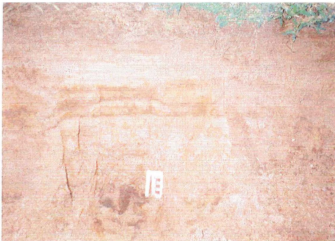
FIGURA 48. Perfil de alteração do arenito Pirambóia, ponto LM 31.
