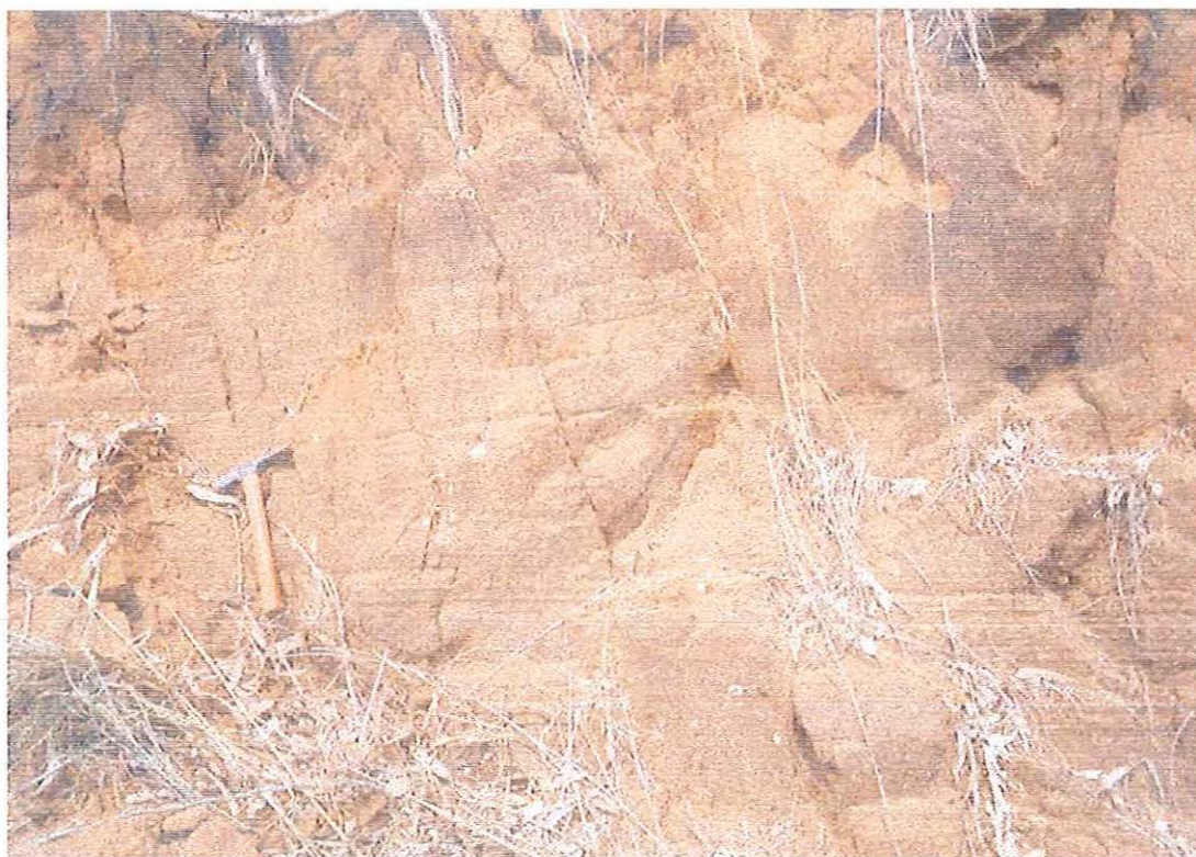
FIGURA 43. Fraturamento em arenito Botucatu, estratificado, de pequena persistência, ponto LM 33.
