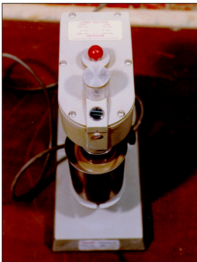
FIGURA 16 – Viscosímetro Fann empregado no laboratório para determinação de caldas de cimento.
