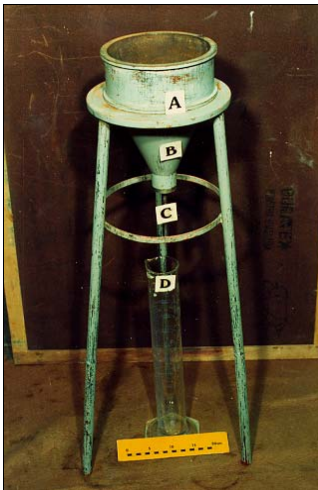
FIGURA 18 – Cone ou funil utilizado no ensaio para determinação do tempo de escoamento: (A) suporte do cone; (B) cone de Marsh; (C) abertura para saída da calda; (D) proveta com capacidade de um litro.
