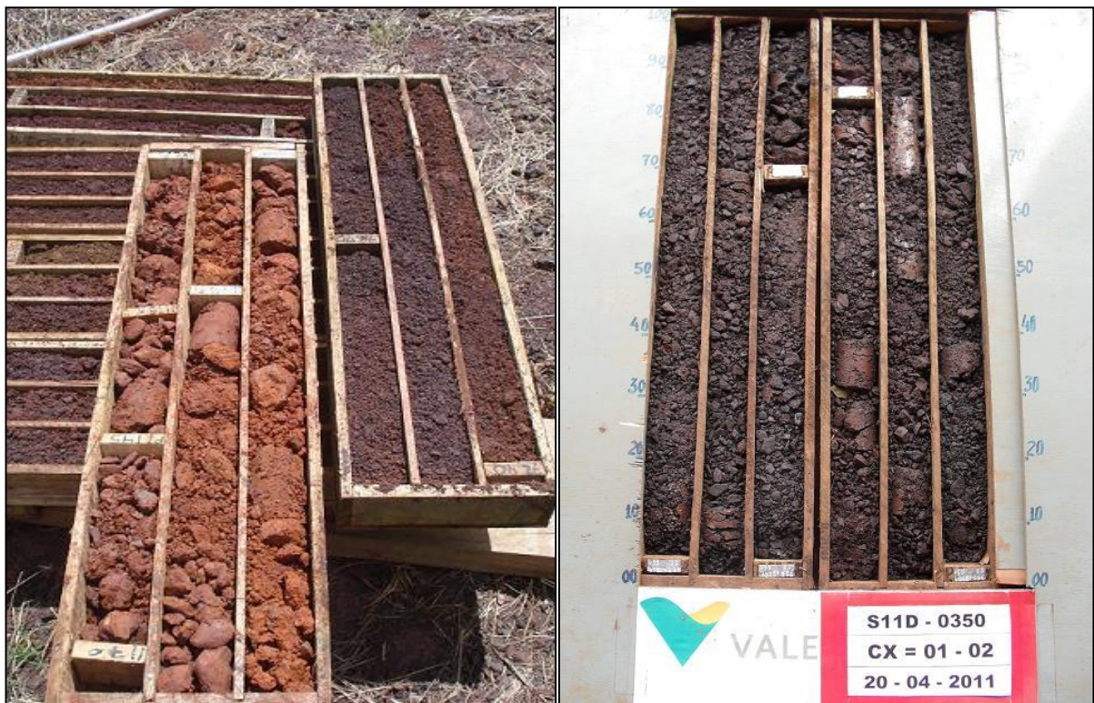
Figura 2.4 – Caixa com testemunho da sondagem rotativa testemunhada
