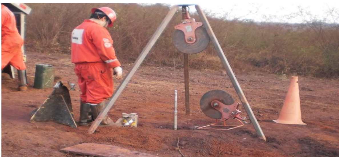
Figura 2.14 – Equipamento e componente para Perfilagem Geofísica de Poço.
