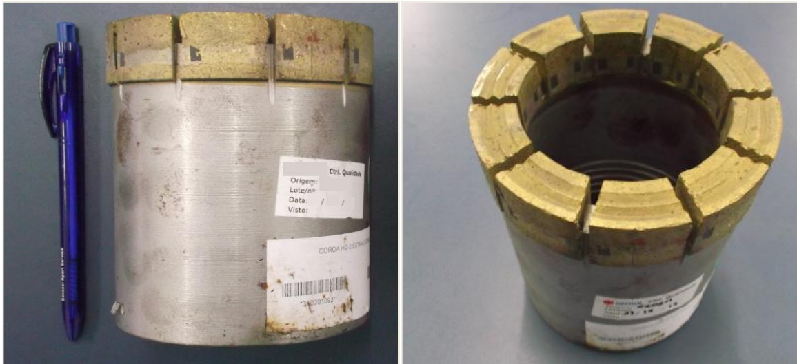
Figura 2.6 - Coroa de diamantes. (Coroa HQ-2 extra lateral S-2, Geosol)
