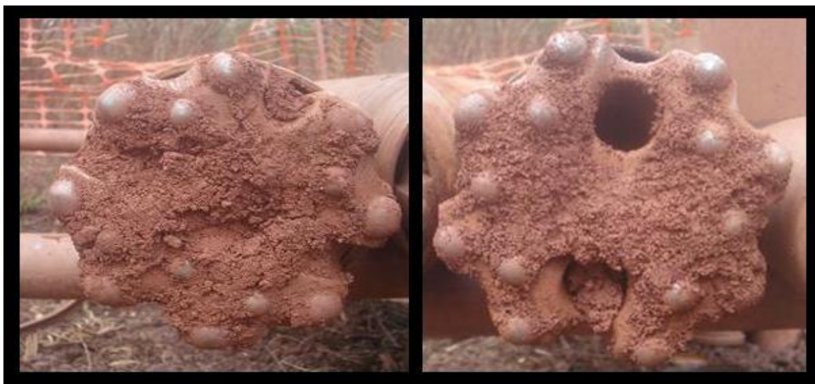
Figura 5.4 – Após penetração, vista da broca da sondagem rotopercussiva
