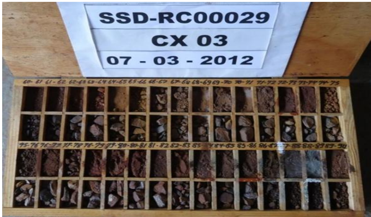
Figura 2.10 – Caixa com Ships da sondagem Rotopercussiva
