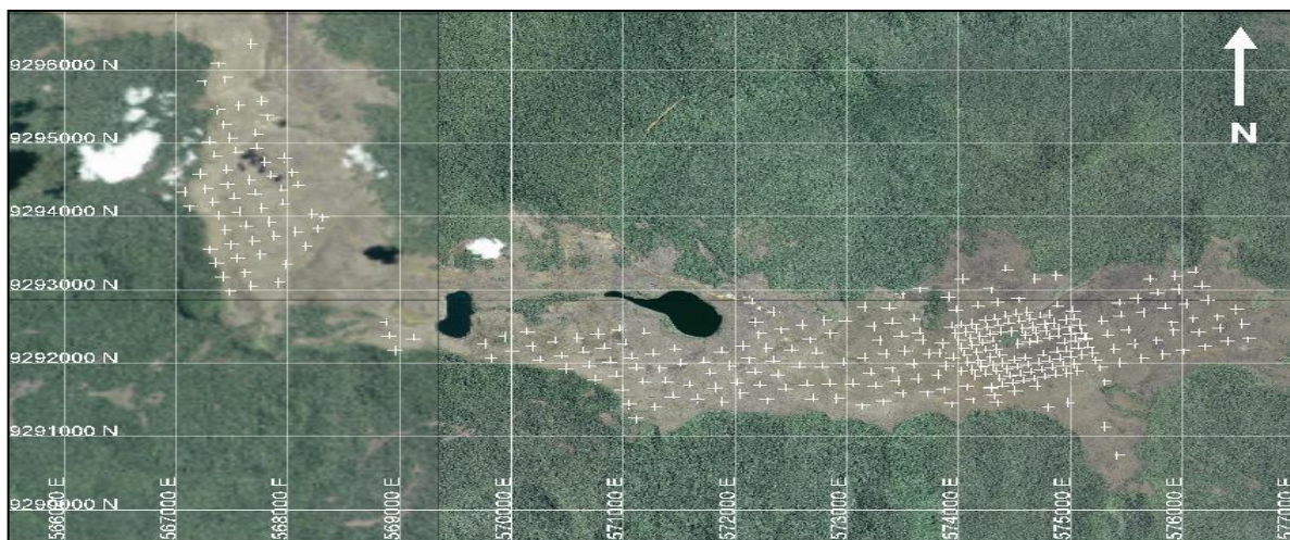
Figura 3.16 – malha de sondagem nos Corpos C e D do Alvo S11.
