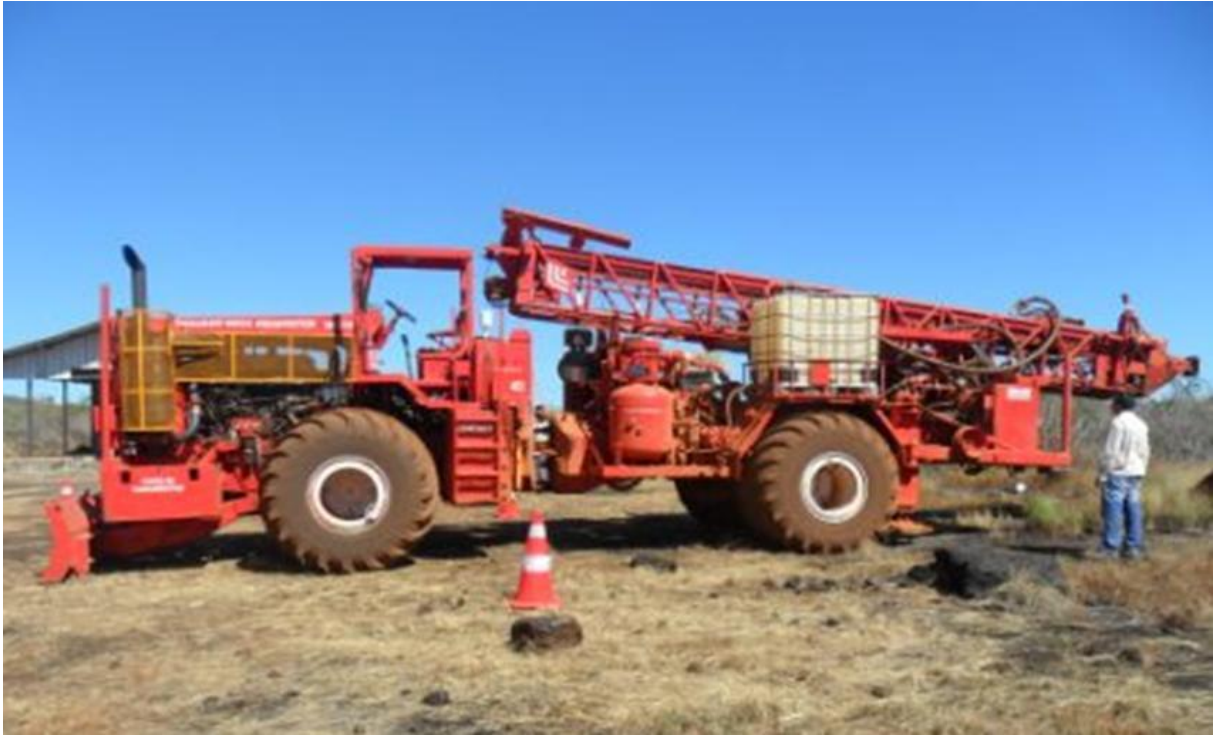
Figura 2.9 – Vista de um equipamento e praça para sondagem RC
