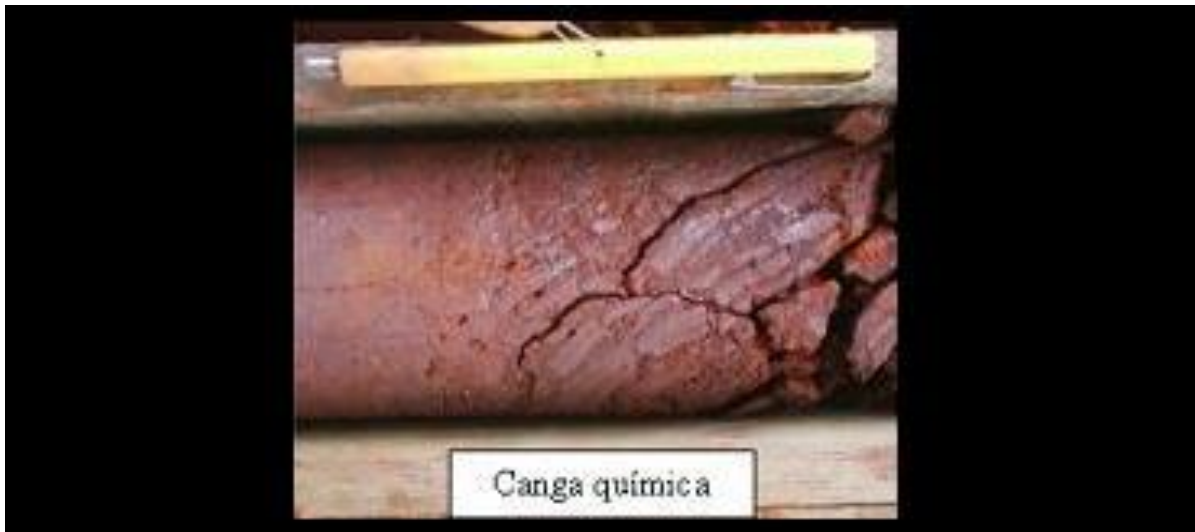
Figura 3.14 – Amostra de testemunho de sondagem de Canga Química
