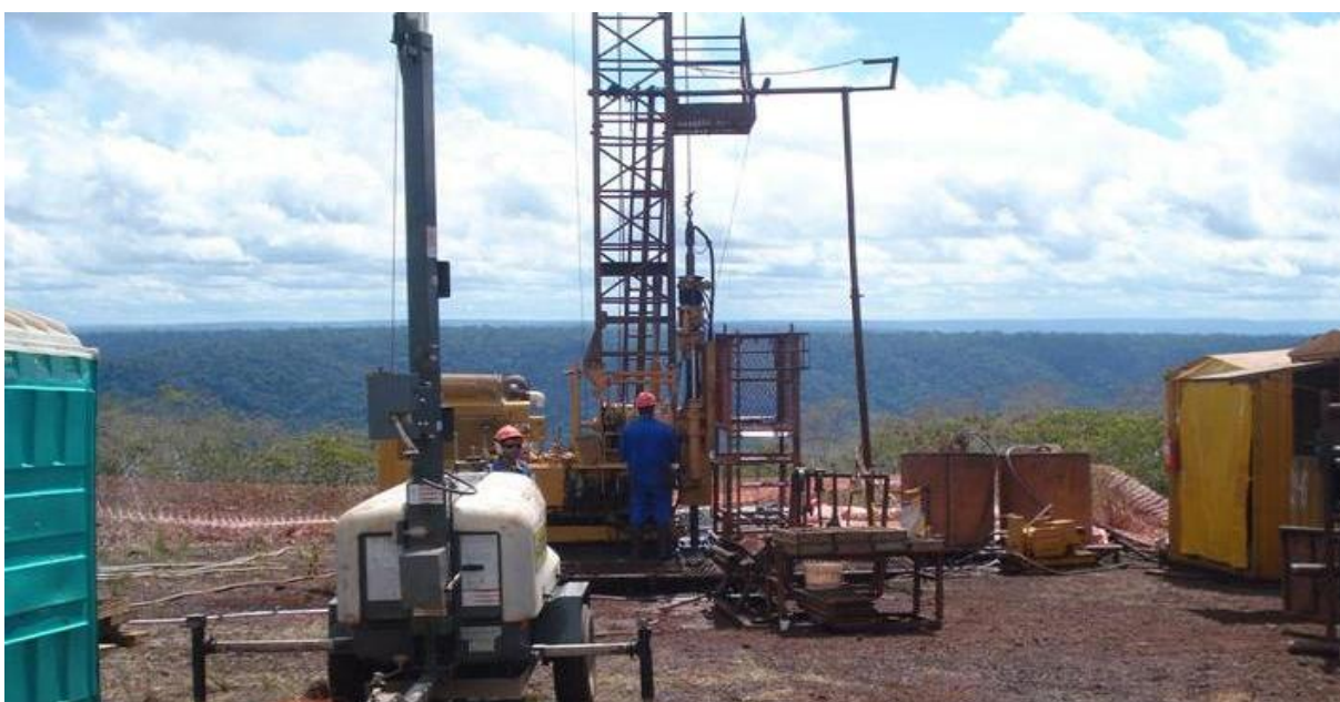
Figura 2.1 – Vista de uma praça de sondagem rotativa testemunhada
