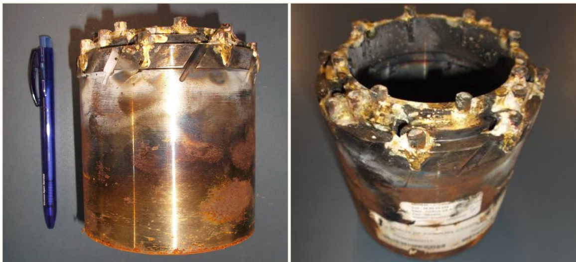
Figura 2.7 - Coroa de vídia. (Coroa de Pastilha com degrau HQ-2, Geosol)
