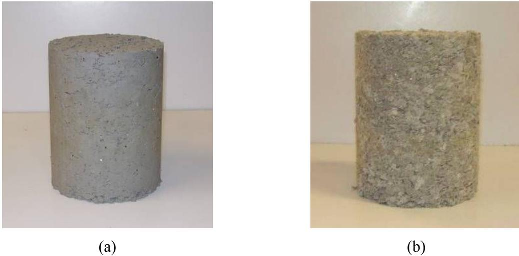
Figura 5.2: (a) Corpo de prova com umidade de aproximadamente 150 % (b) Corpo de prova com umidade de aproximadamente 125 %
