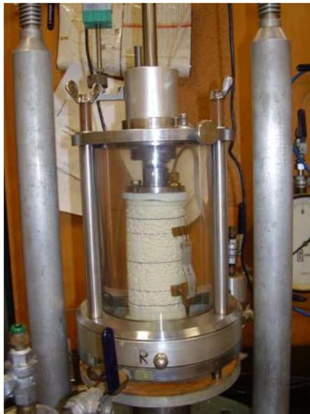
Figura 4.8: Câmara triaxial e corpo de prova
