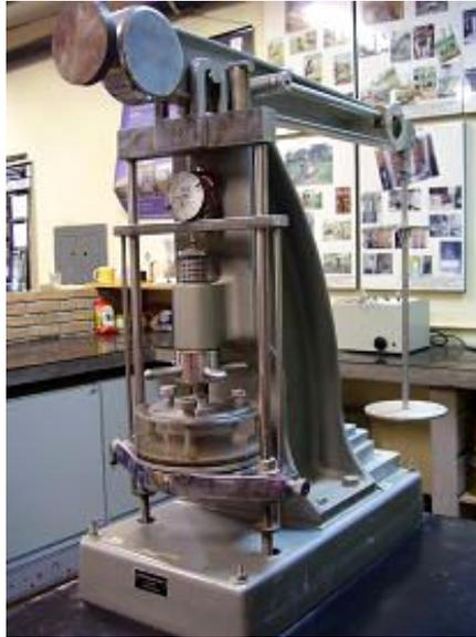
Figura 4.5: Prensa de adensamento
