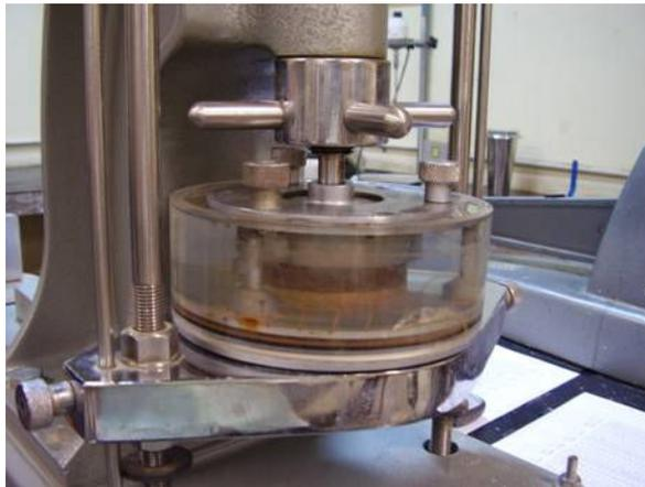
Figura 4.6: Detalhe da célula de adensamento
