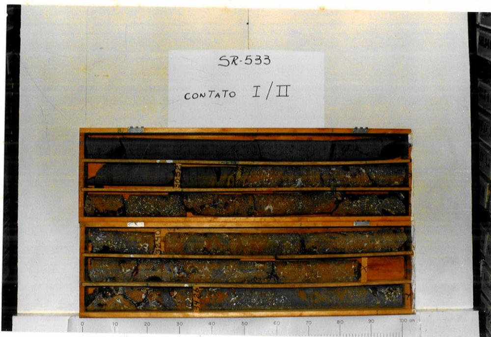
FOTO 1 - Aspecto do contato selado entre os derrames basálticos I e II. (SR-533; 30,70 m).
