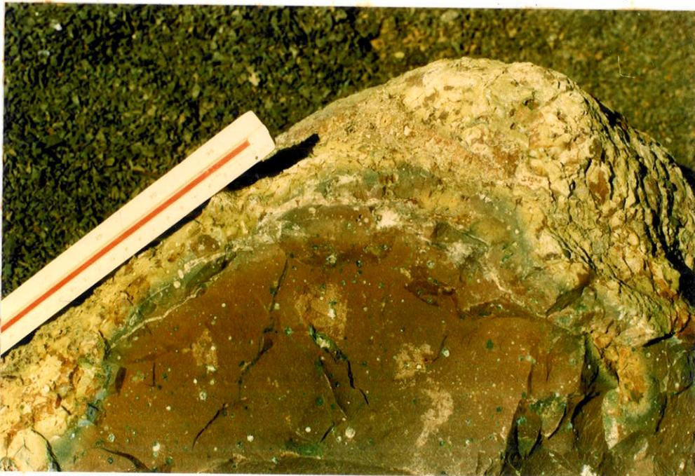
FOTO 12 - Bloco de "pillow lava" basáltica retirado da esca vação do Poço de Drenagem. Notar a "borda de reação" e a grande quantidade de vesículas e amígdalas próximas da bor da.
