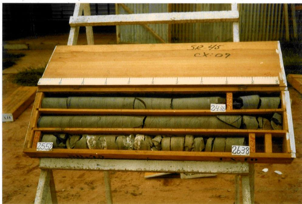
FOTO 4 - Aspecto da junta da cota nominal 300 m. Notar a calcita cimentando fragmentos de basalto compacto (SR-45; de 23,60 m a 26,38). Fonte: IPT, 1979 a.
