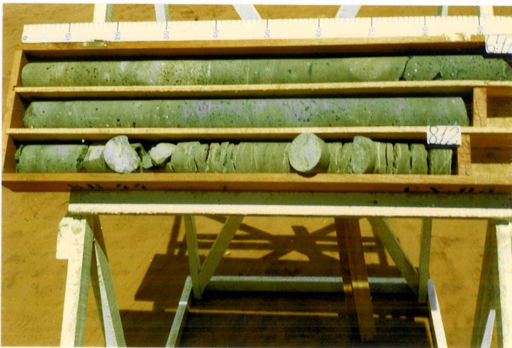
FOTO 6 - Aspecto da junta da cota nominal 310 m. Notar a alteração mais pronunciada na zona de desenvolvimento da junta e as películas de argila branca revestindo as superfícies das fraturas (SR-44; de 5,49 m a 8,12 m). Fonte: IPT 1979a.
