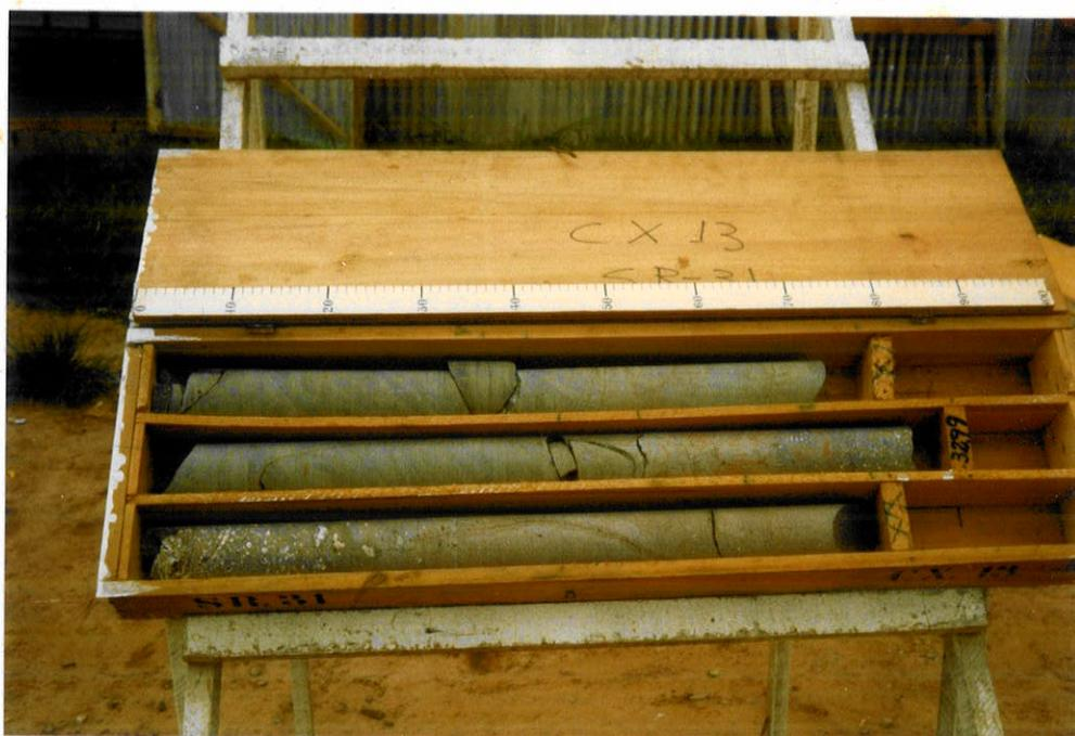
FOTO 2 - Aspecto do contato entre os derrames basálticos II e III. O horizonte vesicular é de 0,30 m. (SR-31; de 31,50 m a 33,73 m). Fonte: IPT, 1979a.
