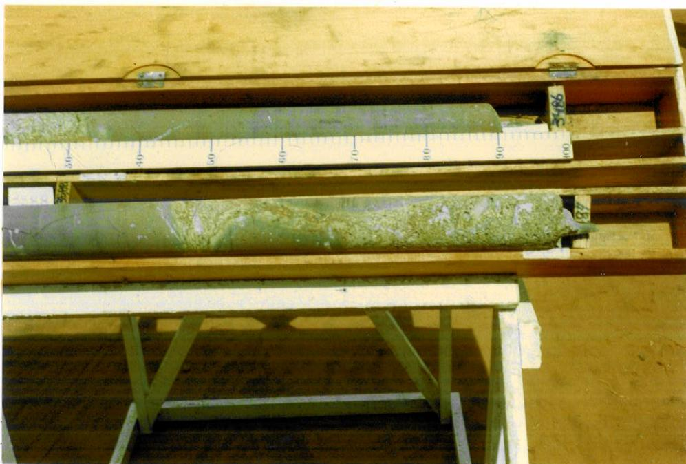
FOTO 7 - Brecha basáltica argilosa (hidrotermal). Notar a densidade das vesículas e das zonas avermelhadas, mesmo quando as intercalações brechóides ocorrem em posição vertical (SR-27; de 34,86 m a 35,84 m). Fonte: IPT, 1979a.
