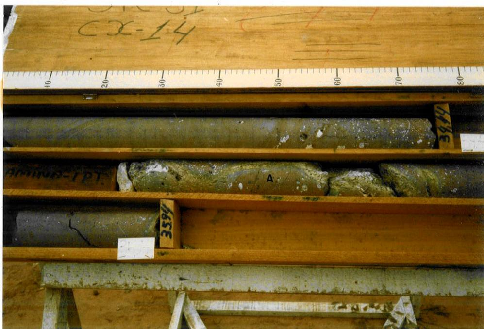
FOTO 8 - Brecha basáltica argilosa (hidrotermal) e brecha basáltica calcária. Notar em A, a graduação na intercalação brechóide, passando de medianamente alterada (cinza claro) para muito alterada (esverdeado), sugerindo uma origem comum para os materiais das intercalações (SR-31; de 33,70 m a 35,94 m). Fonte: IPT, 1979a.
