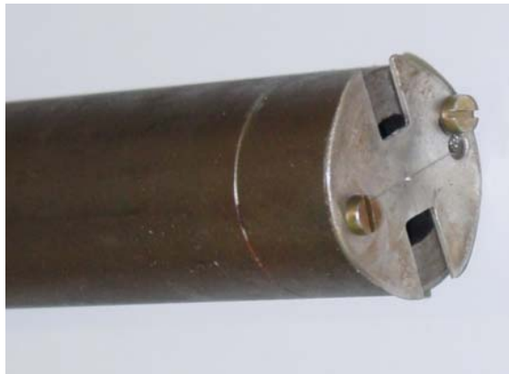
Figura 3.14 – Detalhe do acabamento da parte superior da haste
