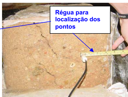
Figura 4.56 – Ensaio em andamento na face 03 do bloco (localização do ponto 3.1)
