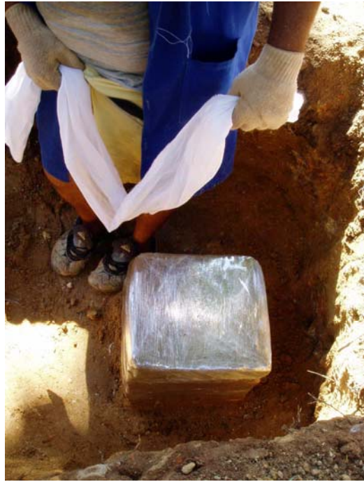
Figura 4.45 – Isolamento do bloco
