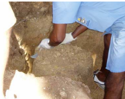
Figura 4.43 – Modelagem do bloco (2)
