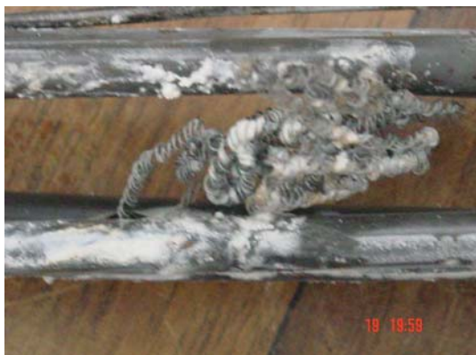
Figura 4.83 – Detalhe da resistência saindo do cartucho através de uma abertura
