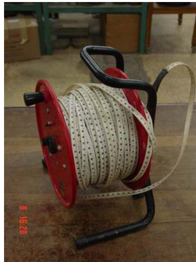
Figura 4.17 – Medidor de nível d'água elétrico portátil (2)
