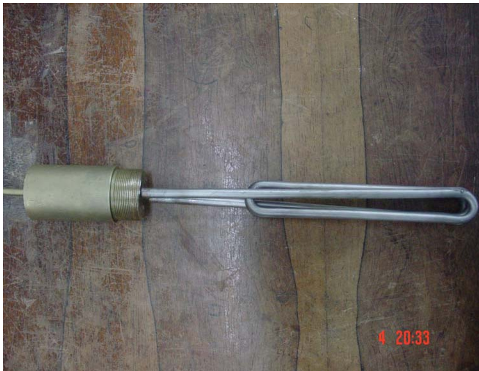
Figura 4.72 - Novo cartucho de resistência (vista superior)
