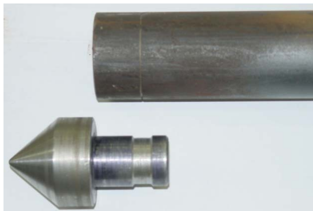
Figura 3.15 – Detalhe do acabamento da ponta da sonda
