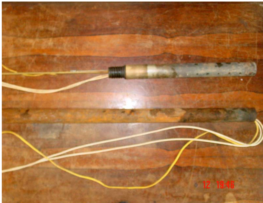
Figura 4.80 – Elementos estruturais do bastonete térmico
