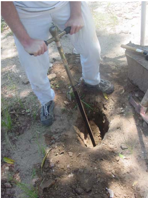
Figura 4.31 – Cravação de trado para coleta de amostras
