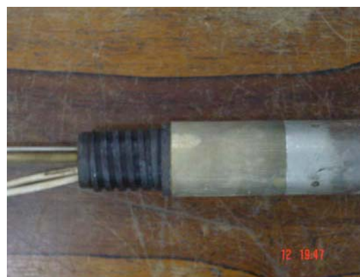
Figura 4.77 – Detalhe da conexão entre o cartucho e o tubo inferior do bastonete
