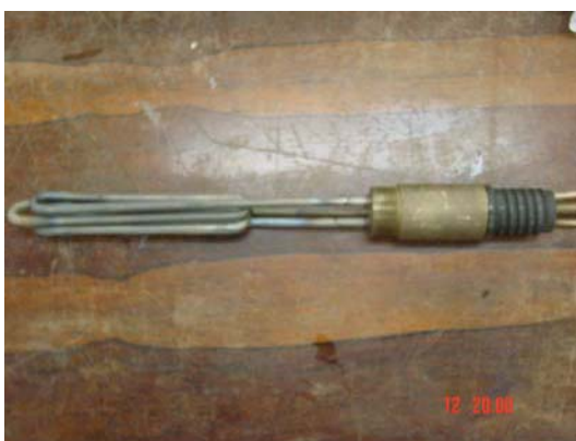
Figura 4.76 – Cartucho conectado ao elemento rosca
