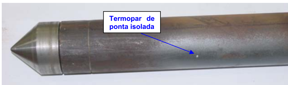
Figura 3.17 – Detalhe do posicionamento da ponta isolada do termopar inferior, soldada a 15cm do final da sonda
