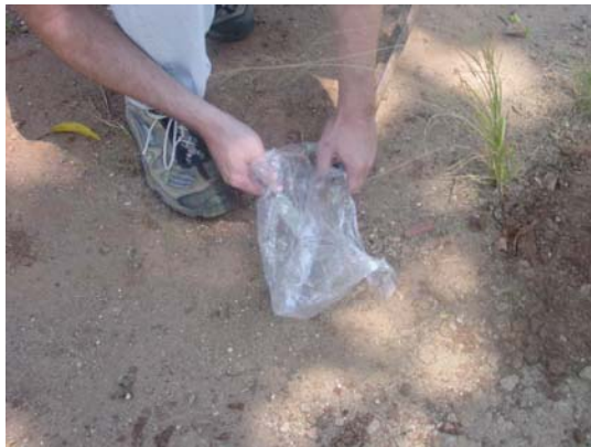
Figura 4.32 – Recolhimento de amostras para determinação de umidade
