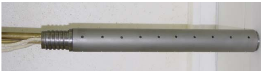
Figura 3.7 – Aquecedor do novo bastonete térmico montado
