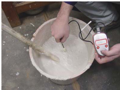
Figura 4.68 – Medição dos parâmetros térmicos da mistura caulim-água
