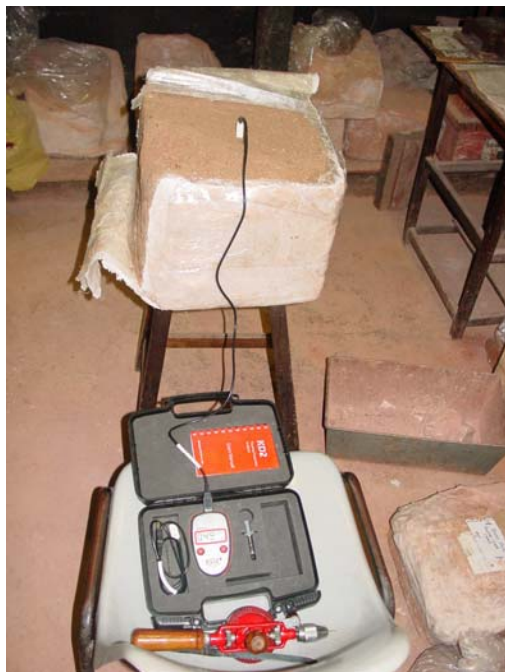
Figura 4.53 – Ensaio em andamento para determinação dos parâmetros térmicos na face 01 do bloco, ponto 1.1
