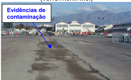
Figura 2.24 – Área antes do tratamento / evidências de contaminação (TerraTherm Inc.)
