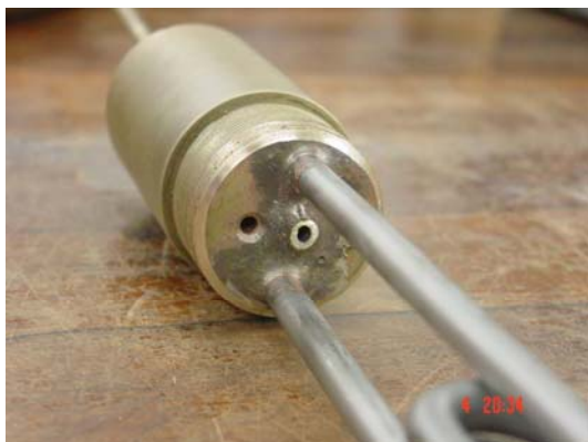
Figura 4.74 – Detalhe inferior da base do cartucho fabricada no LGMA , com 02 furos
