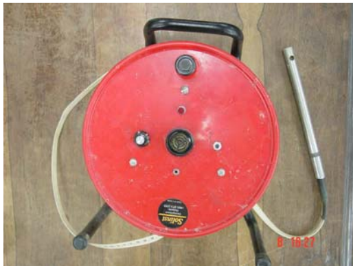
Figura 4.16 – Medidor de nível d'água elétrico portátil (1)
