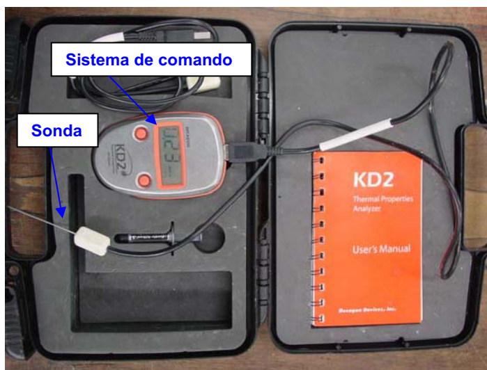
Figura 4.50 – Instrumento 'Thermal Properties Analysis', do tipo KD2
