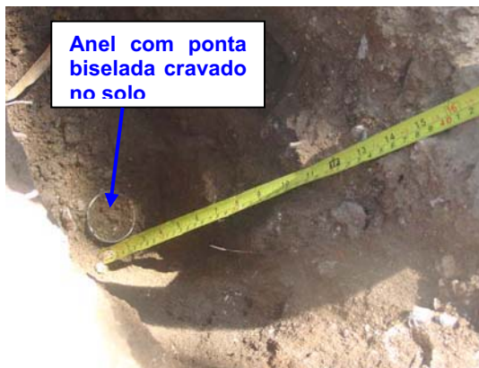
Figura 4.28 – Cravação de anel com ponta biselada para coleta de amostras de solo
