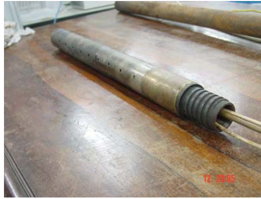
Figura 4.79 – Detalhe do novo aquecedor do bastonete térmico
