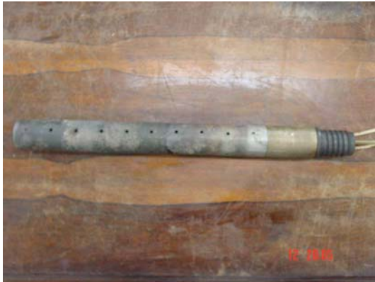
Figura 4.78 – Novo aquecedor do bastonete térmico
