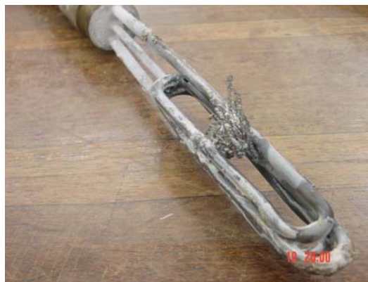
Figura 4.82 – Cartucho de resistência danificado (2)
