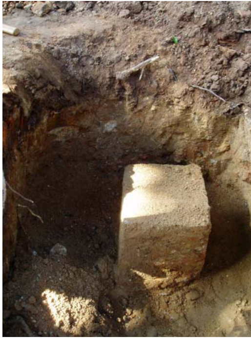
Figura 4.44 – Bloco de solo moldado
