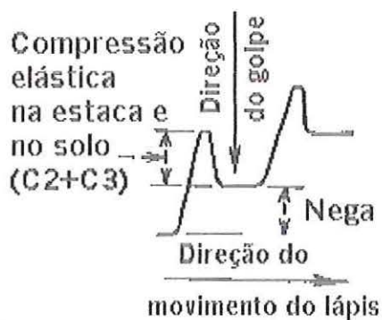
Figura 2.11 - Sinal do repique obtido com papel e lápis, AOKI (1986).
