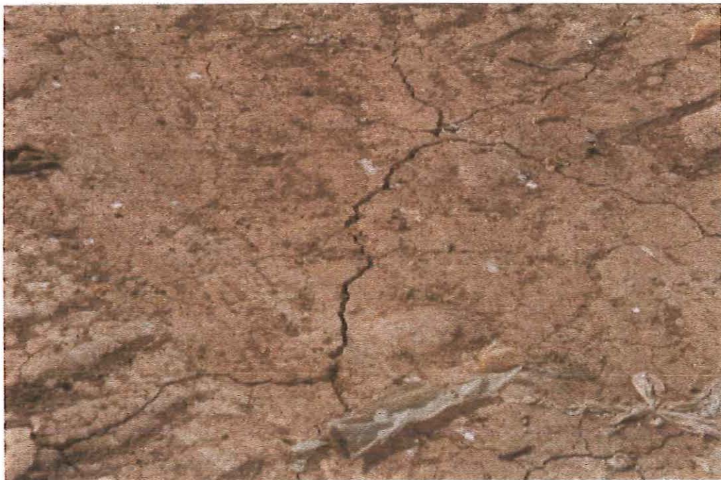
FIGURA 37 - Detalhe da Camada de Argila Compactada - Presença de Trincas
