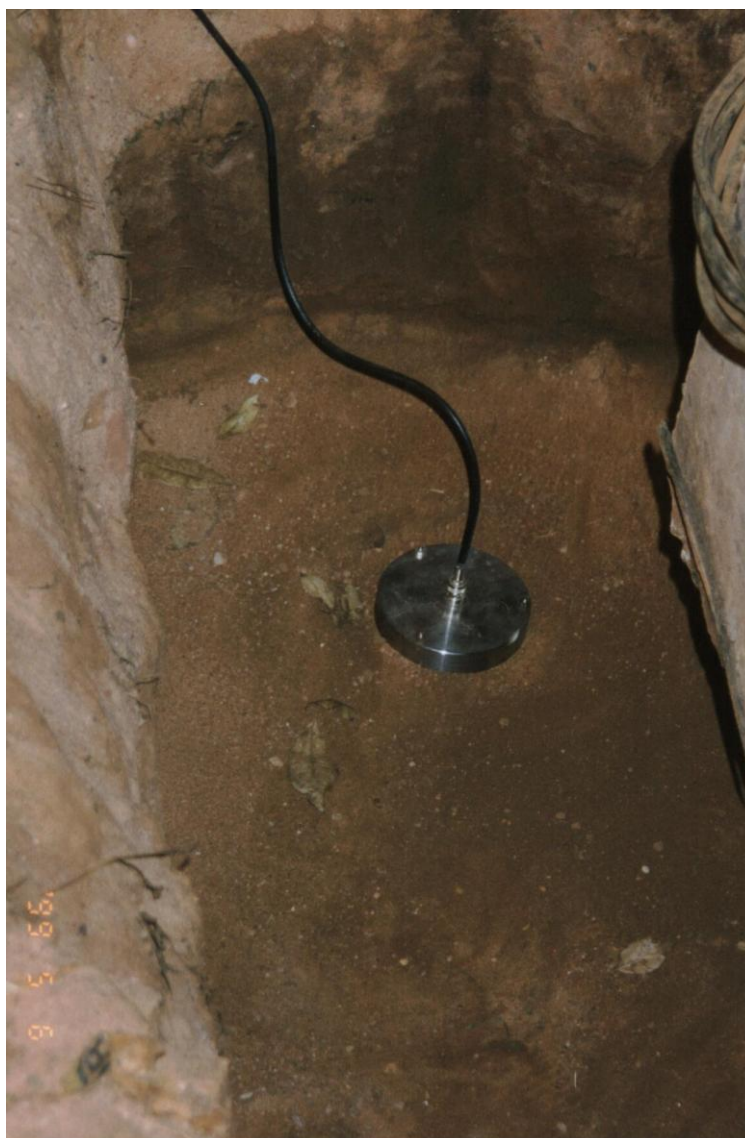
Foto 13. Sonda de TDR para terminação da umidade no solo.
