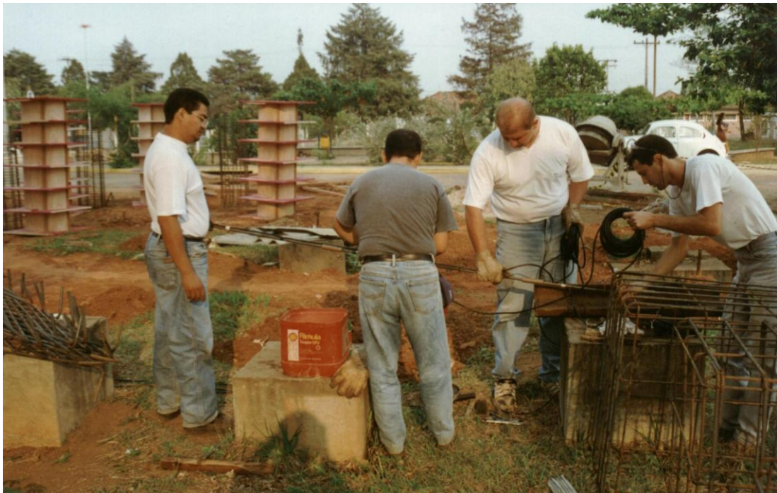
Foto 12. Processo de confecção das linha de strain-gage através de solda dos segmentos e espaçadores.
