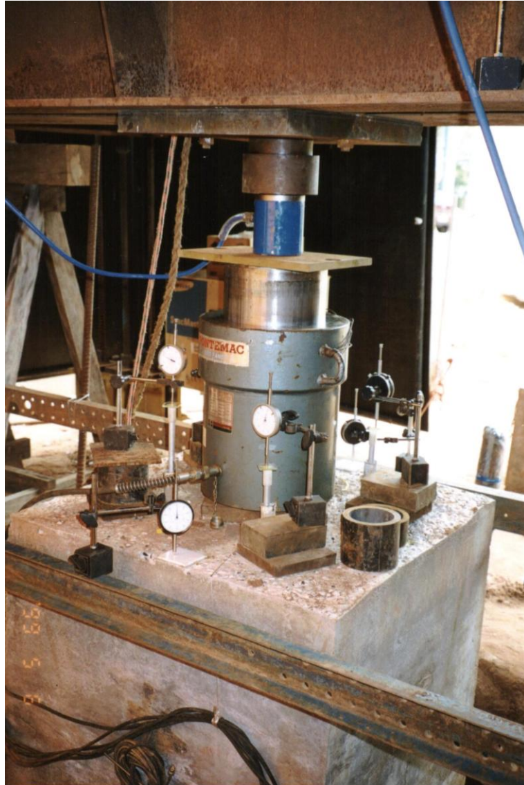
Foto 9. Equipamentos de prova de carga em operação: viga de referência (laterais do bloco), relógios comparadores para acompanhar a evolução dos recalques, relógios comparadores sobre as hastes de tell-tales , cilindro hidráulico (“macaco”), célula de carga (sobre a placa amarela), rótula maciça (sobre a célula de carga) e placa de distribuição de carga.
