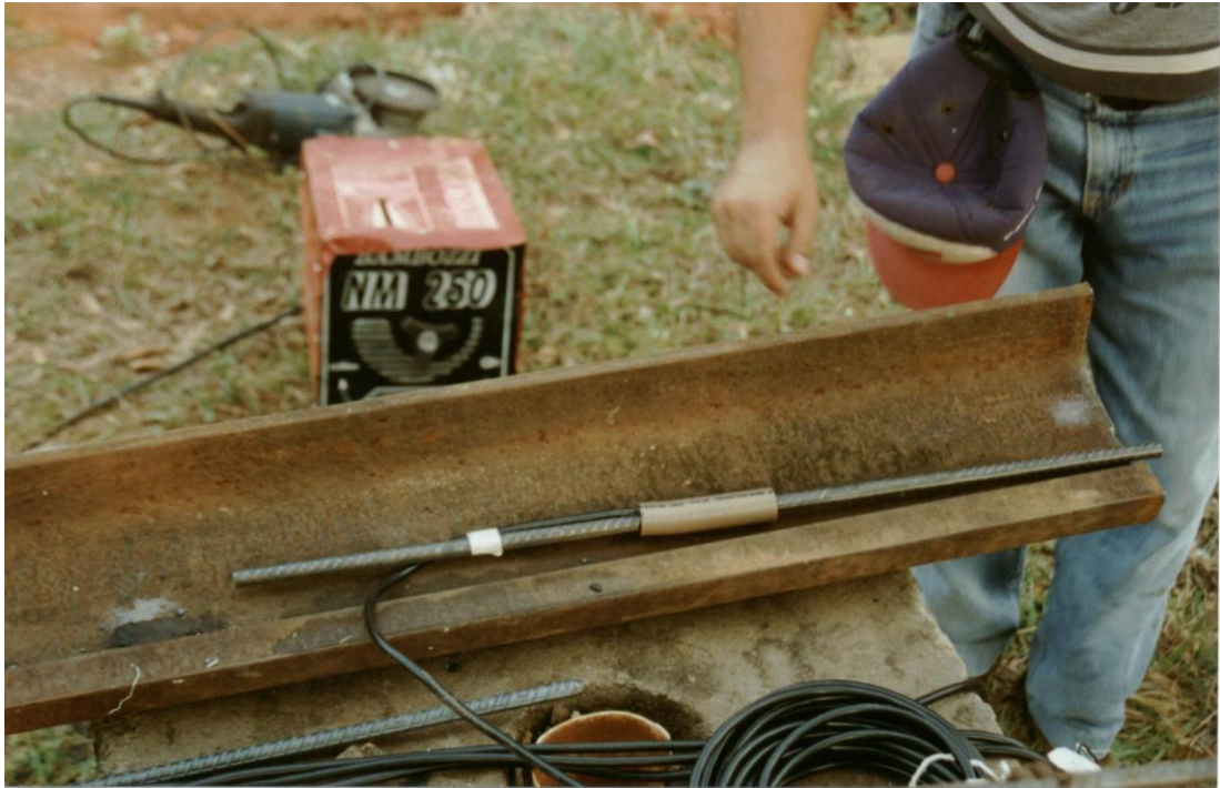
Foto 11. Detalhe da barra de strain-gage .
