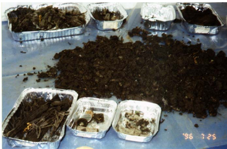
Figura 3.6 – Separação manual dos componentes do resíduo sólido urbano.
