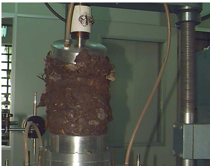
Figura 3c – Detalhe do corpo de prova no final do ensaio, aproximadamente 27% de deformação axial.
