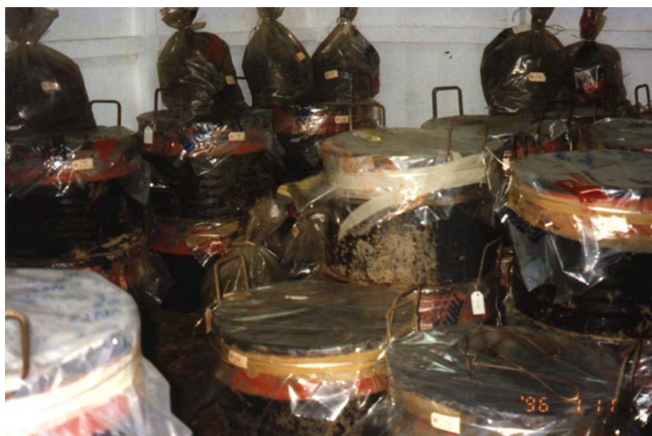
Figura 3.4 – Armazenamento das amostras de resíduo sólido urbano coletado em tambores metálicos devidamente lacrados.
