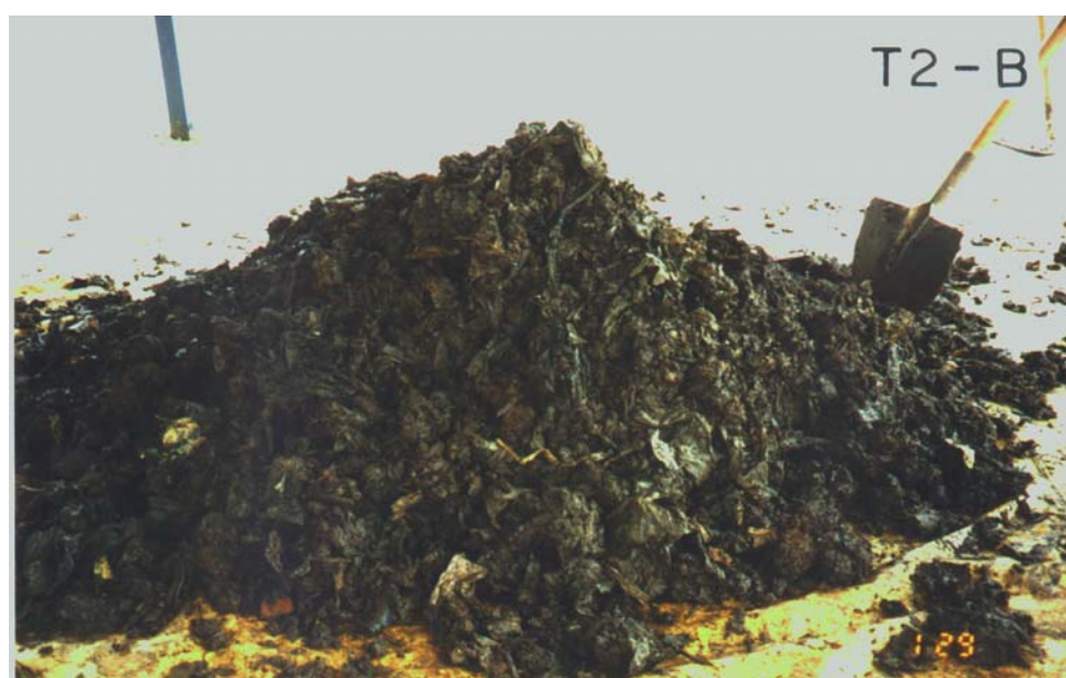
Figura 3.7 – Detalhes das amostras da tradagem T2, representativas do horizonte A (T2A) e do horizonte B (T2B).
