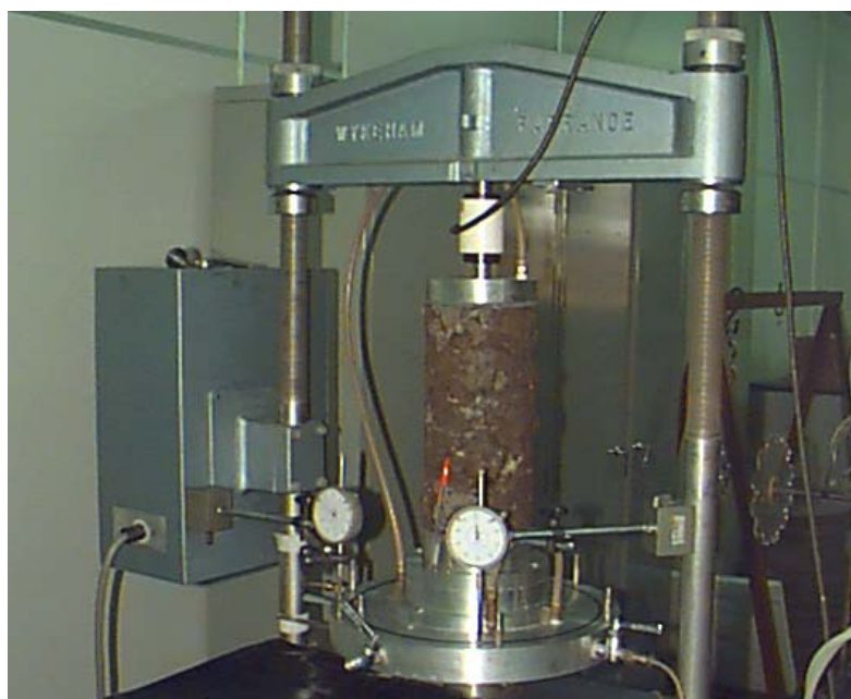
Figura 3a – Vista do corpo de prova da amostra T1B, com peso específico de 12\text{kN/m}^3 e umidade de 60,3%, antes do início do ensaio de compressão sem confinamento.
