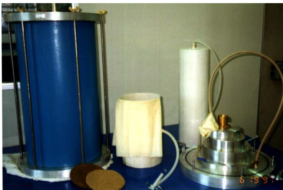
Figura 3.9 - Câmara triaxial desenvolvida para a realização de ensaios triaxiais em grandes amostras (150 e 200mm de diâmetro), pedras porosas, colocador de membrana.
