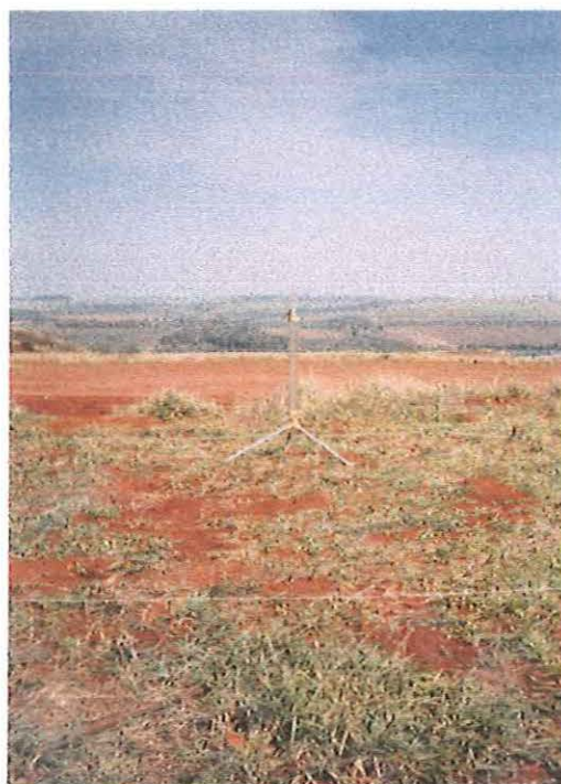
Figura 3.6. Ensaio Realizado a Superfície com o Permeômetro Guelph no Local B (Jardim Medeiros).
