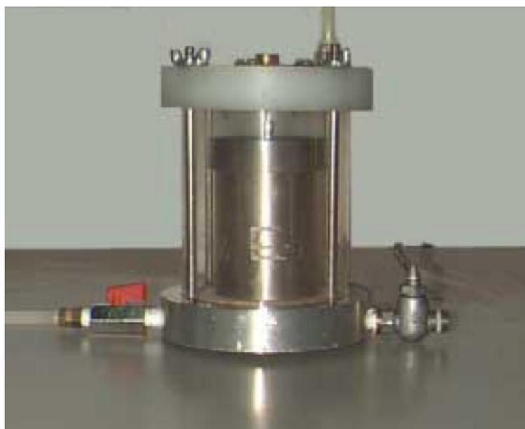
FIGURA 4.11– Corpo de prova dentro da Câmara de Richards confeccionada no Departamento de Geotecnia da USP/São Carlos
