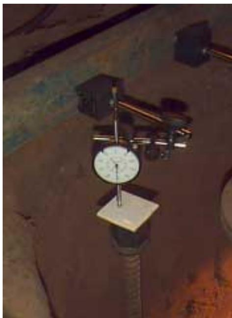
FIGURA 4.2 - Detalhe da instalação de um extensômetro
