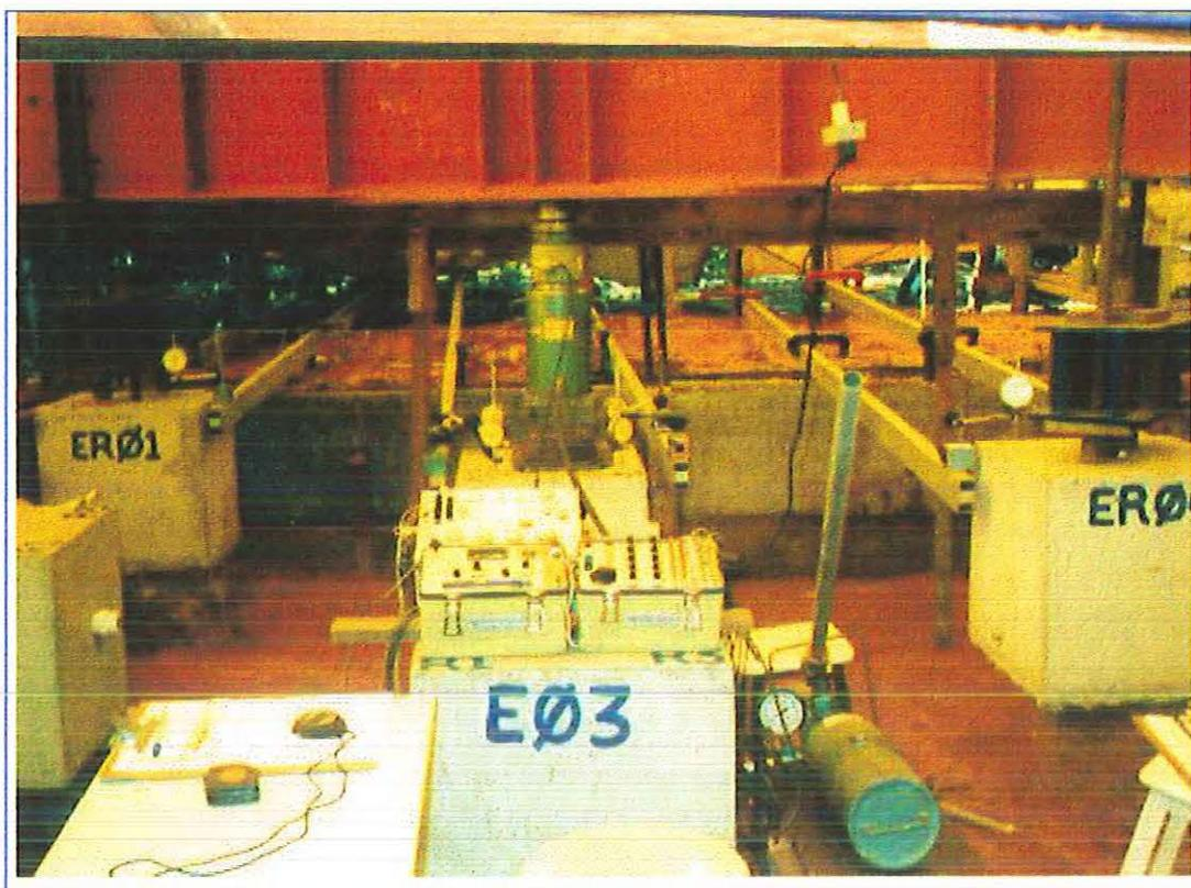
**FOTO 4.07:** Vista do esquema de montagem de uma prova de carga.
