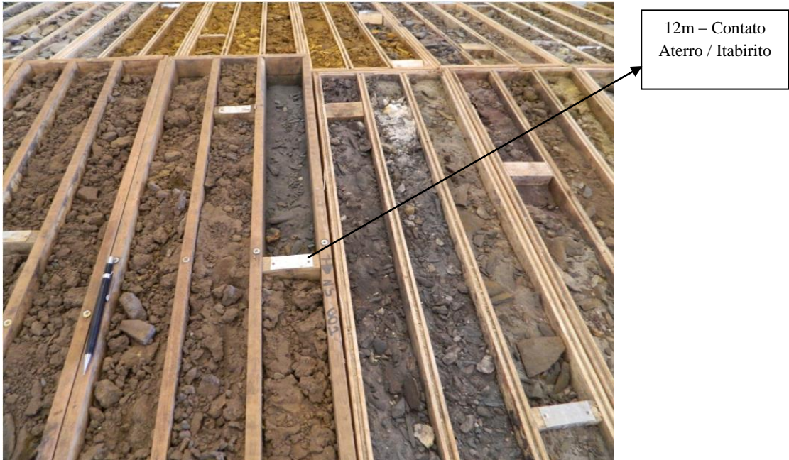
Figura 42. Testemunhos do furo FD-29 mostrando o contato entre o aterro (material amarronzado e mais argiloso na parte esquerda da foto) e itabirito (mais arenoso e de cor acinzentada, do centro para a direita da foto).
