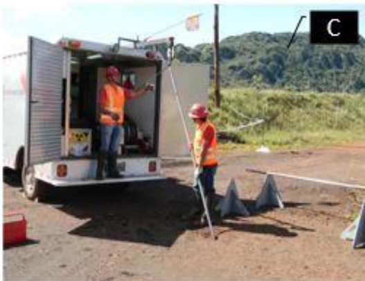
Descida do conjunto de ferramentas de perfilagem
