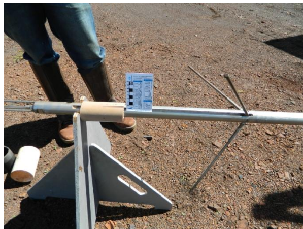
Figura 20. Sonda Cáliper de três braços para medição do diâmetro do furo.
