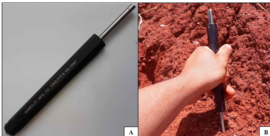
Figura 4.11 – Penetrômetro de bolso utilizado. A) Detalhes do equipamento; B) aplicação da metodologia no campo.
