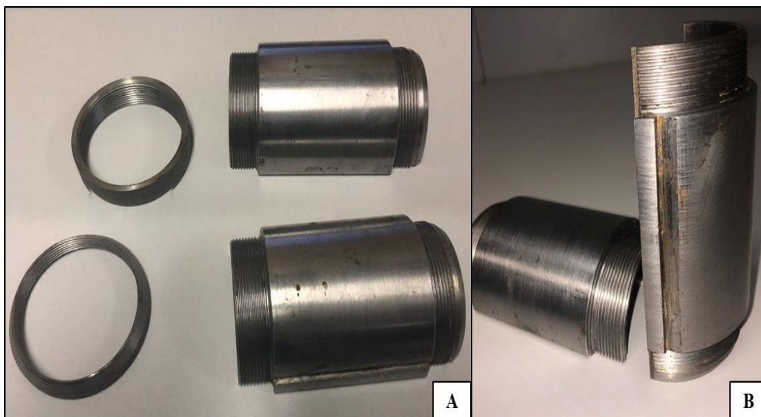
Figura 6.4 – Amostrador utilizado: A) Detalhe das partes componentes; B) Detalhe do crivo utilizado para fixação na parte inferior da rampa.
