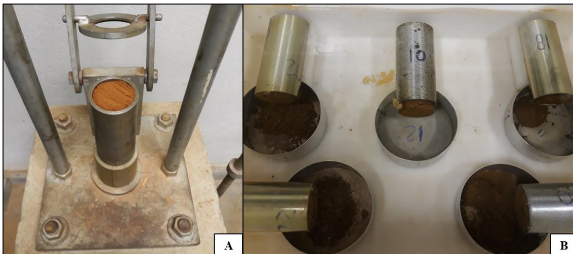
Figura 4.6 – Ensaio da metodologia MCT: A) ensaio de compactação mini-MCV; B) ensaio de perda de massa por imersão.
