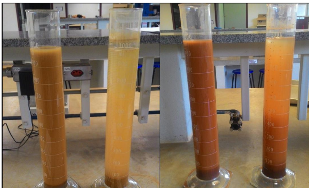
Figura 4.3 – Análise granulométrica realizada com e sem o uso de defloculante químico.
