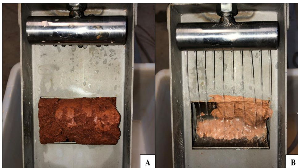
Figura 6.15 – Resultado das amostras no final do ensaio. A) ITAHS – horizonte resistente a erosão; B) ITAHI – horizonte erodível.
