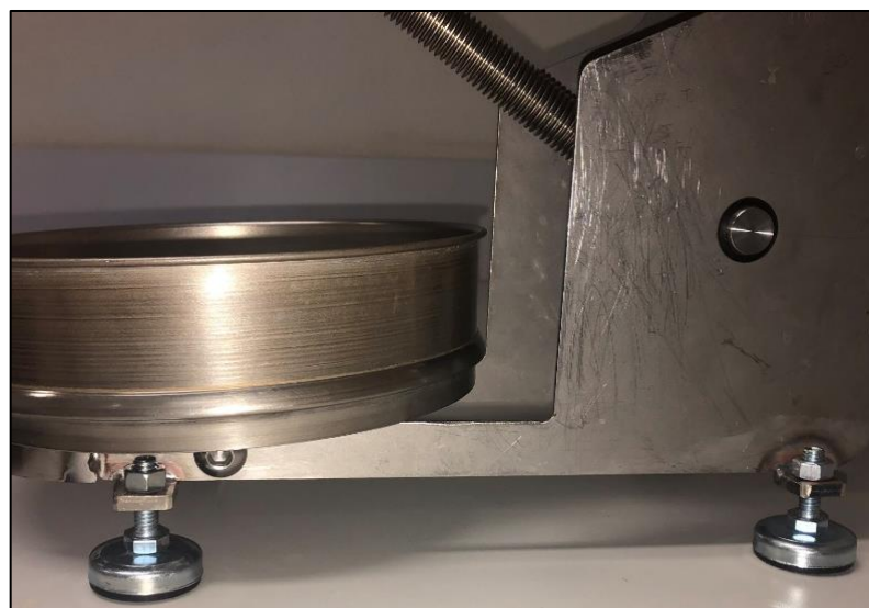
Figura 6.10 – Dispositivo para nivelamento.
