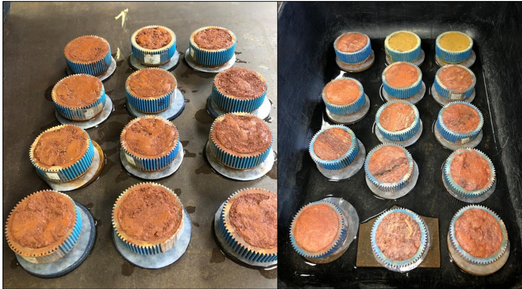
Figura 4.5 – Preparação das amostras para determinação da curva de retenção.
