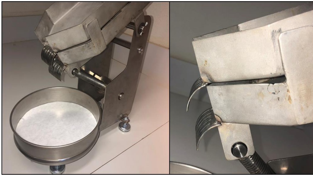
Figura 6.9 – Extravasor para direcionamento do fluxo de água e sedimentos para a peneira de coleta.
