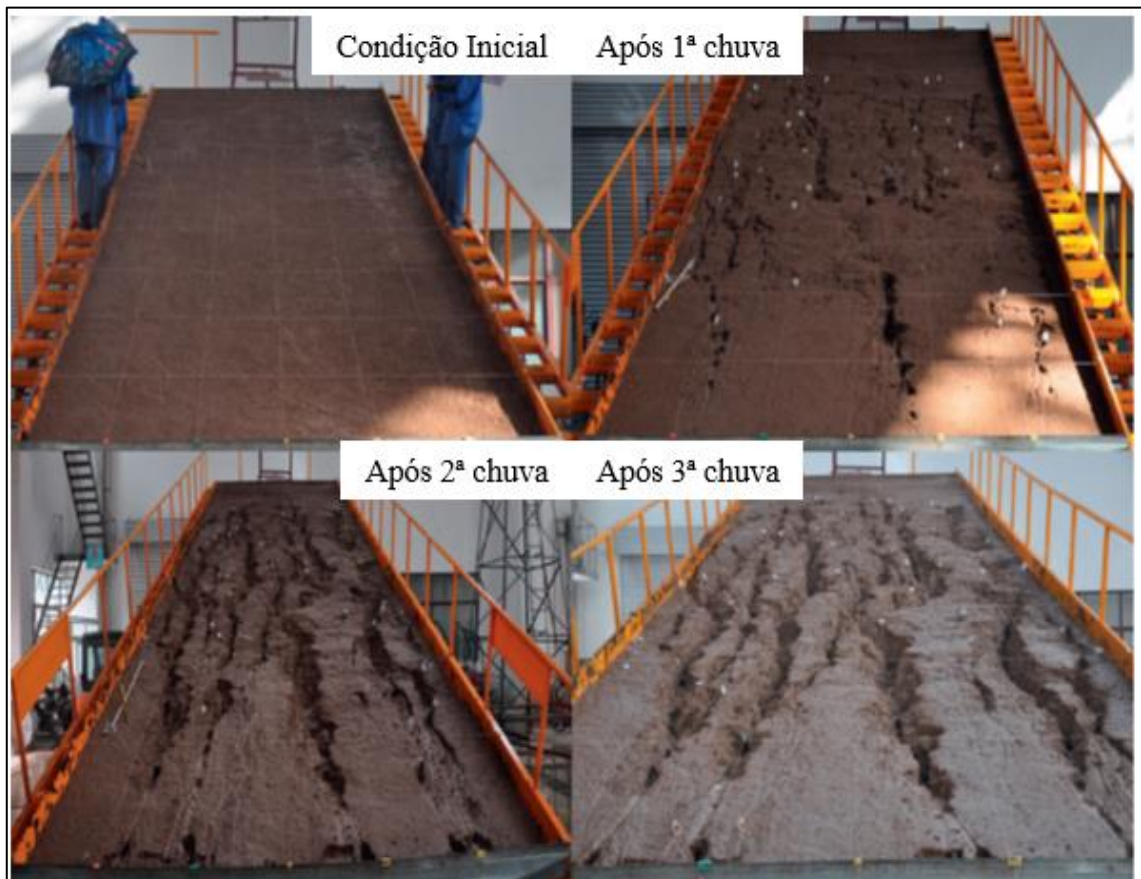
Figura 2.6 – Parcela experimental desenvolvida em laboratório para avaliação do efeito da intensidade da precipitação no desenvolvimento da erosão em sulcos (Fonte: adaptado de Shen et al. , 2015).
