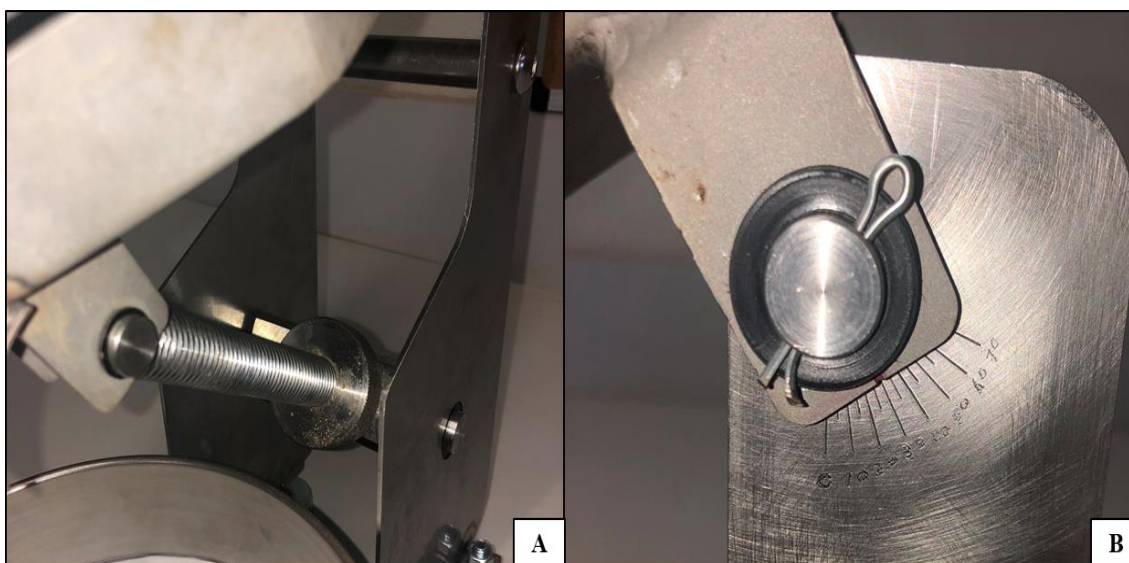
Figura 6.8 – Ajuste de inclinação. A) parafuso de rosca sem fim. B) escala para aferição do ângulo de inclinação.
