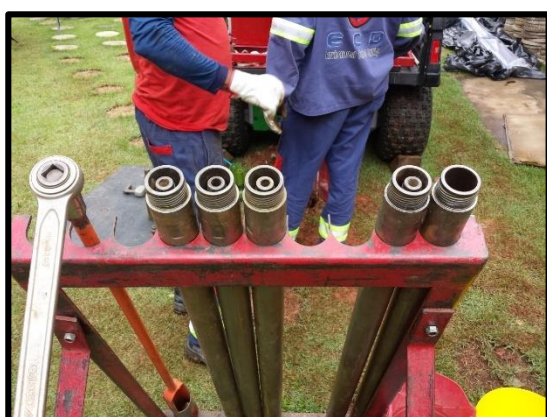
c) Vista geral das hastes prolongadoras externas e internas
