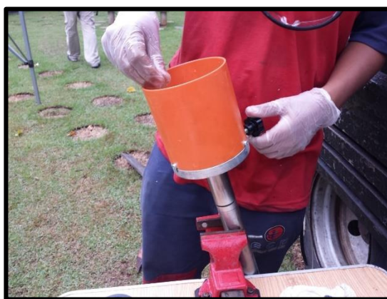
d) Retirada do funil com glicerina após colocação da pedra porosa
