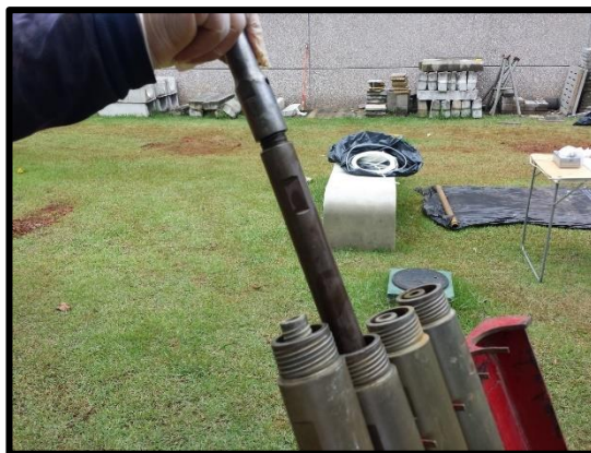
b) Detalhe para hastes prolongadoras externas (revestimento) e internas (que conectam ao liner )
