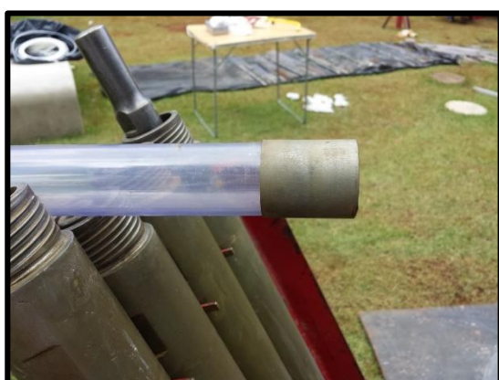
e) Liner com retentor de amostras e hastes prolongadoras externas e internas
