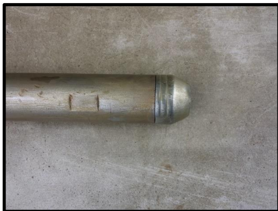
a) Amostrador de aço com macrocore
