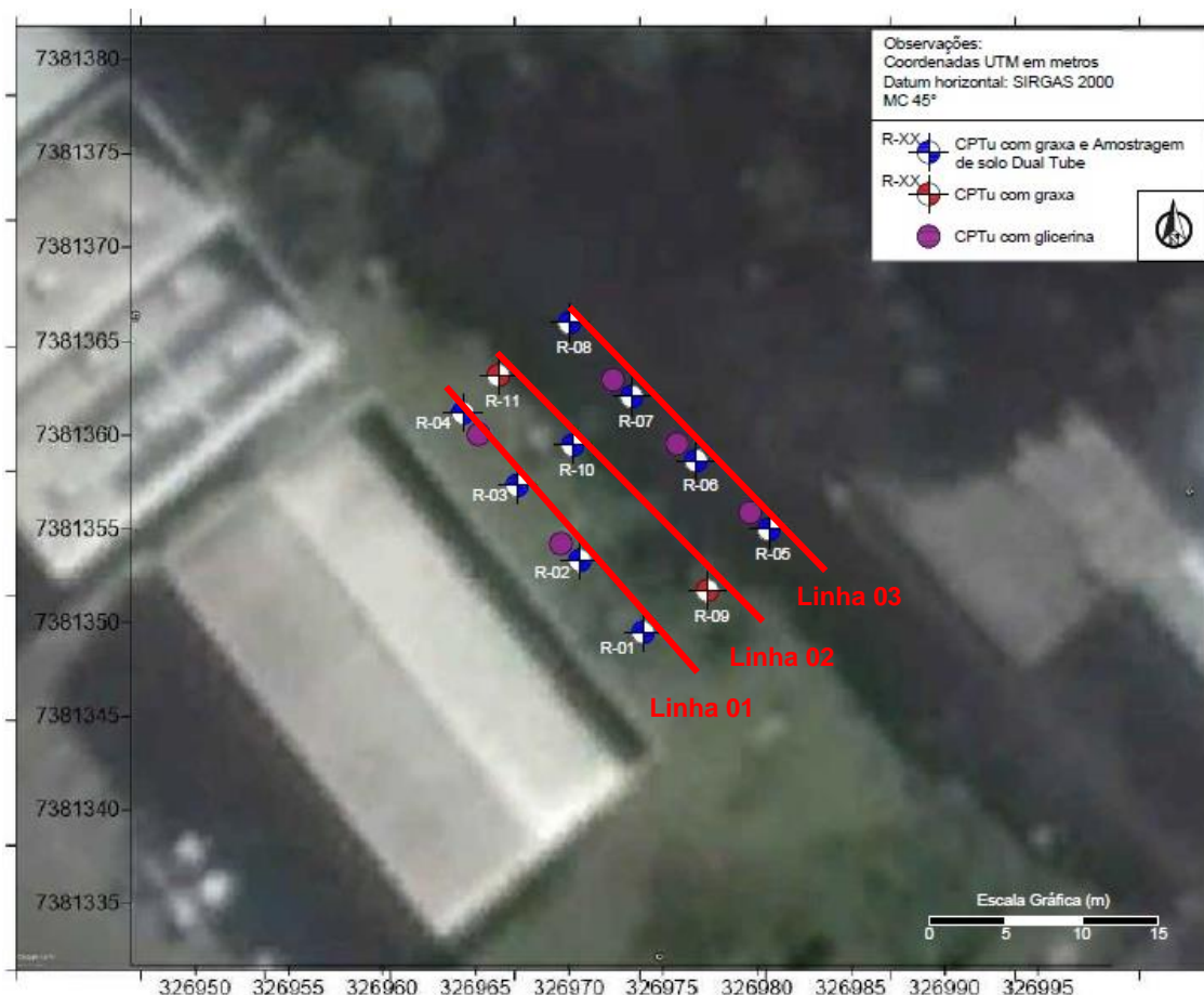
Figura 27 – Localização das três linhas principais dos ensaios
