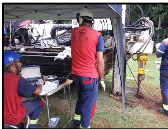
f) Operação e execução do ensaio CPTu
