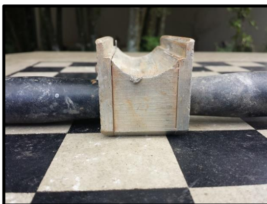
c) Detalhe para cortador de liner
