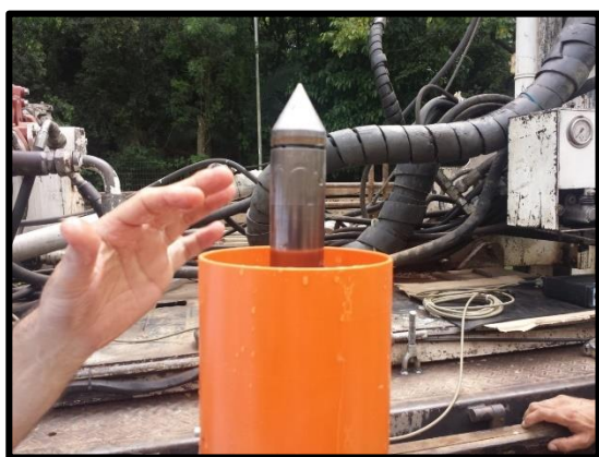
c) Pedra porosa colocada na posição u_2
