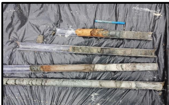
e) Liner cortado para descrição tátil-visual e seleção de amostras
