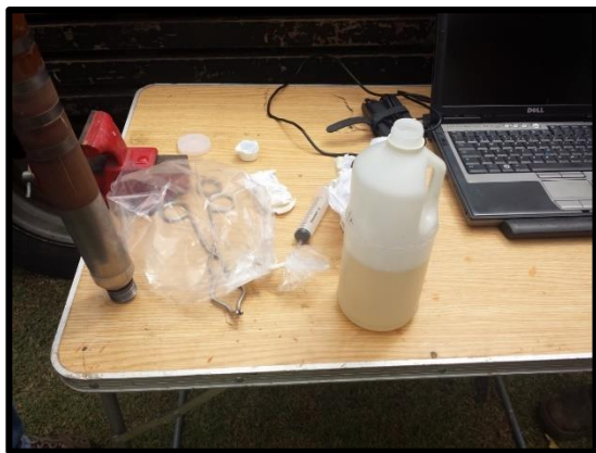
a) Glicerina deaerada e cone sendo preparado para a colocação do piezoelemento
