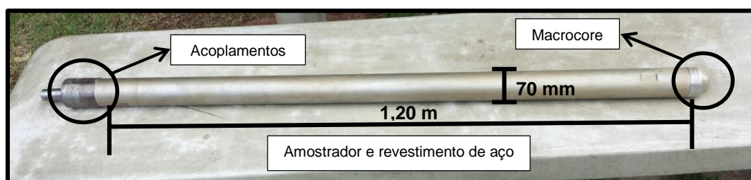
d) Amostrador de aço completo, com macrocore , acoplamentos, liner e retentor de amostra
