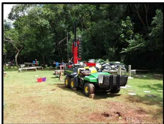
a) Sonda Perfuratriz Hidráulica Mecanizada marca AMS, modelo Power Probe 9100-ATV, de propriedade da ECD
