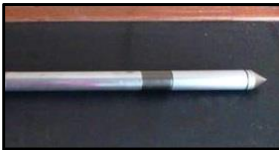
a) Piezocone montado com filtro de cavidade ( slot filter )
