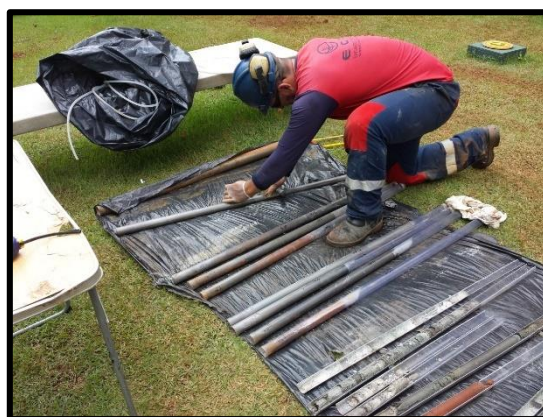
d) Liner sendo cortado para descrição tátil-visual e seleção de amostras
