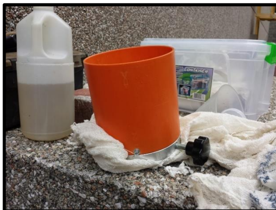
f) Funil e recipiente com glicerina após colocação da pedra porosa
