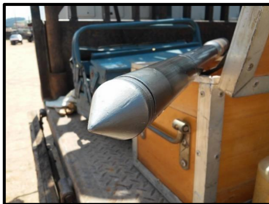
c) Detalhe para ponteira do Piezocone com filtro de cavidade
