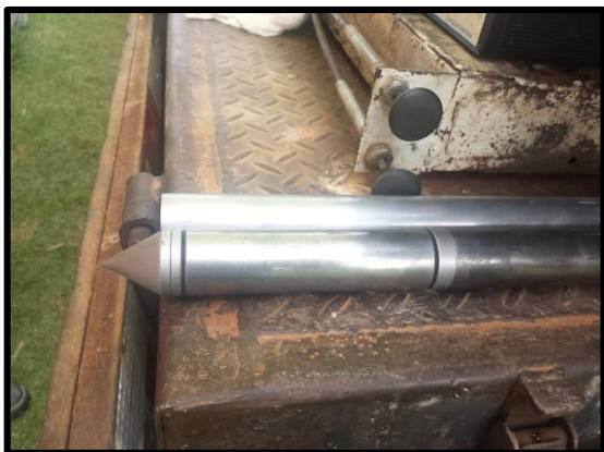
b) Detalhe para Piezocone montado
