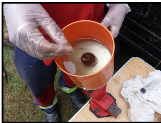
b) Colocação da pedra porosa saturada em glicerina
