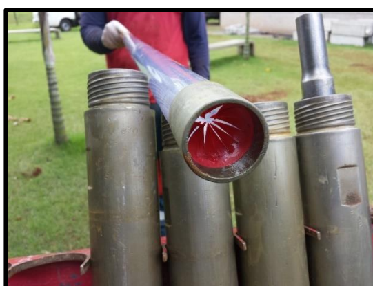
f) Detalhe para o retentor de amostras e hastes prolongadoras externas e internas
