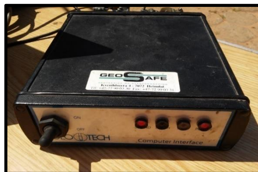
d) Interface entre o recebimento de sinal do microfone e o notebook
