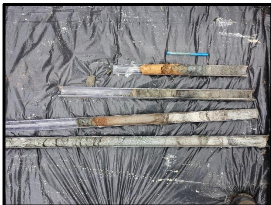
c) Visualização do perfil estratigráfico das amostras no liner do ponto R-01
