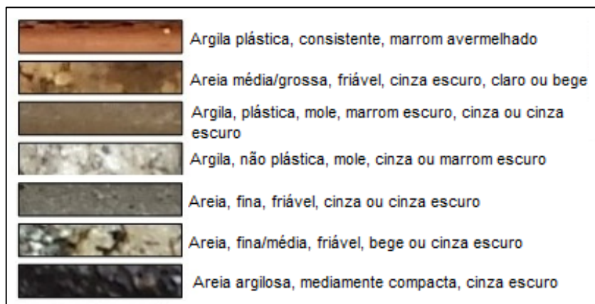
Figura 48 – Tipos de solo segundo a descrição tátil-visual
