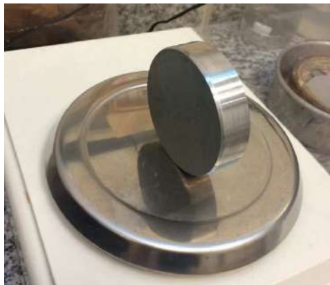
Figura 4-15 Corpo de prova moldado, em processo de pesagem.
