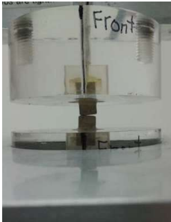
Figura 4-9 Elementos transmissor e receptor em contato, ponta a ponta (modificado de JANNUZZI, 2013).
