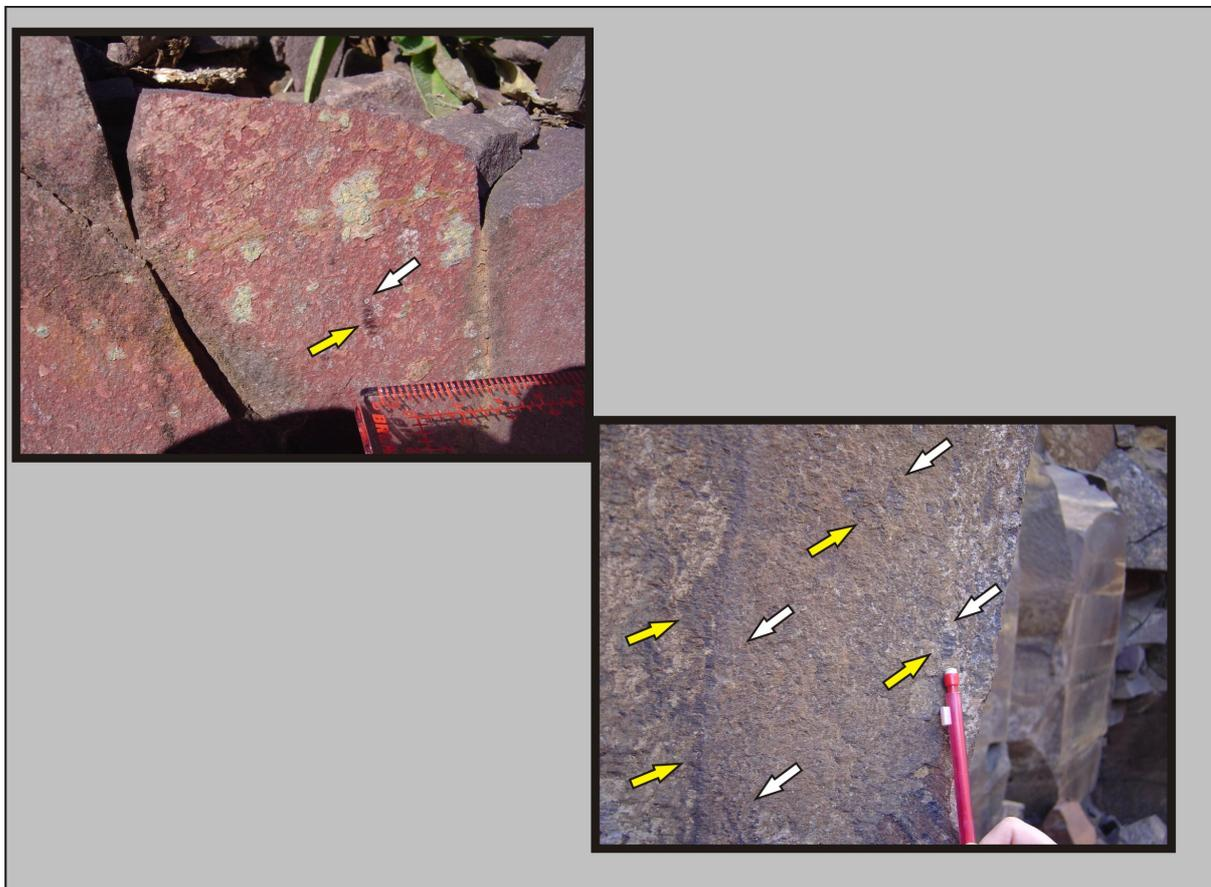
**Figura 4.4** – Fotos mostrando as estrias (setas amarelas) e os degraus (setas brancas) contidos no plano de falha, no Distrito Mineiro de Ametista do Sul (RS). As estrias indicam a direção do deslocamento e os degraus indicam o sentido, que neste exemplo é dextral.
