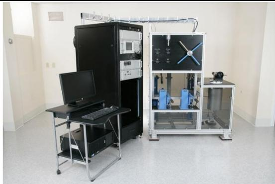
Figura 40: medidor de propriedades elásticas AUTOLAB 500, fabricado pela NER.
