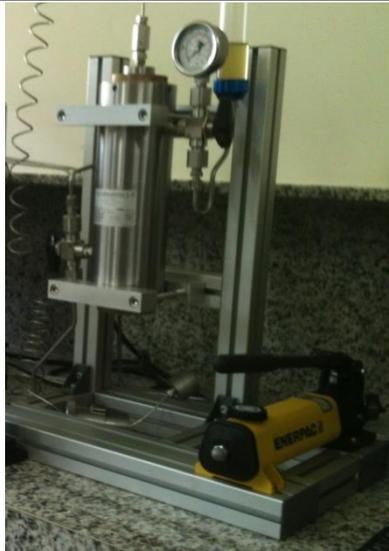
Figura 39: *Core Holder* do ensaio de medição de permeabilidade no equipamento ULTRA-PORO/PERM 500.
