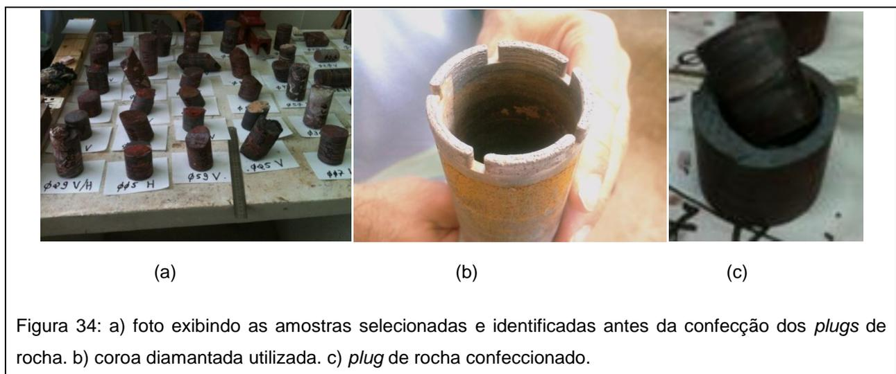
Figura 34: a) foto exibindo as amostras selecionadas e identificadas antes da confecção dos *plugs* de rocha. b) coroa diamantada utilizada. c) *plug* de rocha confeccionado.
