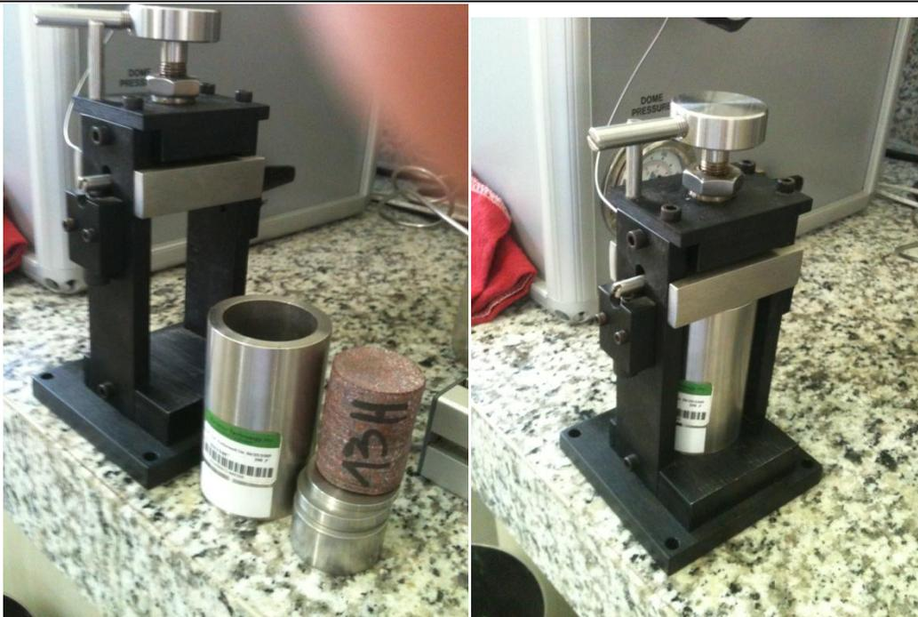
Figura 37: Detalhe do local de acondicionamento do *plug*, copo matriz para medição de porosidade, do equipamento Ultra-Poro/Perm-500 fabricado pela CORE LAB INSTRUMENTS.
