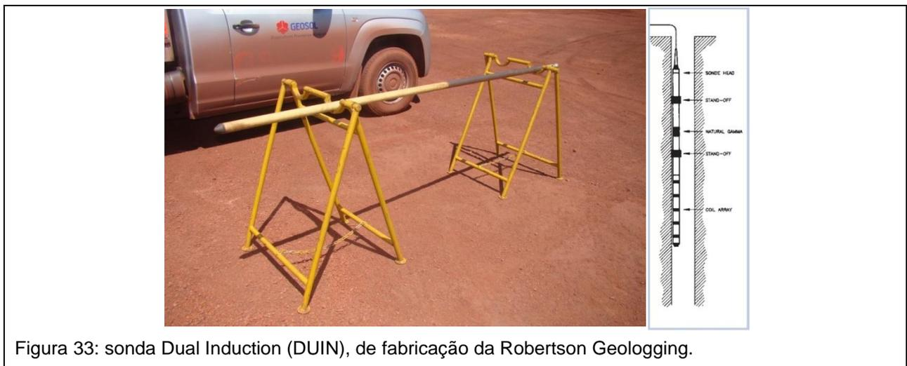
Figura 33: sonda Dual Induction (DUIN), de fabricação da Robertson Geologging.
