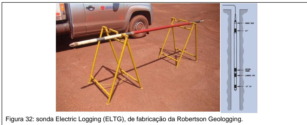
Esta ferramenta fornece os perfis de resistividade normal curta (16 pol.), resistividade normal longa (64 pol.), resistência de ponto único (SPR), potencial espontâneo (SP), gama natural em unidades API e de temperatura em °C.
