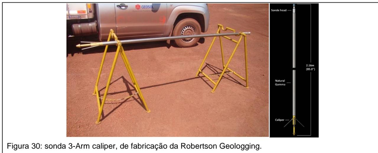
Figura 30: sonda 3-Arm caliper, de fabricação da Robertson Geologging.
