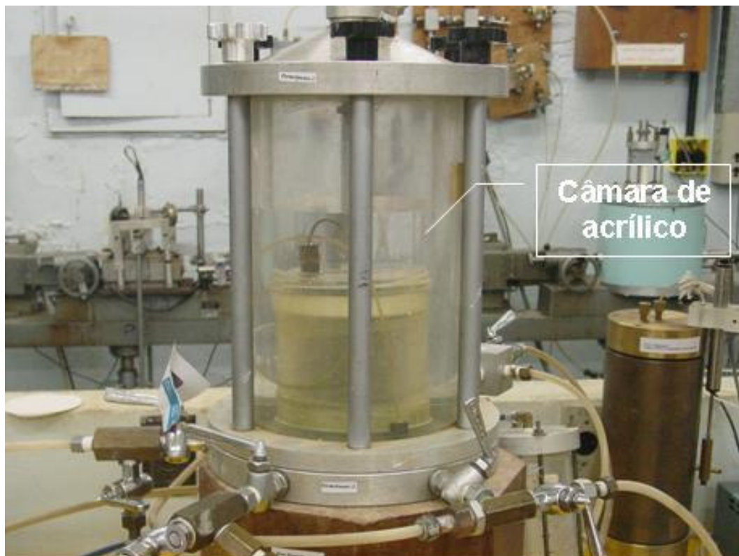
Figura 4.14-Preenchimento da câmara com água.
