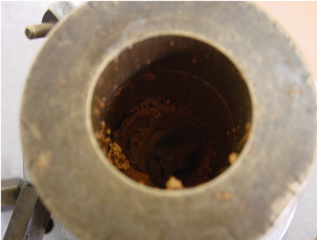
Figura 5.21-Vista superior do molde de pisoteamento com solo deformado devido às elevadas pressões de compactação.
