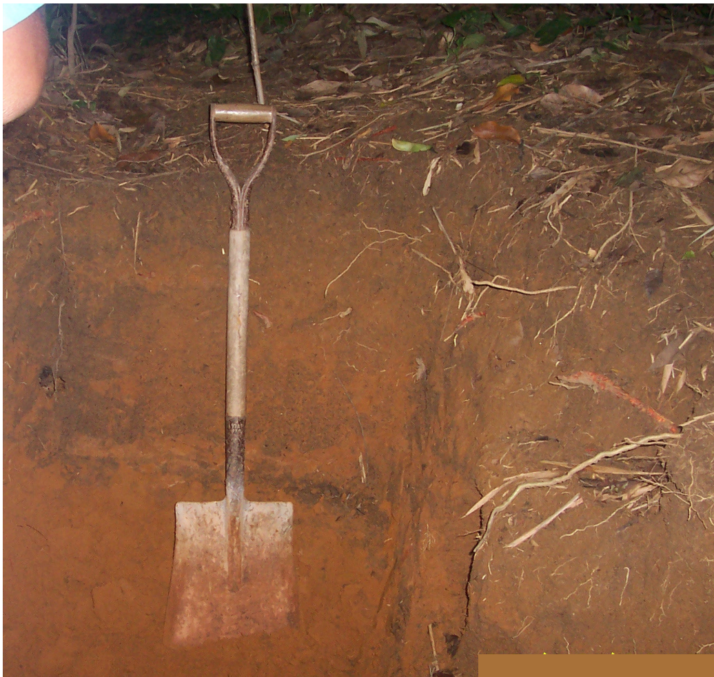
Figura 3.4-Profundidade da escavação para extrair a amostra deformada.
