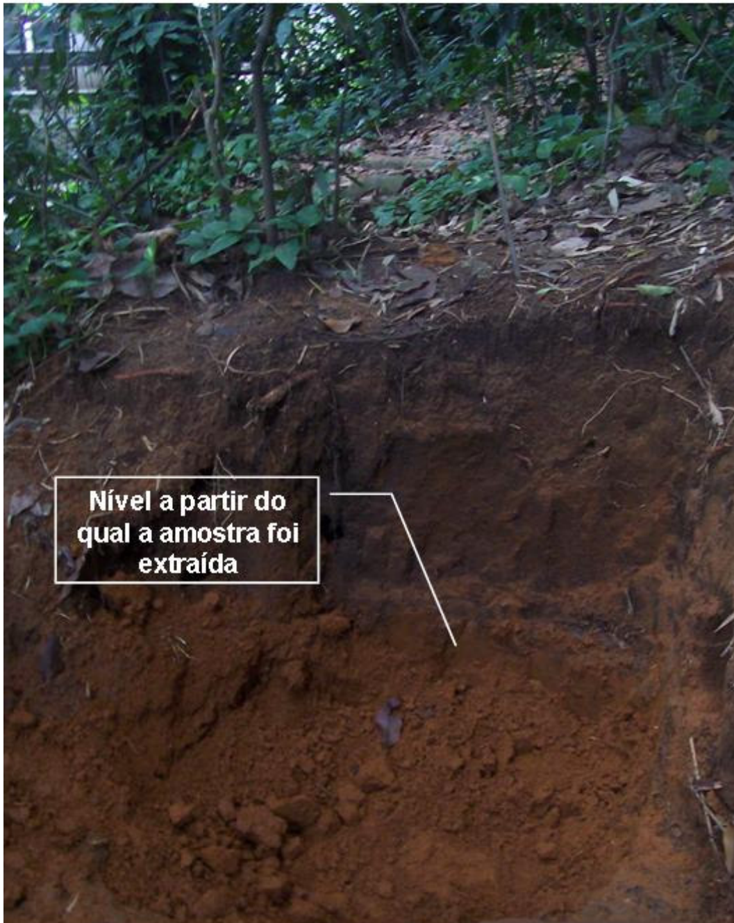
Figura 3.3-Retirada da amostra deformada no Campo Experimental II da PUC-Rio.
