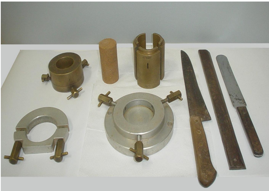
Figura 4.2-Molde tripartido, base de alumínio e anéis médio e superior de confinamento; amostra de solo obtida a partir do pisoteamento; outros acessórios.
