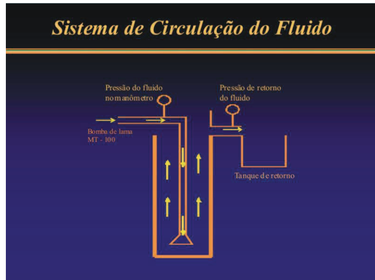
Figura 3. 19: Resumo simplificado do sistema de circulação do fluido.
