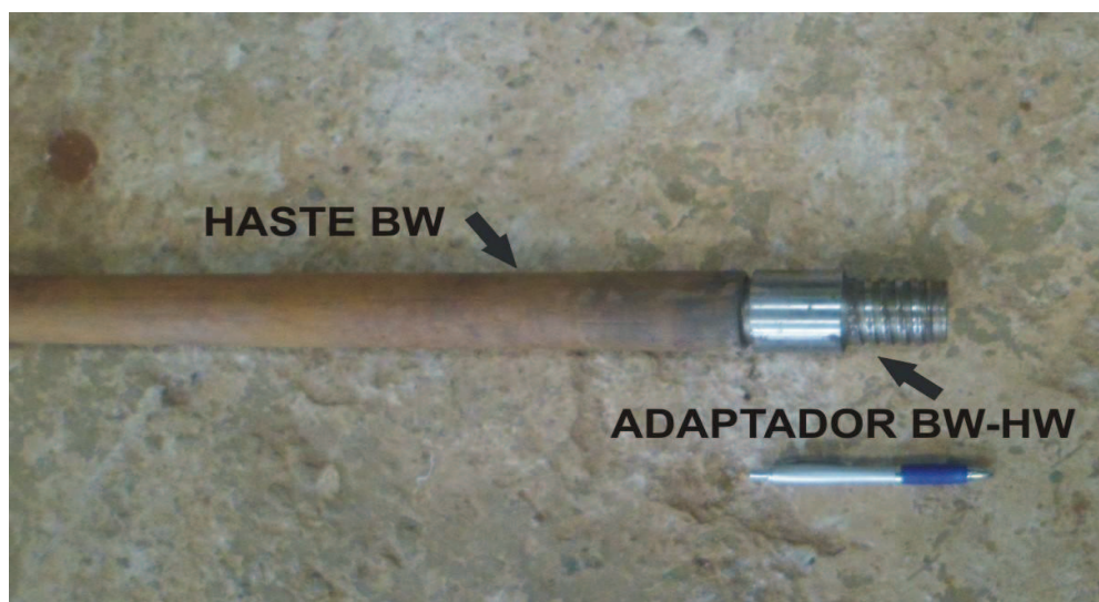
Figura 3. 16: Haste BW com adaptador BW-HW responsável pela conexão ao barrilete HW.
