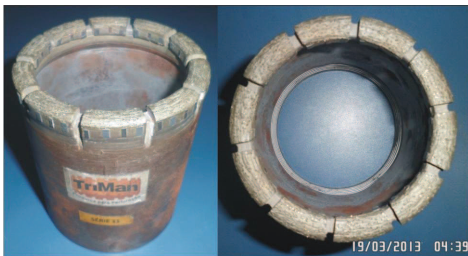
Figura 3. 23: Coroa diamantada Triman série 11 com desgaste por uso, em vista frontal e superior.
