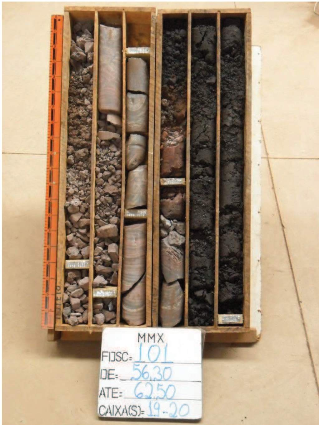
Figura A. I. 4: Furos FDSC 101 - Itabirito Compacto Fraturado na sequência Itabirito Friável.
