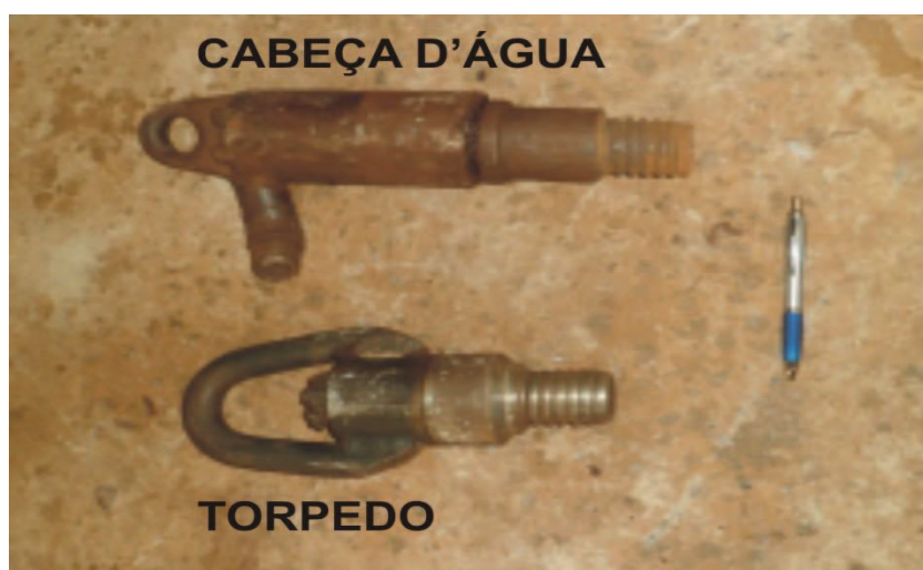
Figura 3. 17: Cabeça d'água e torpedo para haste BW.
