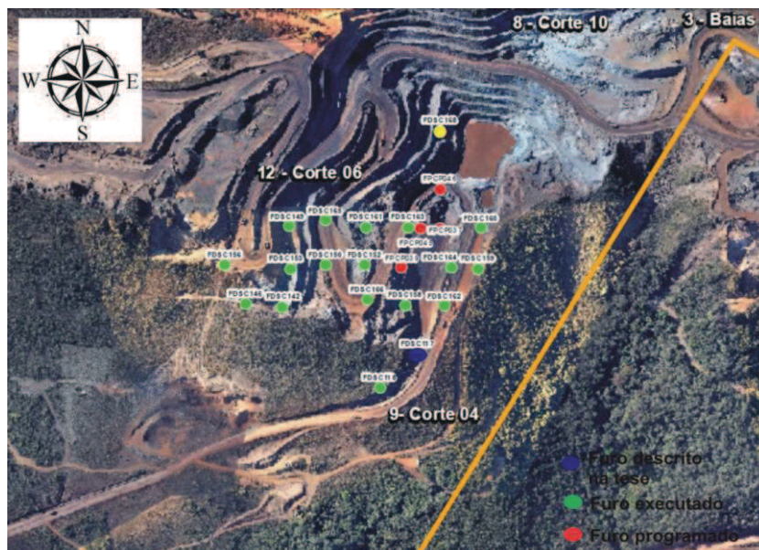
Figura 3. 4: Furo FDSC 117 realizado na região do Corte 04 na Sondagem de Curto Prazo (Fonte: Arquivo Sondagem Serra Azul Curto Prazo GB3 MG SE A2 Rev04 20120614. mxd).
