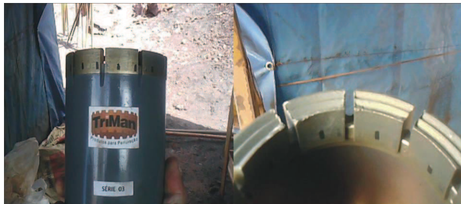
Figura 3. 22: Coroa diamantada Triman série 3 em vista frontal e superior.
