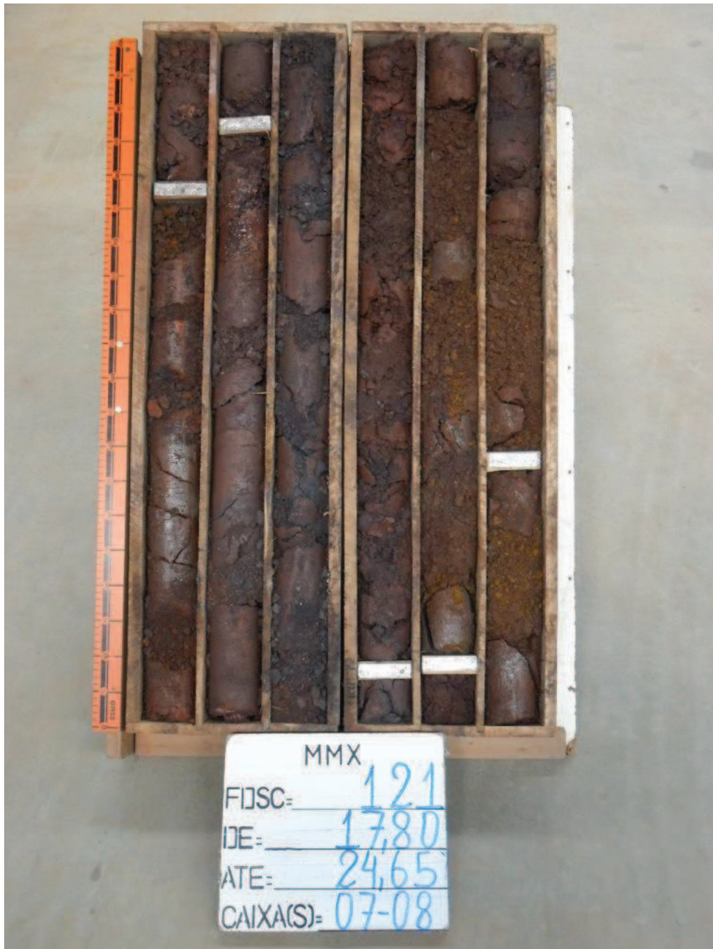
Figura A. I. 6: Furo FDSC 121 - Itabirito Laterítico com fragmentos de Itabiritos Compactos.
