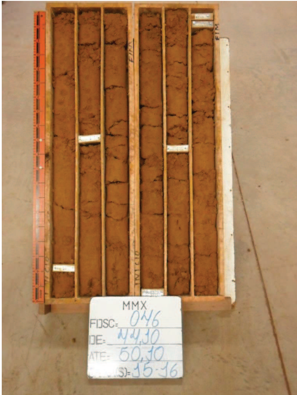
Figura A. I. 1: Furo FDSC 046 Rocha Intrusiva alterada.
