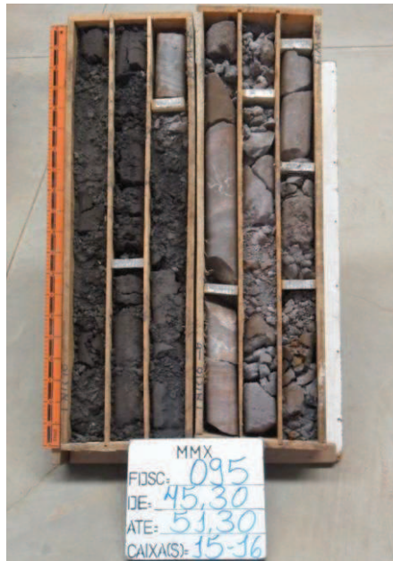
Figura 3. 26: Exemplo de fotografia de caixa de testemunho.
