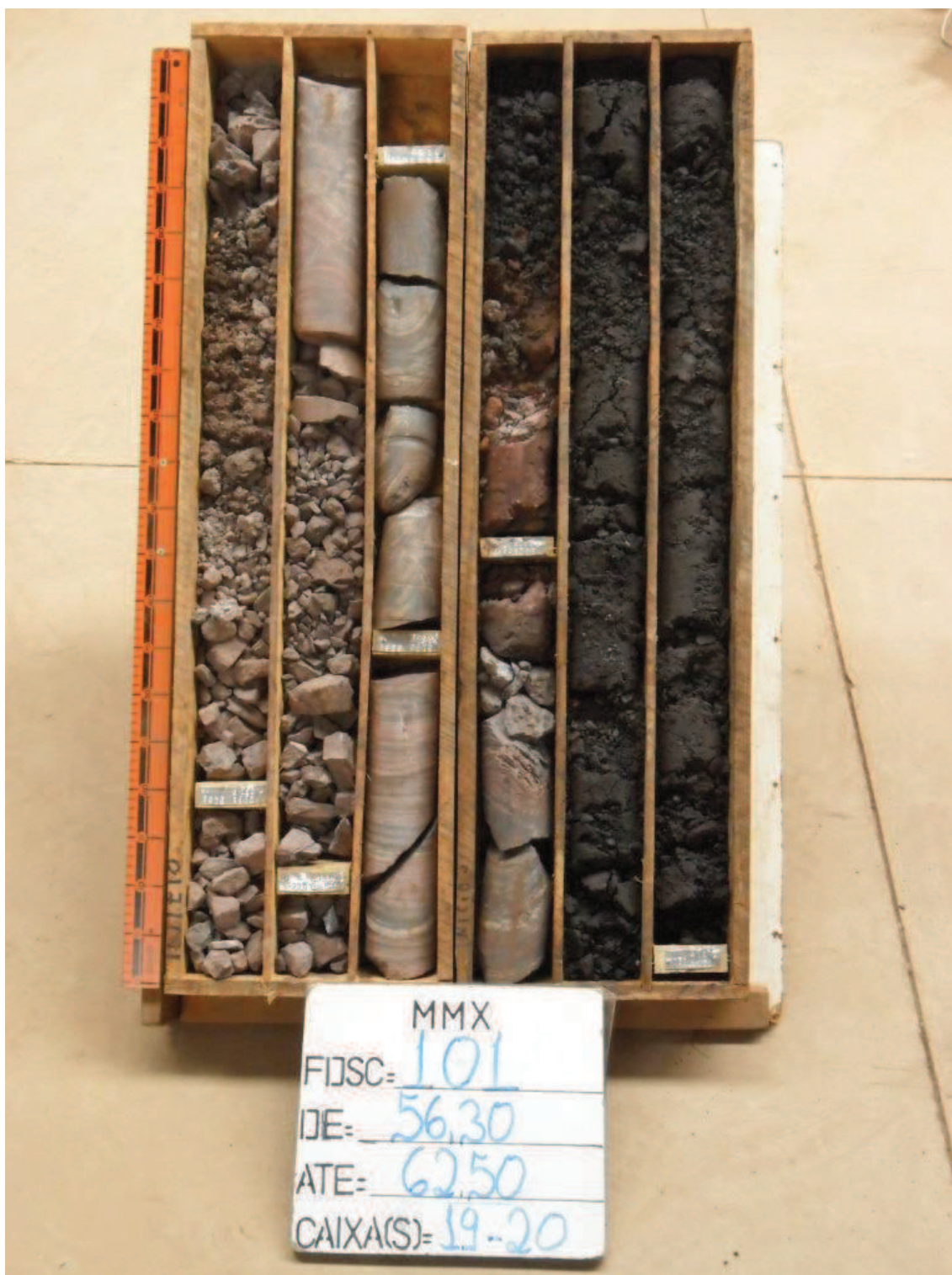
Figura 4. 4: Fotografia de testemunho de sondagem do Furo FDSC 101 em intervalo que representa as litologias exemplificadas na Coluna Estratigrafia – A, do esquema Simplificado da Figura 4.3.
