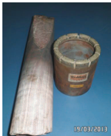
Figura 3. 24: Coroa diamantada Triman série 11 ao lado de um pedaço de testemunho de itabirito compacto.
