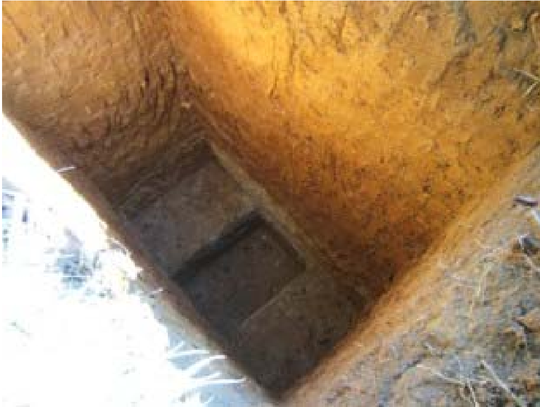
Figura 3.7 – Poço para coleta de blocos indeformados
