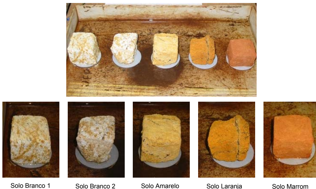
Figura 5.56 – Desagregabilidade - corpos-de-prova colocados sobre pedra porosa no início do ensaio por imersão progressiva - água na altura da base
