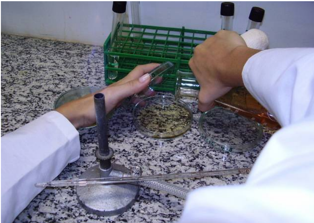
Figura 4.6 – Técnica de derramamento em profundidade ou Pour Plate
