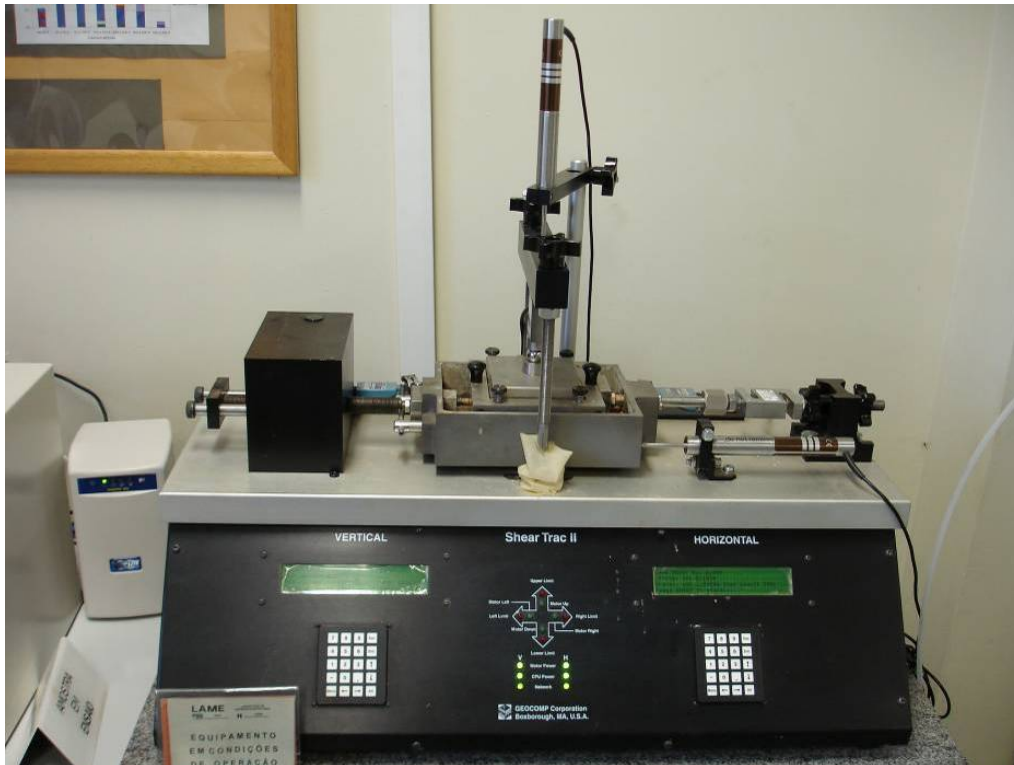
Figura 4.8 – Prensa Shear Trac II utilizada nos ensaios – LAME/LACTEC – Laboratório de Materiais e Estruturas, Centro Politécnico da UFPR
