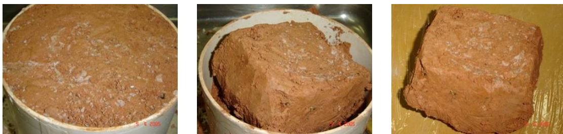
Figura 4.3 – Bloco de solo sendo moldado para impregnação
