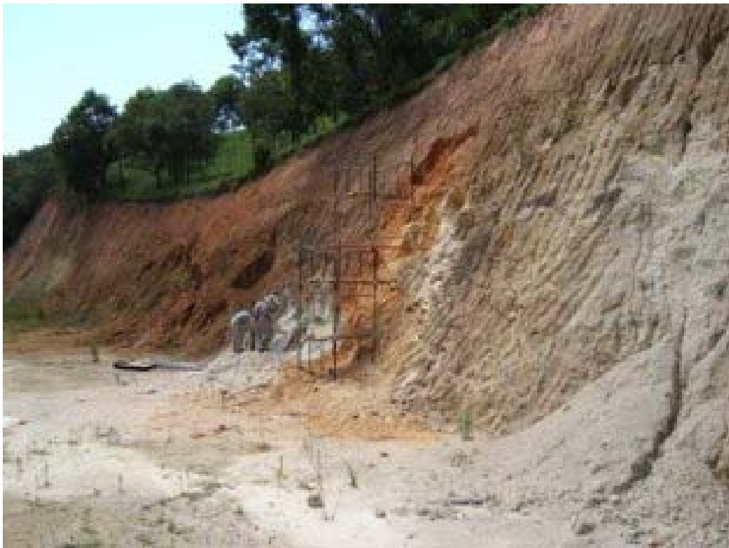
Figura 3.5 – Andaime para coleta de amostras de solo
