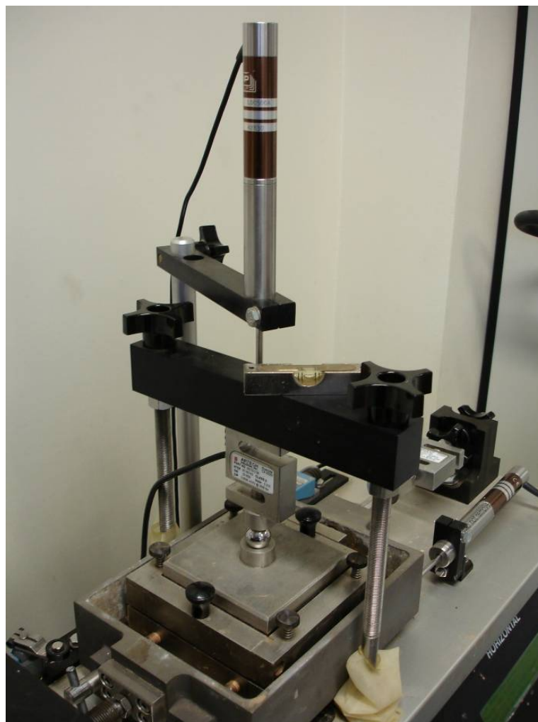
Figura 4.9 – Detalhe da caixa de cisalhamento da Prensa Shear Trac II
