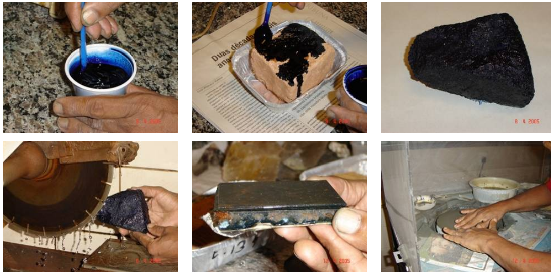
Figura 4.4 – Impregnação do bloco e preparação da lâmina
