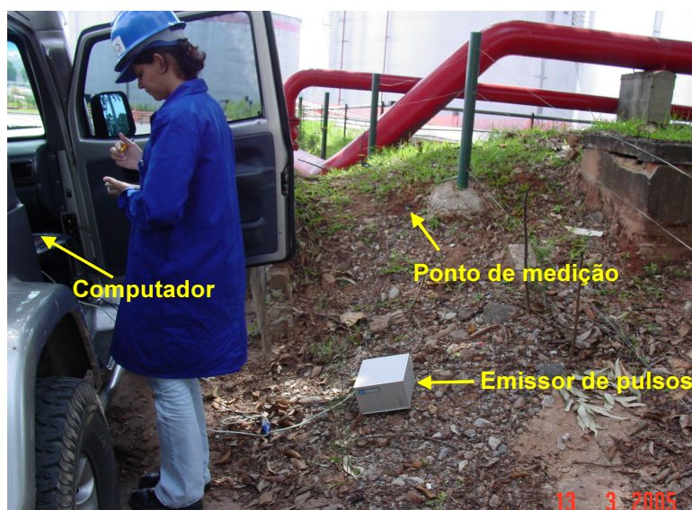
Figura 4.5 – Constante dielétrica sendo medida na base de combustíveis
