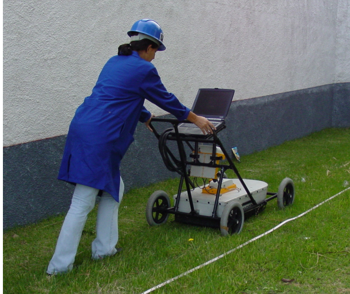
Figura 4.4 – Aquisição com o GPR na base de combustíveis em São Paulo-SP
