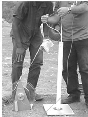
Figura 21 - Operação de Leitura no Medidor Magnético de Recalque.
