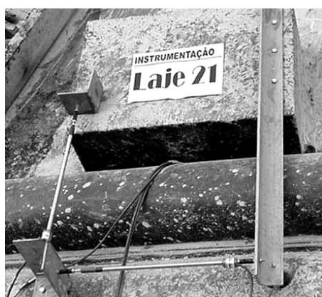
Figura 38 - Medidor triortogonal.
