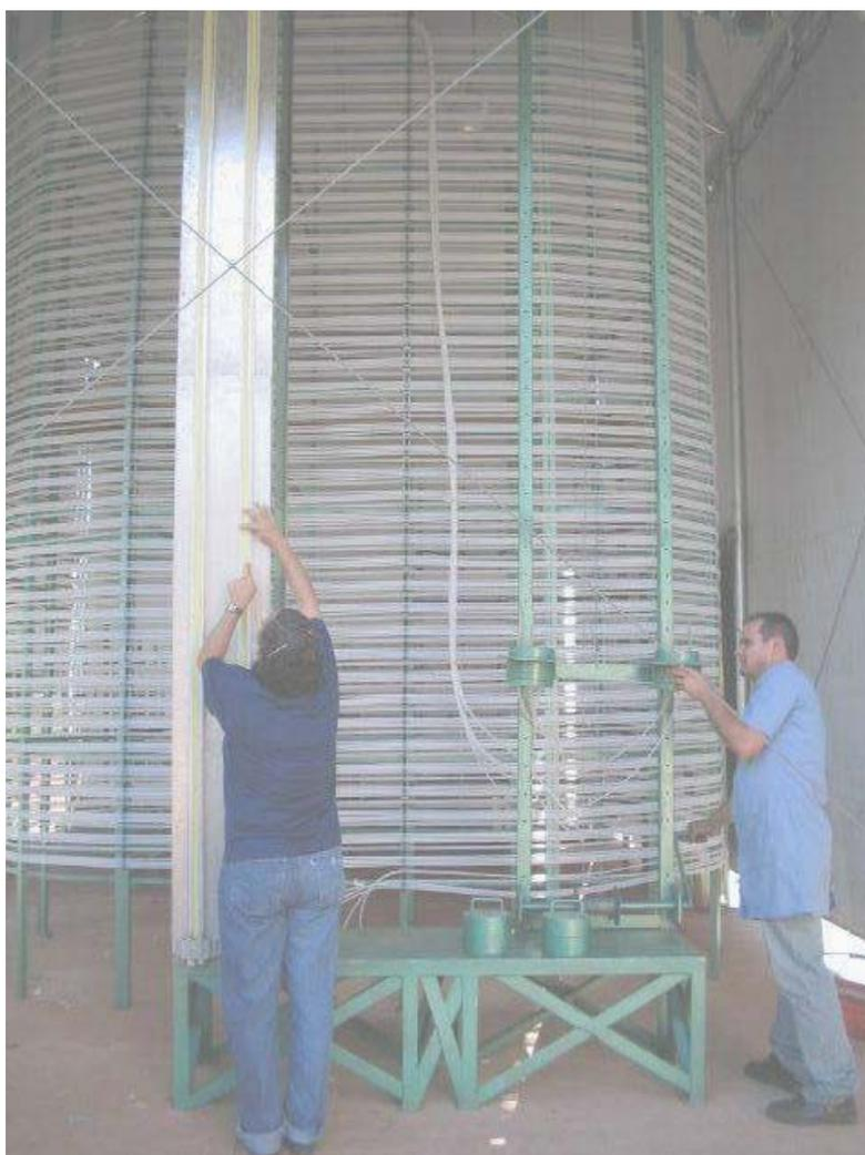
Figura 39 - Protótipo do Medidor Hidrostático de Recalques.
