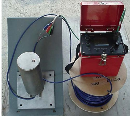
Figura 34 - Cilindro metálico para proteção da ampola, cabos elétricos e leitora.
