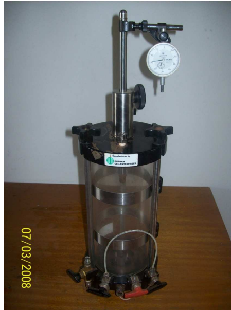
Figura 3.3 – Célula triaxial modificada do Ensaio HCT - UFOP
