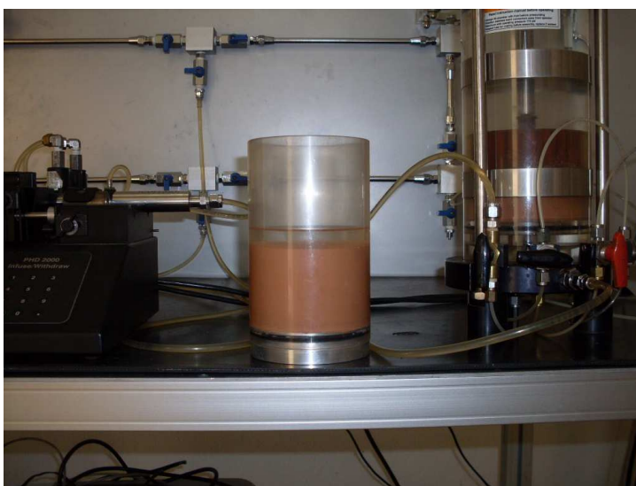
Figura 5.8 - Corpo de prova adensado sob a ação do peso próprio para a determinação da altura reduzida H_s
