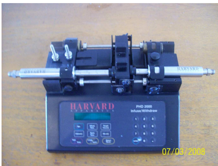
Figura 3.6 – Bomba de Fluxo acoplada ao Ensaio HCT - UFOP
