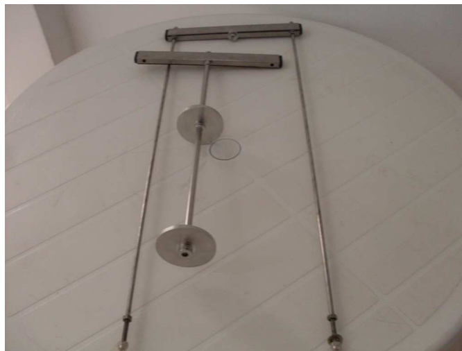
Figura 4.12 – Pórtico e pendural para aplicação de cargas do Ensaio HCT - M
