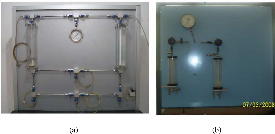
Figura 4.4 – Painel de controle do Ensaio HCT [arranjo novo (a) e arranjo original(b)]
