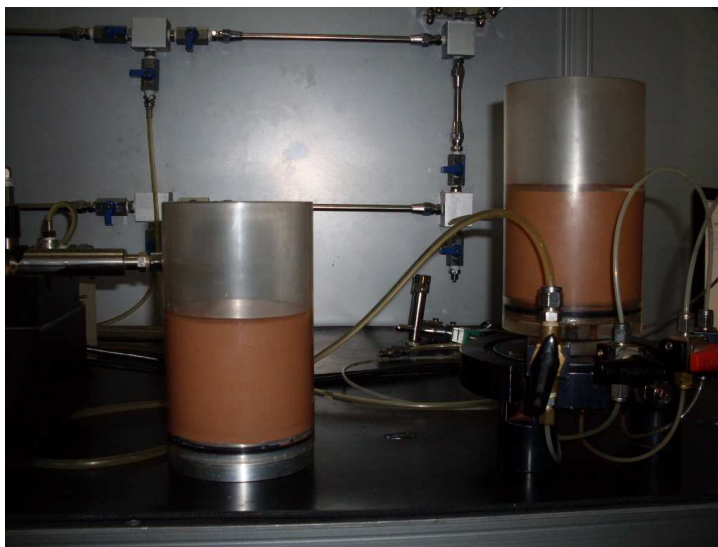
Figura 5.7 - Corpos de prova preparados para ensaio de adensamento e para o ensaio de determinação do teor de umidade relativo ao índice de vazios à tensão efetiva nula ( e_{00} )
