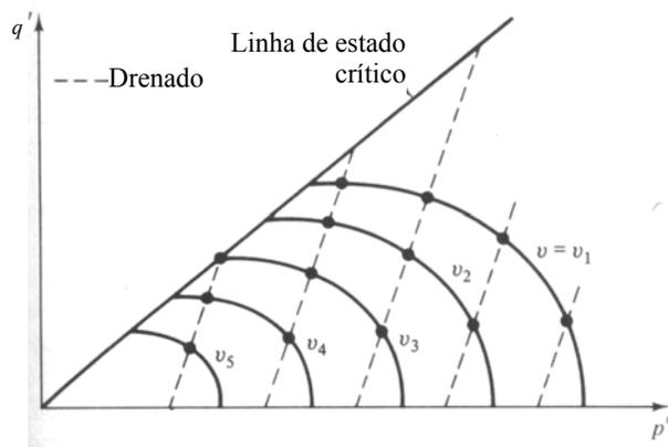
Figura 2.8.2 – Conjunto de ensaios drenados e curvas de mesmo  $v$  (Atkinson e Bransby, 1978).
