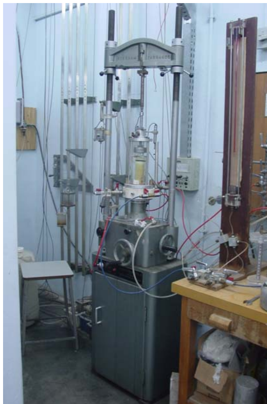
Figura 20 - Prensa de Ensaio Triaxial pertencente ao Laboratório de Geotecnia e Meio Ambiente do DEC da PUC-RIO.
