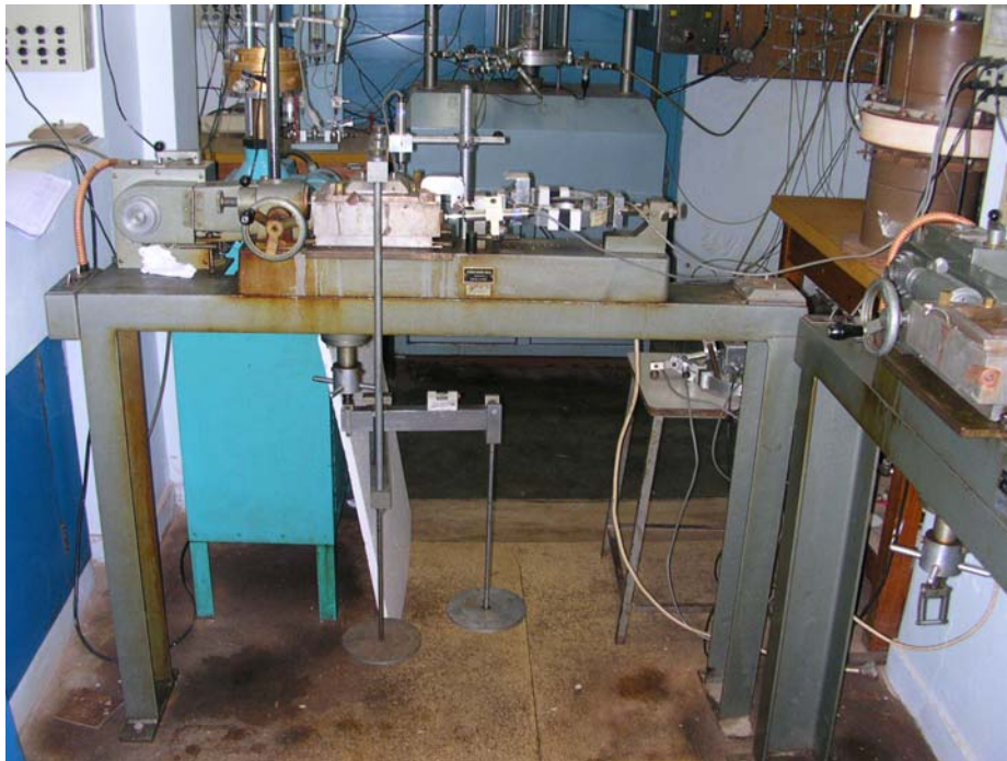
Figura 19 – Prensa de Cisalhamento Direto pertencente ao Laboratório de Geotecnia e Meio Ambiente do DEC da PUC-RIO.
