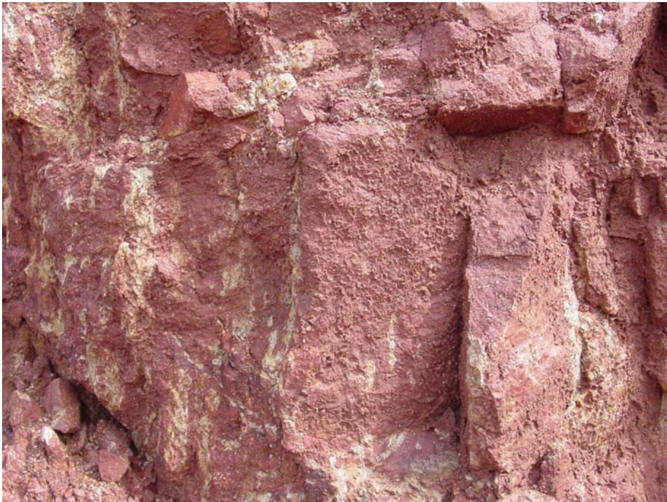
Figura 9– Compartilhamentos de fraturas sub-horizontais e sub-verticais no solo residual jovem.
