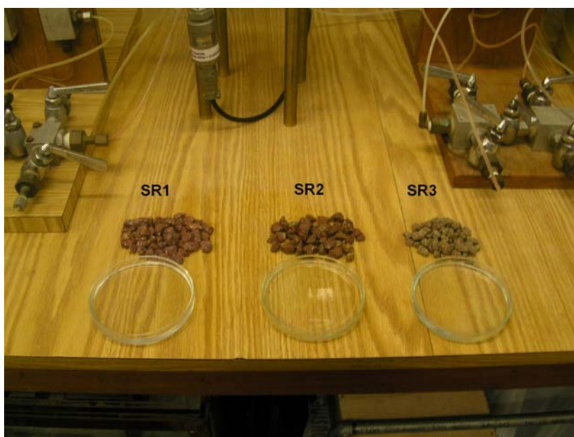
Figura 18 – Amostras de SR1, SR2 e SR3, que seriam imersas em etilenoglicol.
