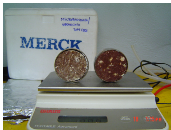
Figura 16 - Amostras de SR2 apresentando redução de volume após secagem.
