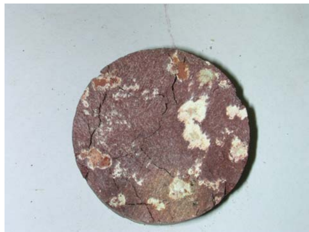
Figura 17 – SR2 apresentando trincas, após secagem ao ar.
