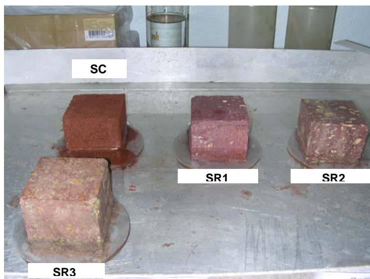
Figura 42- Amostras submetidas ao ensaio de desagregabilidade com NA 1/3 da altura das amostras.
