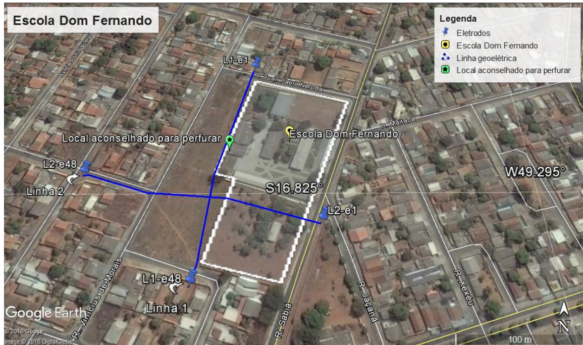
Figura 16 - Disposição das linhas geolétricas 1 e 2 na escola Dom Fernando em Aparecida de Goiânia (GO).
