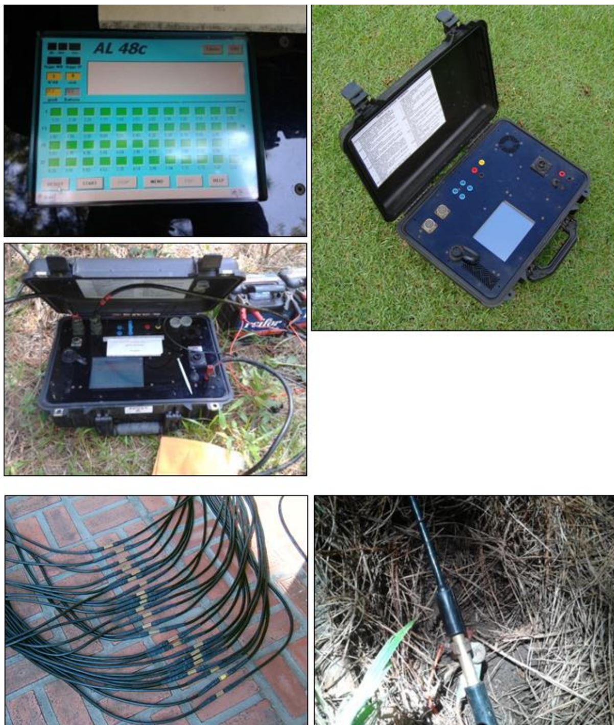
Figura 12 - Resistivímetro EEG AL48, cabos multipolares e eletrodo.
