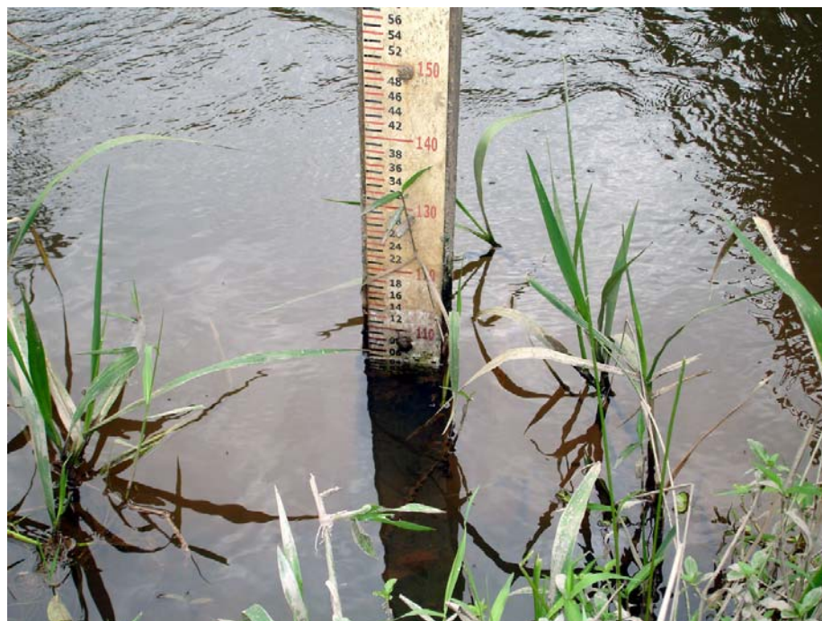
Figura 27. Régua do posto fluviométrico G13 no Rio Embu Guaçu
