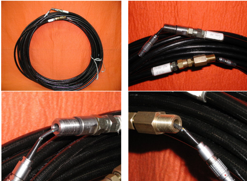
Figura 53 – Detalhes da mangueira de pressão e conectores.
