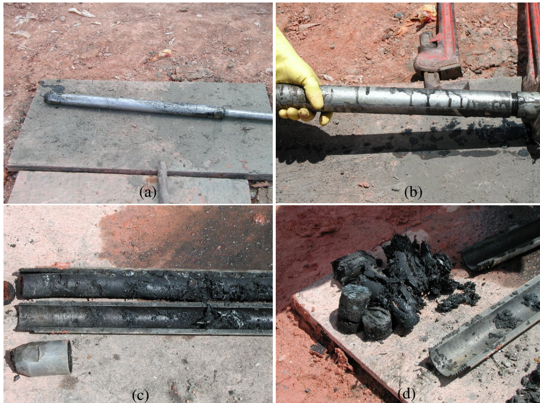
Figura 103 – Amostragem durante ensaios SPT em RSU: (a) amostrador padrão; (b) abertura do amostrador; (c) material bem recuperado; (d) parcela da amostra representativa.
