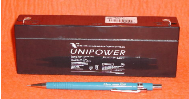
Figura 58 – Bateria recarregável de 12V usada como fonte de alimentação do circuito.
