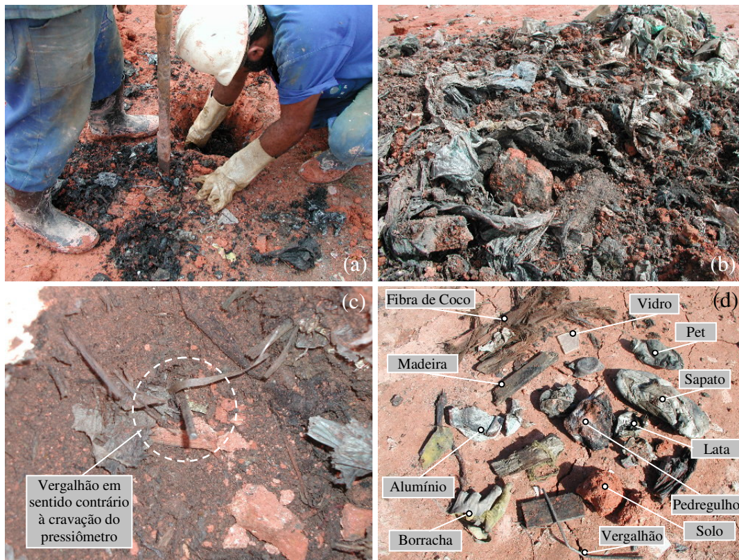
Figura 94 – Resíduo da camada superficial célula 5: (a) retirada manual; (b) in natura; (c) vergalhão no furo; (d) materiais diversos
