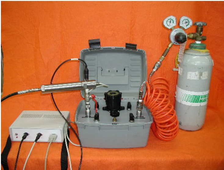
Figura 61 – Fonte de pressão conectada na caixa de controle de pressões
