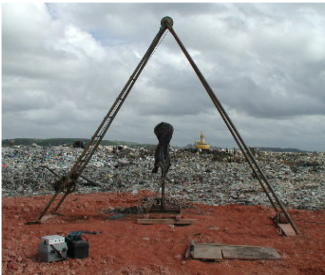
Figura 95 – Trado do SPT alinhado com cravador do PMT/CPT
