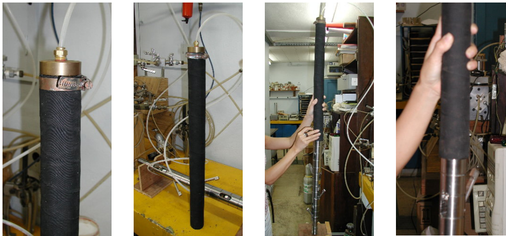
Figura 66 – Fotos do procedimento de colocação da membrana.
