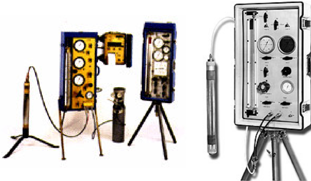
Figura 2 – Fotos de pressiômetros do tipo Ménéard e componentes.
