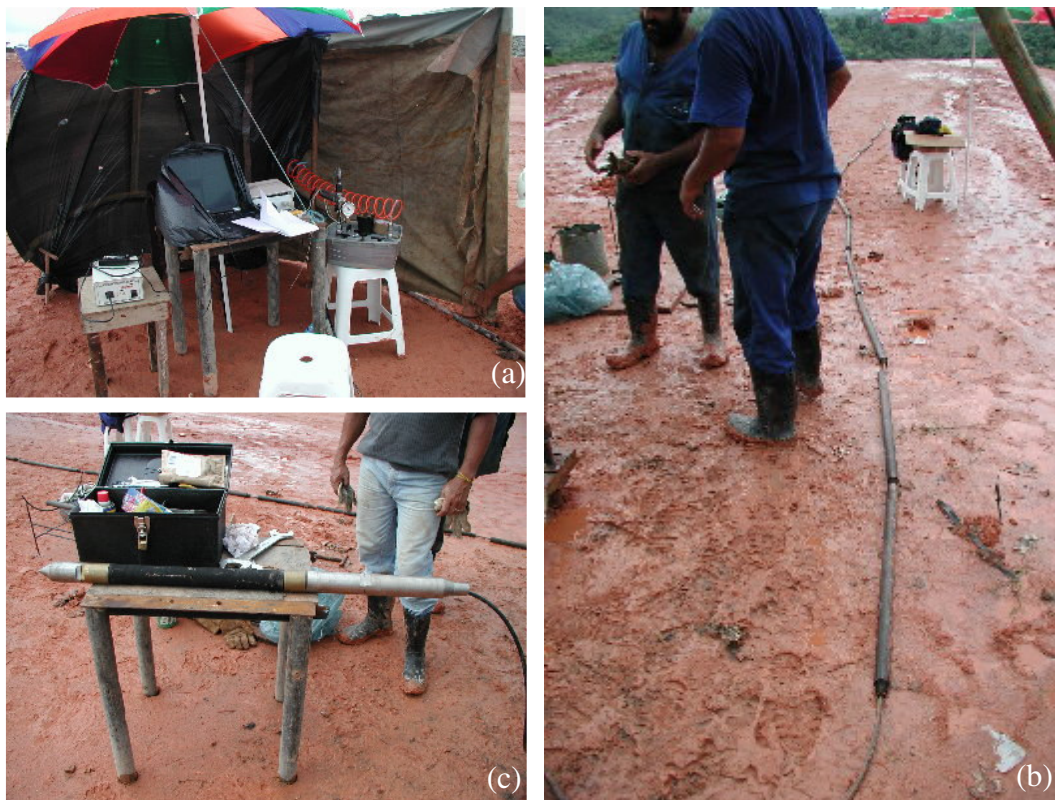
Figura 97 – Fotos de algumas etapas de instalação anteriores ao ensaio: (a) caixa de controle, circuito e computador montados e acoplados; (b) mangueira passada pelas hastes; (c) sonda montada e conectada.
