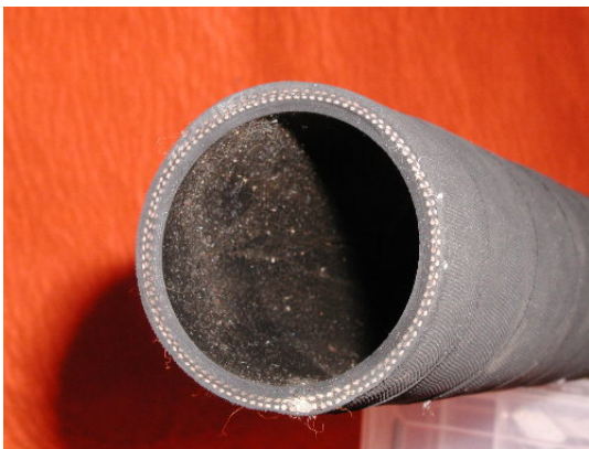
Figura 49 - Detalhes da membrana semi flexível de borracha.
