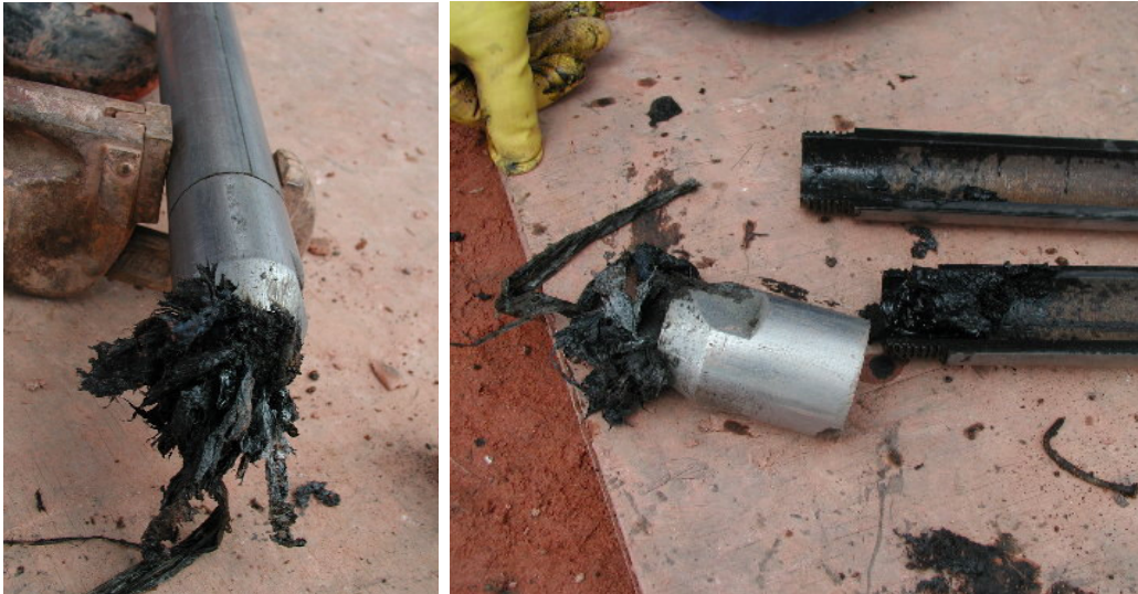
Figura 104 – Entupimento da ponteira com plástico durante ensaio SPT com pouca recuperação de material.
