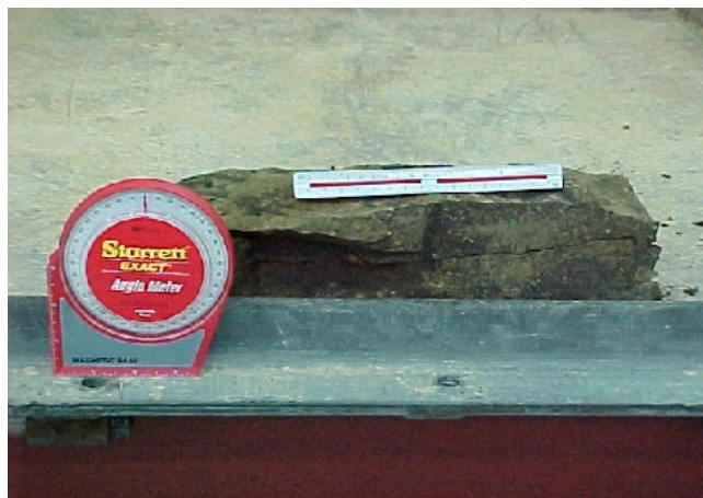
Figura 5.33 Amostra de fratura sem preenchimento do talude do derrame D11.
