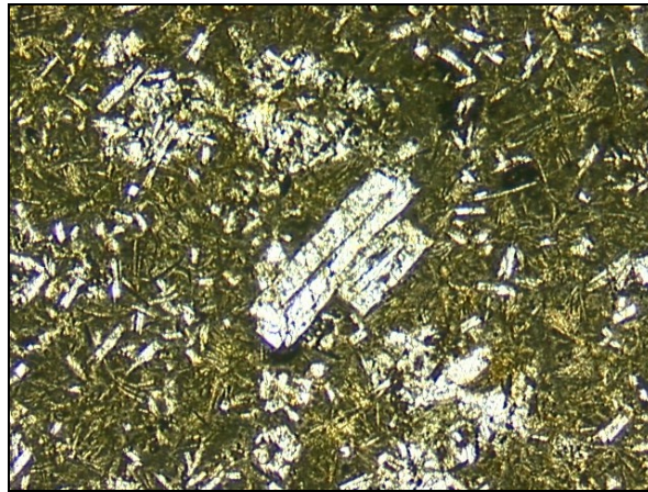
Figura 4.3 Fotomicrografia (2,5X LN, dimensões do campo: 3,6 x 5,4mm) do D1, mostrando textura em peneira dos fenocristais de plagioclásio.
