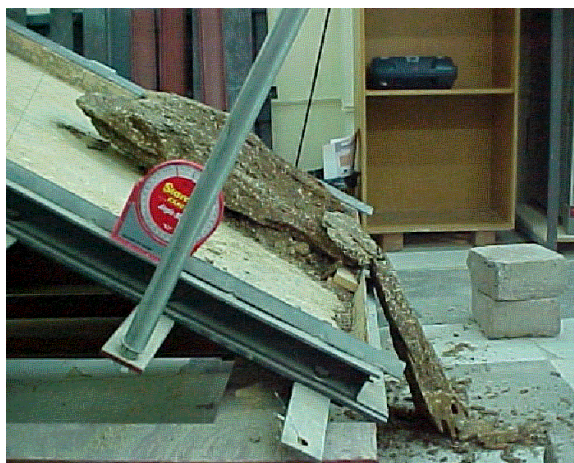
Figura 5.36 Ruptura da amostra.
