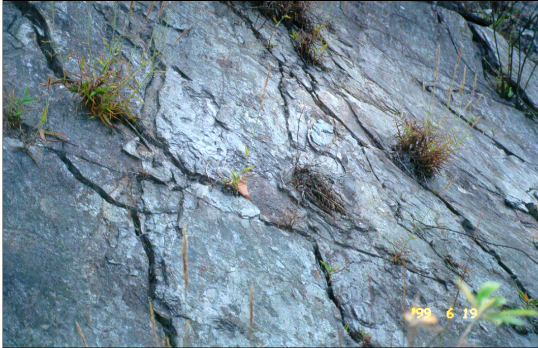
Figura 5.10. Vista das famílias de fraturas (F2 e F3).
