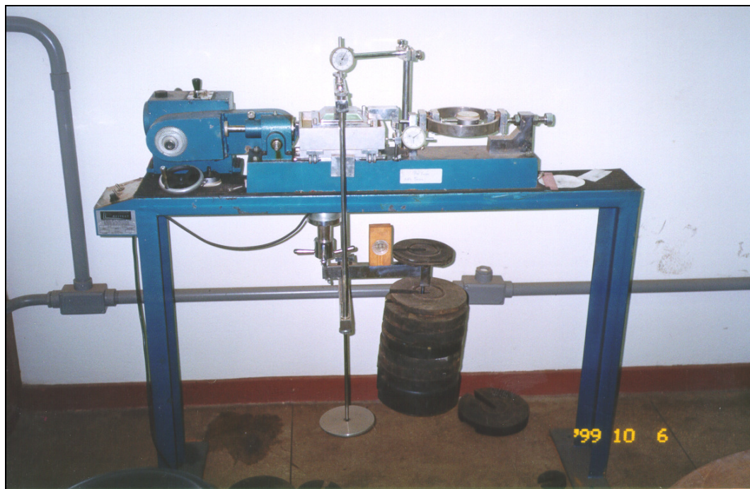
Figura 6.7. Prensa de Cisalhamento Direto usada na execução dos ensaios.
