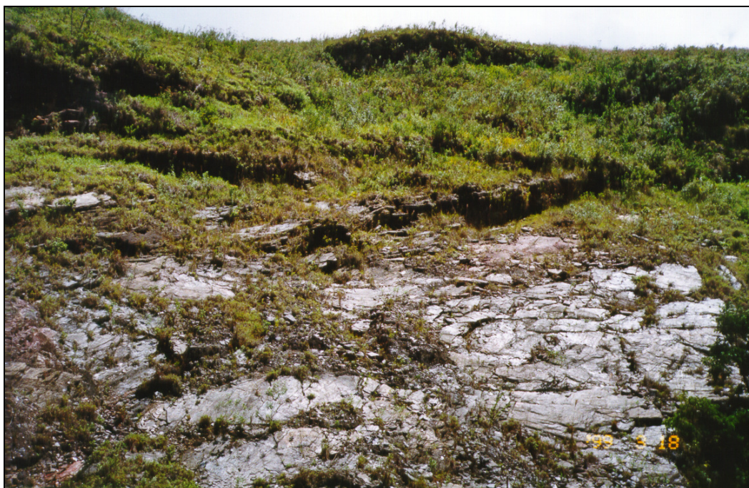
Figura 5.9. Setor geotécnico 5, principal descontinuidade família de foliação (F1).
