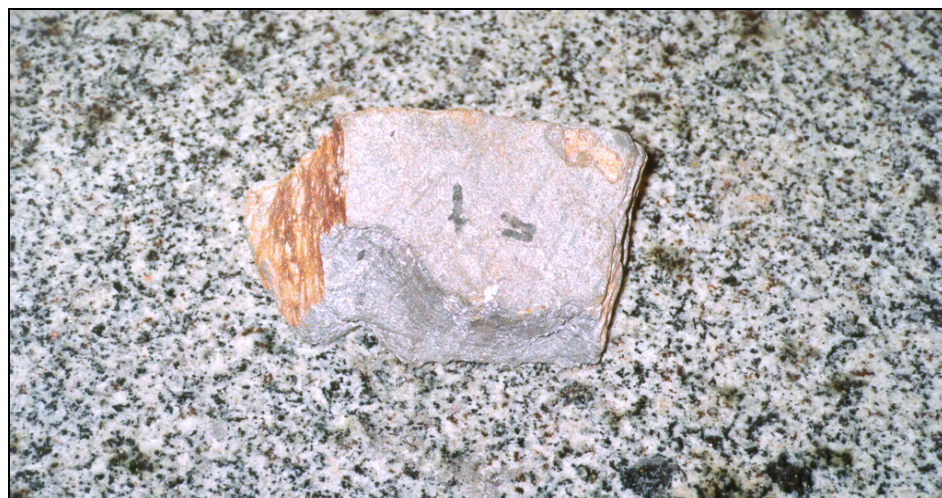
Figura 6.2. Corpo de prova do xisto para realização dos ensaios.
