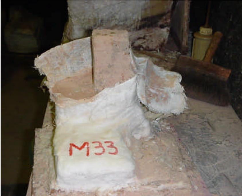
Figura 34 - Bloco indeformado M33
