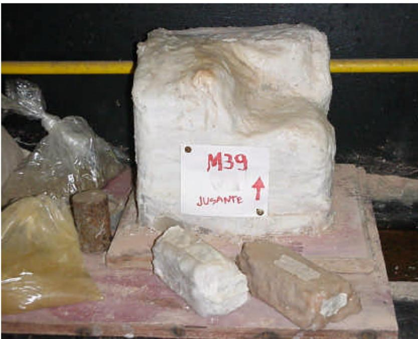
Figura 35 - Bloco indeformado M39
