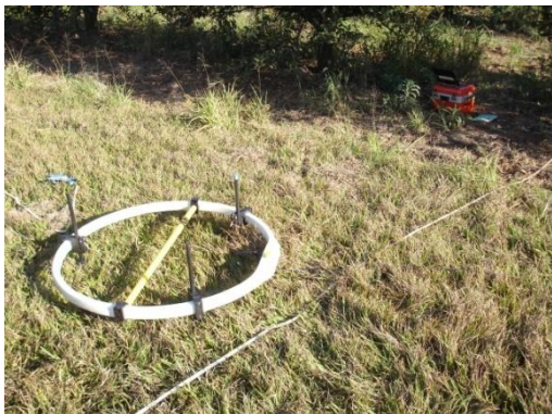
Figura 12. Equipamento Protem (Geonics) utilizado na aquisição de dados. a) Receptor PROTEM. b) Transmissor TEM57-MK2 e gerador à gasolina. c) Bobina receptora.
