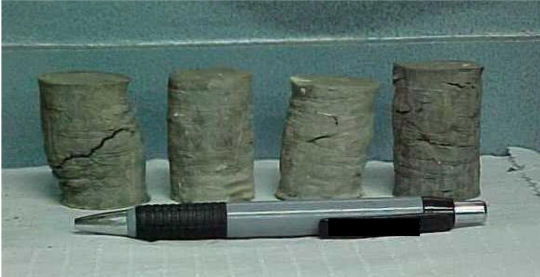
Figura 41 - Corpo de provas depois da realização de ensaio triaxial
