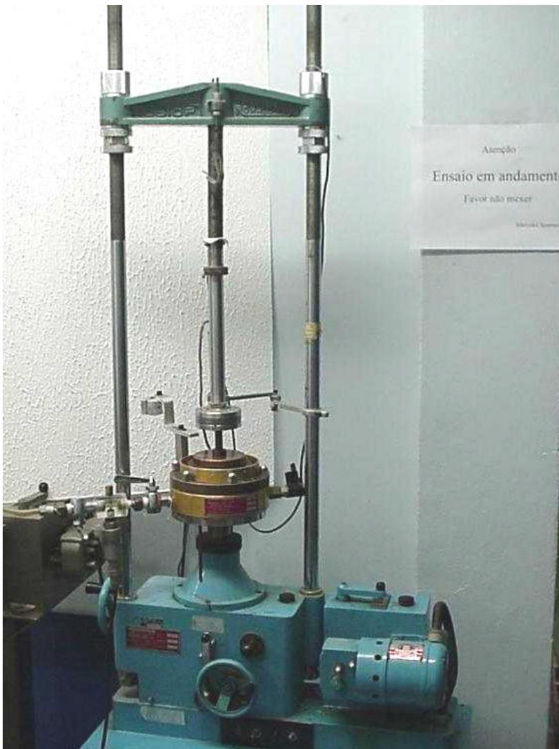
Figura 39 - Prensa utilizada para os ensaios CRS
