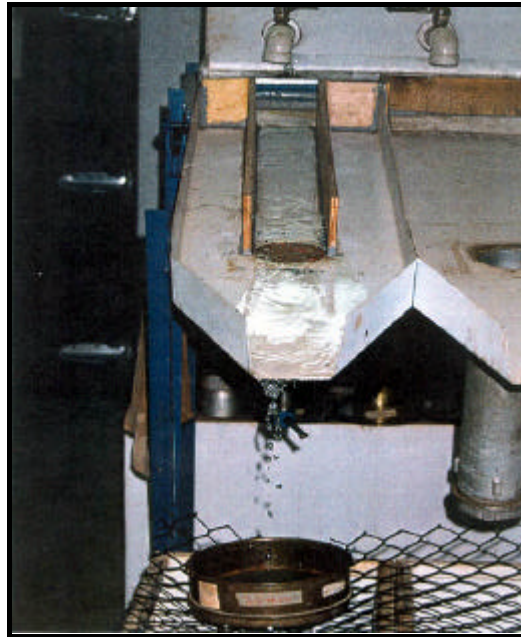
Figura 5.35 – Ensaio de Inderbitzen em andamento
