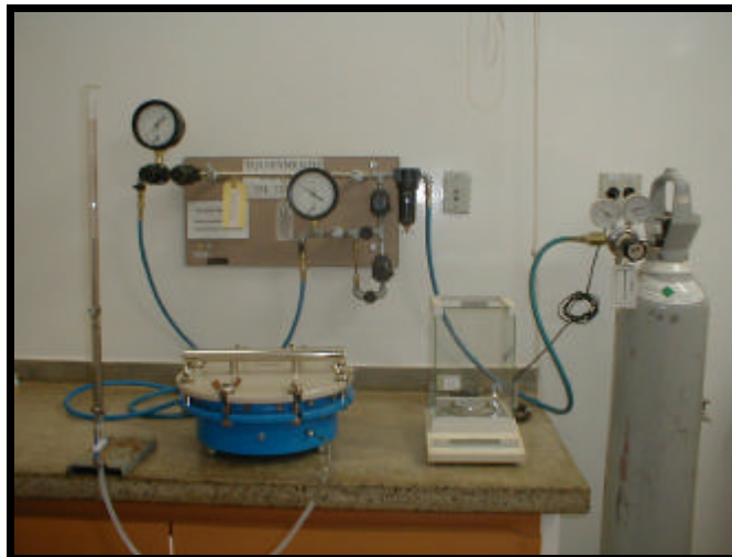
Figura 5.59 – Câmara de Pressão de Richards
