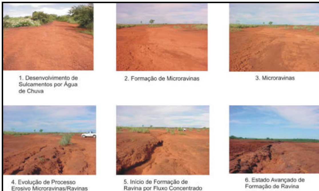
Figura 4.17 – Modelo representativo dos processos erosivos resultantes da incidência de fluxo sobre o solo estudado (estágio I)
