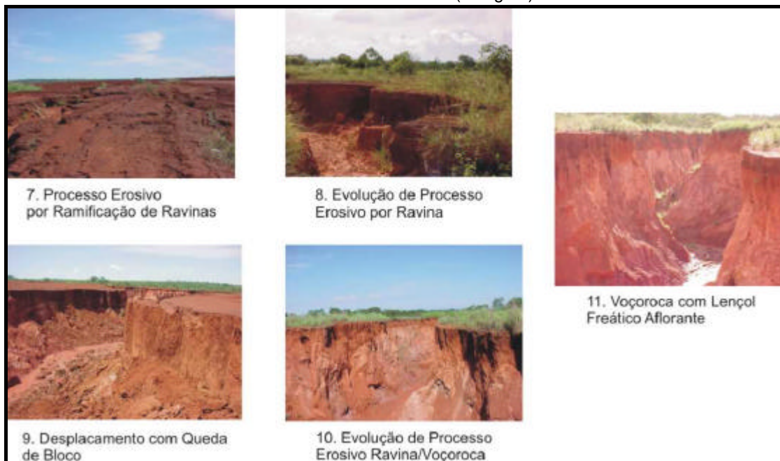
Figura 4.18 – Modelo representativo dos processos erosivos resultantes da incidência de fluxo sobre o solo estudado (estágio II)
