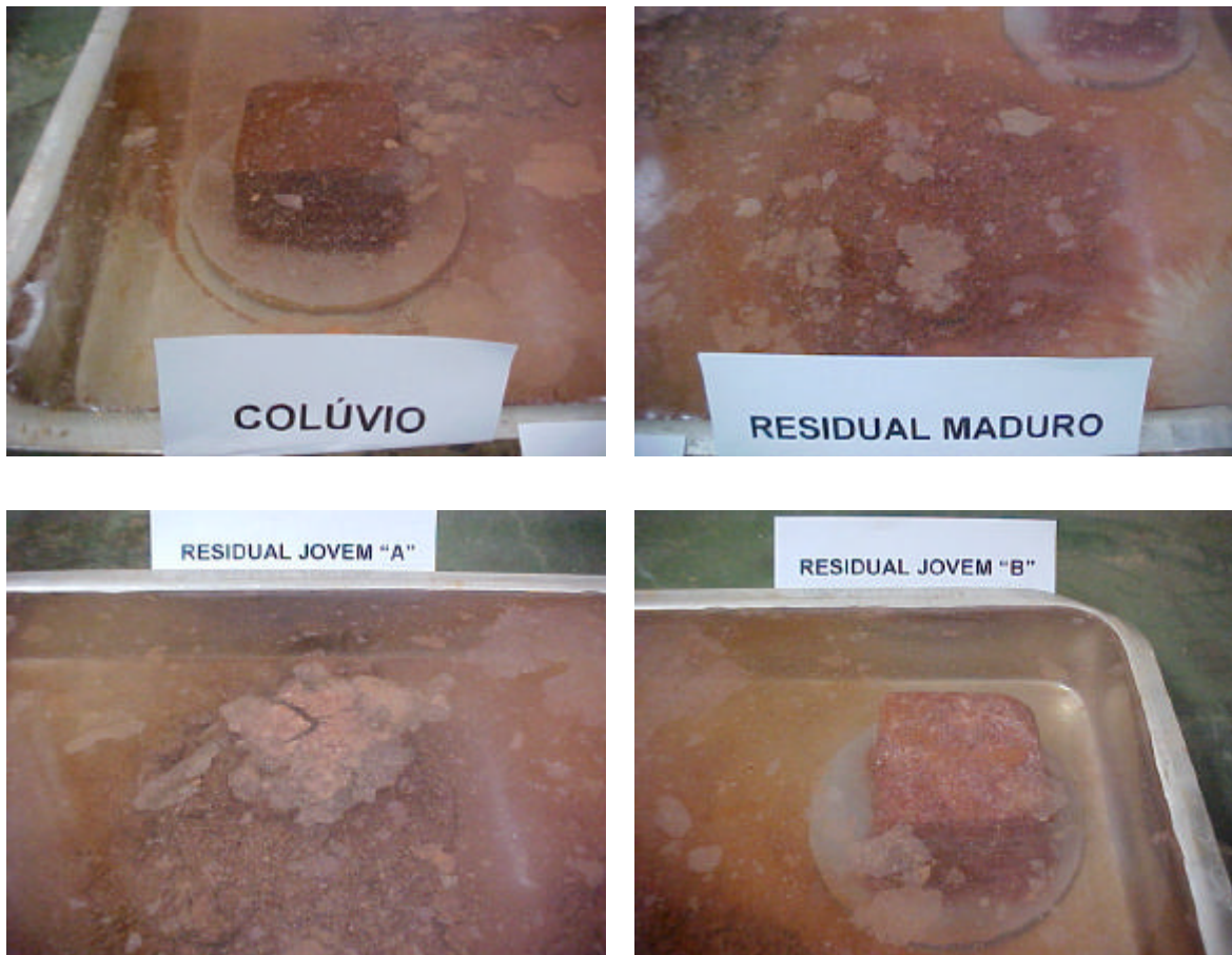
Figura 5.20 – Amostras colocadas sobre Pedra Porosa, Ensaio de Imersão Total (após 15 min)
