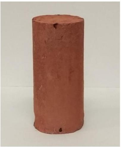
O ensaio foi paralisado no limiar da ruptura no estágio de cisalhamento, realizado com tensão de adensamento de 100 kPa e, posteriormente, foi adensado até 200 kPa. A Figura 68 traz a trajetória de tensões do ensaio, mostrando as fases de adensamento, carregamento e descarregamento axial e o ponto de finalização do ensaio. Como pode ser visualizado na figura da Tabela 11 não ocorreu formação de plano de ruptura evidente em escala macroscópica.
