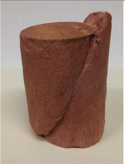
A Figura 75 apresenta os gráficos de tensão-deformação e de variação de poro-pressão *versus* deformação axial. Não se observou estabilização da tensão desviatória no último estágio. Em relação ao comportamento das poro-pressões, houve aumento das pressões até o momento da ruptura. A Figura 76 apresenta o gráfico tensão-deformação normalizados.
