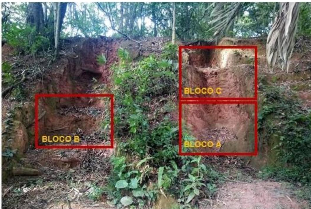
**Figura 25. Locais de retirada de blocos indeformados (blocos A, B e C) em talude pré-escavado no campo experimental de geotecnia do LMS-USP**
