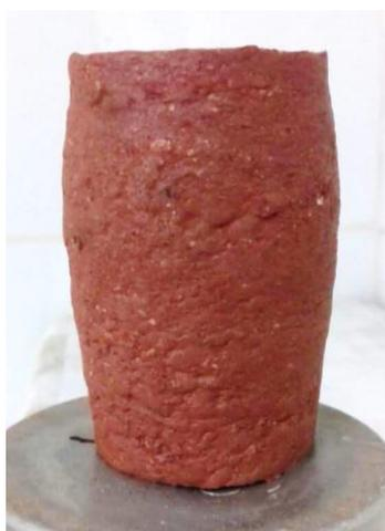
**Figura 39. Corpo de prova compactado após ruptura – ensaio B**
