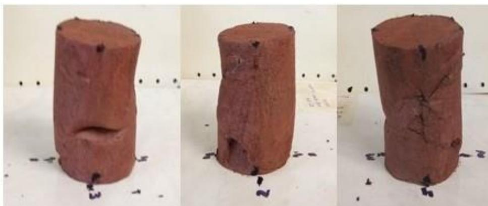
**Figura 61. Corpo de prova utilizado no ensaio F após ensaio de cisalhamento triaxial, com cavidades geradas pelo colapso dos bolsões porosos durante compressão**
