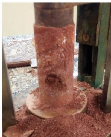
**Figura 60.** Corpo de prova utilizado no ensaio F durante moldagem, ilustrando material poroso de coloração marrom escura no centro da amostra
