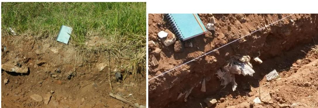
Figura 57 Presença de artefatos na camada de aterro.
