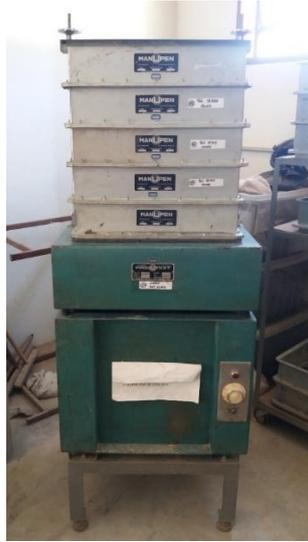
Figura 24 Foto do agitador mecânico do Laboratório de Materiais de Construção, com as peneiras, utilizado no ensaio granulométrico para materiais de aterro e com fragmentos grandes.
