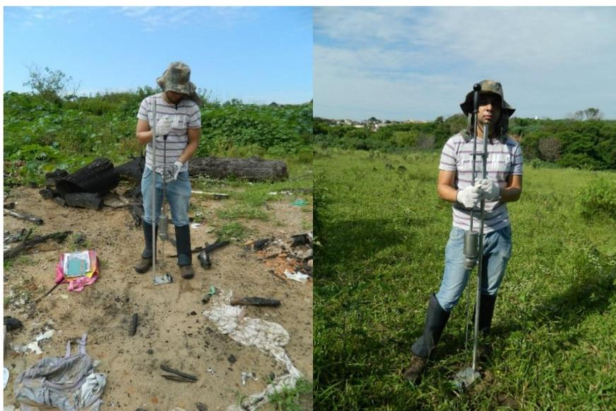
Figura 17 Penetrômetro de impacto utilizado na pesquisa.
