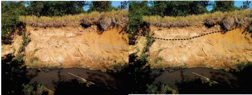
Figura 54 Perfil, mostrando o contato entre o nível de cascalho e os solos residuais da Formação Botucatu.
