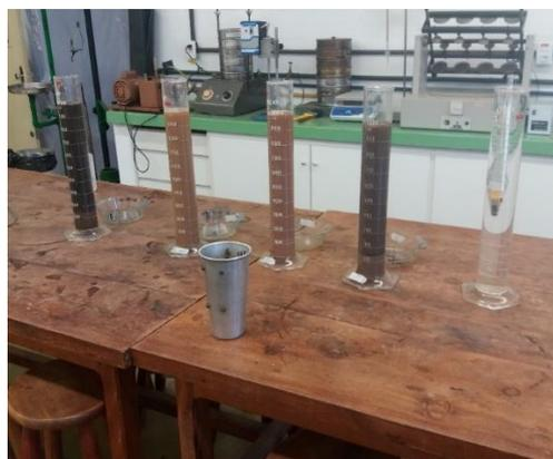
Figura 25 Proveta contendo amostras dos materiais, para o ensaio de sedimentação
