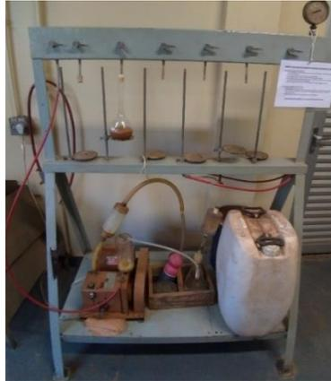
Figura 27 Bomba de Vácuo utilizada para a determinação da massa específica
