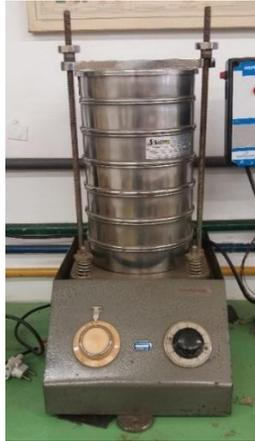
Figura 26 Agitador mecânico com peneiras, do Laboratório de Geociências utilizado para o peneiramento de materiais miúdos
