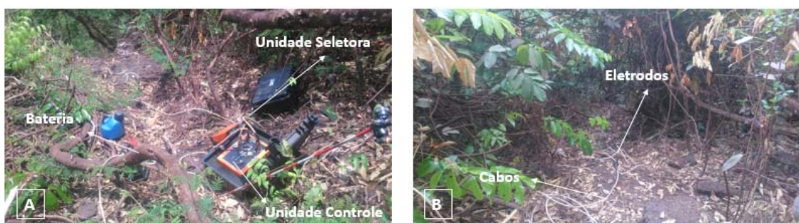
Figura 5.3 - Operação do resistivímetro em campo, cavidade N4E-0022. (A): Equipamento composto por unidade de controle, unidade seletora e bateria; (B): Eletrodos metálicos cravados na superfície e cabos.
