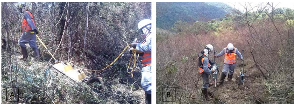
Figura 5.9 - Operação do método GPR em campo, cavidade N4E-0022. (A): Equipamento PulseEKKO Pro com antena de 250 MHz; (B): Equipamento SIR3000 com antena MLF de 80 MHz.
