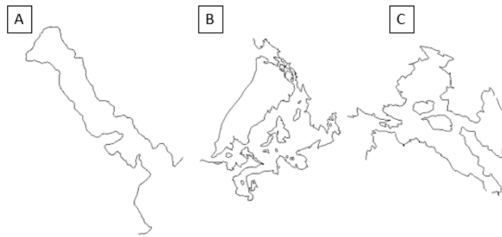
Figura 2.10 - Padrões de cavidades em litologias de ferro. (A): padrão do tipo linear; (B): padrão do tipo irregular; C: padrão do tipo misto (DUTRA, 2013).
