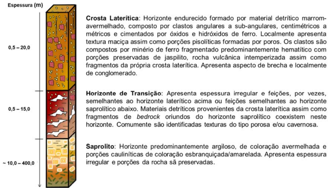
Figura 2.6 - Perfil laterítico esquemático da região de N4EN, Complexo Carajás (adaptado de GONÇALVES et al. , 2016).
