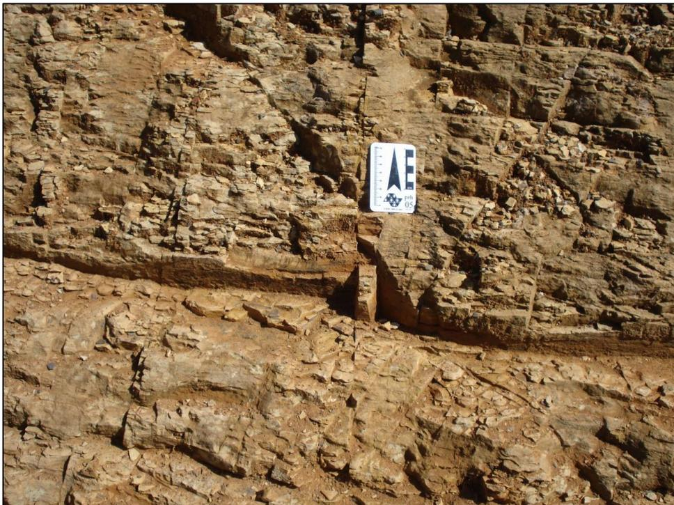
Figura 48: Plano de junta cortado por fratura E-W a montante do reservatório, no ponto 04.
