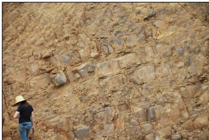
Figura 25: Soleira de diabásio com início de alteração esférica localizada próximo ao desvio para câmara de carga.
