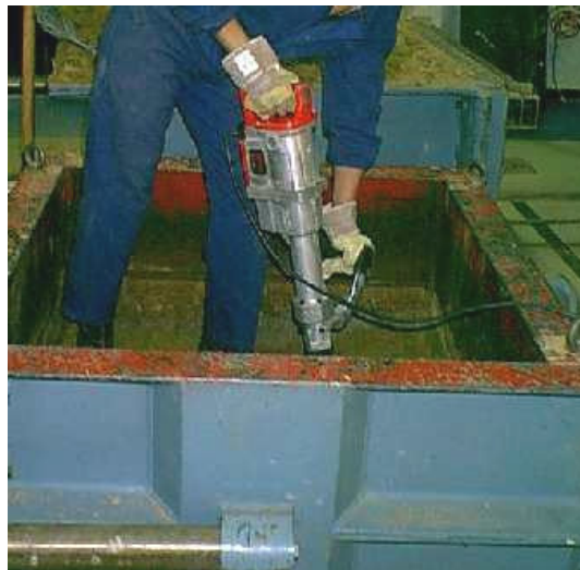
Figura 70 - Simulação Experimental do Dano Mecânico – Malha Metálica
