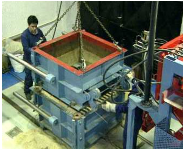
(a) Colocação da caixa superior
