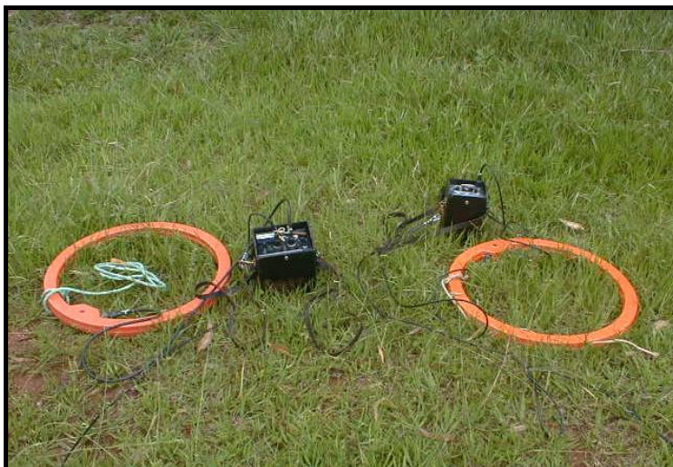
Figura 4.17 - Equipamento EM-34 composto por duas bobinas (transmissora e receptora), um módulo de controle e emissão de corrente elétrica, e um módulo de leitura.
