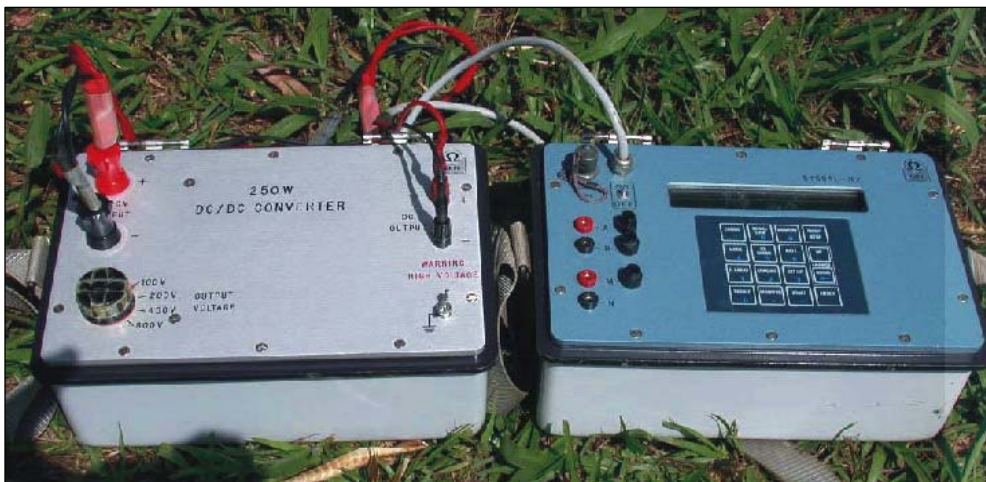
Figura 4.8 - Equipamento Iris Syscal R2, conversor de voltagem, e sistema de emissão e recepção, utilizado para a realização dos ensaios de eletroresistividade e caminhamento IP.
