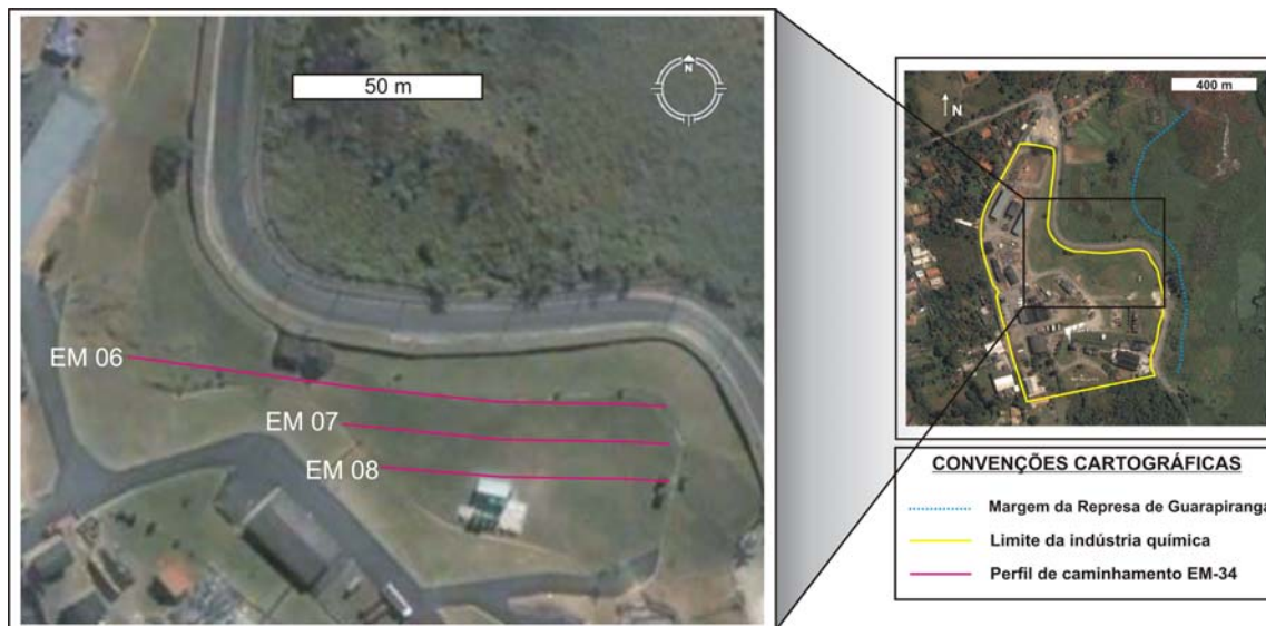
Figura 5.3 - Localização das linhas de caminhamento eletromagnético EM 06 a EM 08, executadas na porção leste da área industrial.
