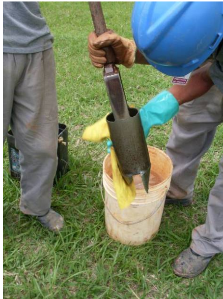
Figura 4.19 - Foto mostrando que a cada nova amostra coletada o trado era devidamente lavado para evitar a contaminação de uma amostra para outra.
