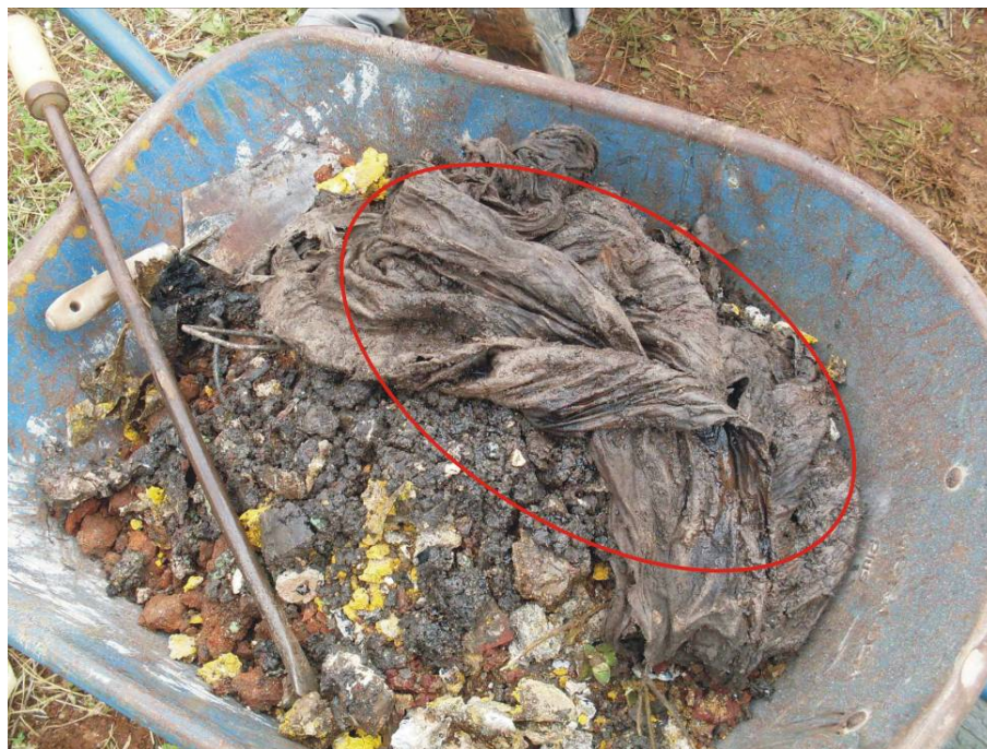
Figura 5.34 - Solo retirado do furo de sondagem SD-01 com aspecto oleoso, coloração amarela e branca com forte cheiro de solvente. Na elipse vermelha, detalhe do pedaço de tecido retirado do furo.
