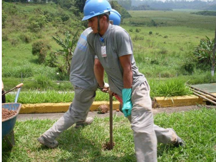
Figura 4.18 - Foto mostrando a execução dos furos de sondagem com trado manual para a coleta das amostras de solo.
