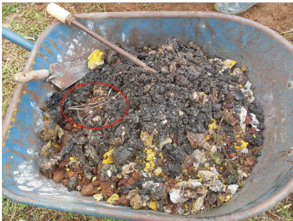
Figura 5.33 - Solo retirado do furo de sondagem SD-01 com aspecto oleoso, coloração amarela e branca com forte cheiro de solvente. Na elipse vermelha, detalhe do pedaço de metal retirado do furo.
