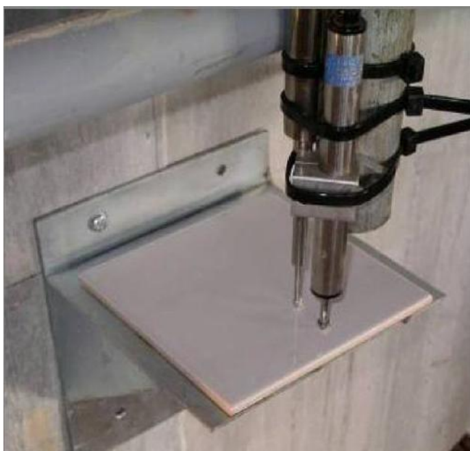
Figura 2.19 – Transdutor de deslocamento (LVDT) usado para medir deslocamento (fonte: cedido à pesquisadora).
