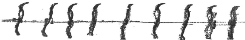
Figura 8 – Exemplo de estaca em final de cravação, cravada com uso de suplemento metálico
