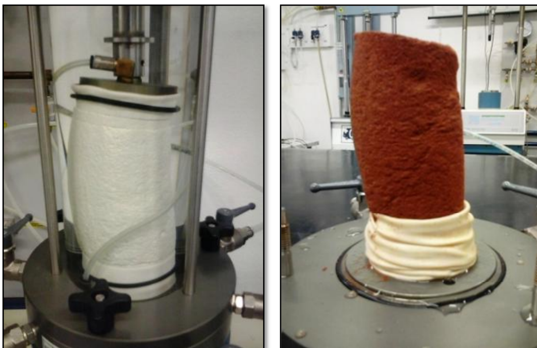
Figura 5.28: Formação de plano de ruptura em ensaio de compressão triaxial
