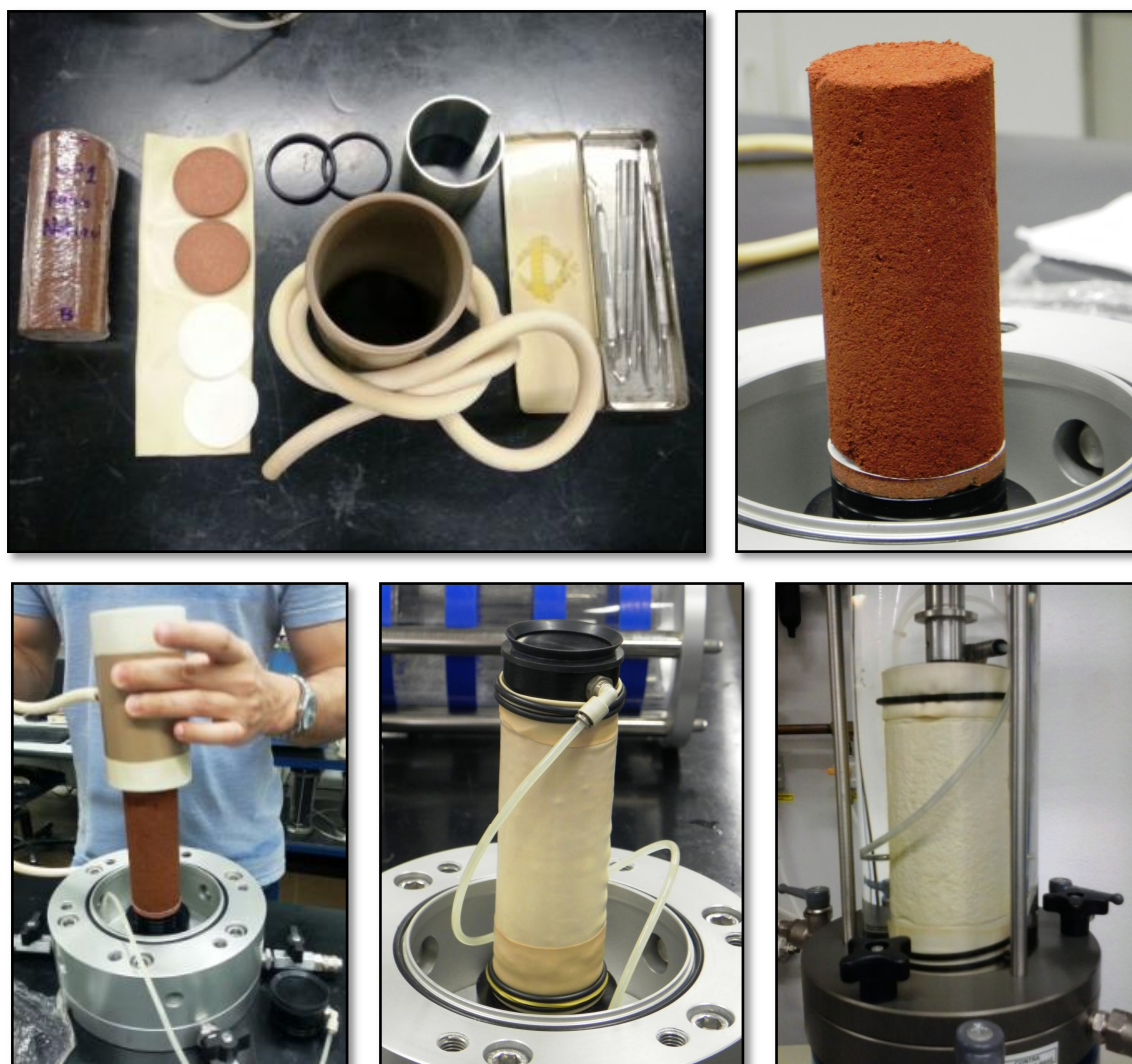
Figura 5.21: Procedimentos para instalação do CP na câmara triaxial
