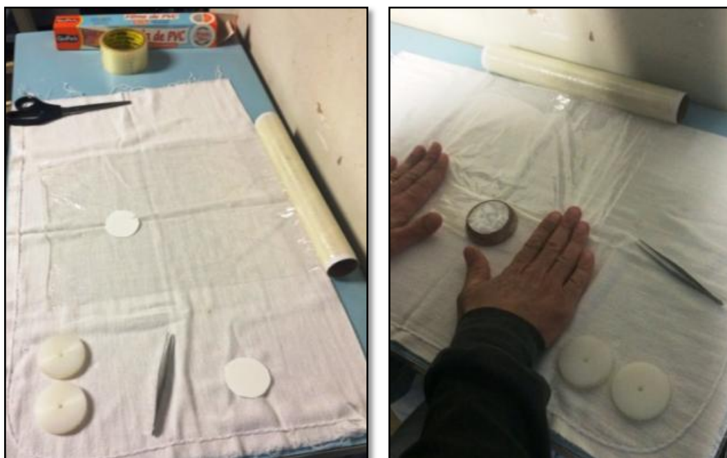
Figura 5.9: Passos para acondicionamento da amostra no ensaio de papel filtro
