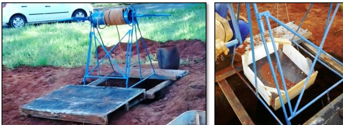
Figura 5.3: Procedimentos de amostragem: (a) guincho manual; (b) plataforma
