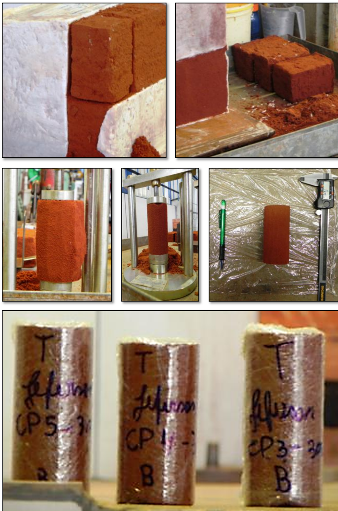
Figura 5.20: Procedimentos de talhagem dos corpos de prova para os ensaios triaxiais
