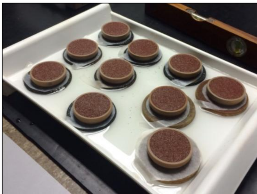
Figura 5.6: Saturação dos CPs utilizados nos ensaios de curva de retenção
