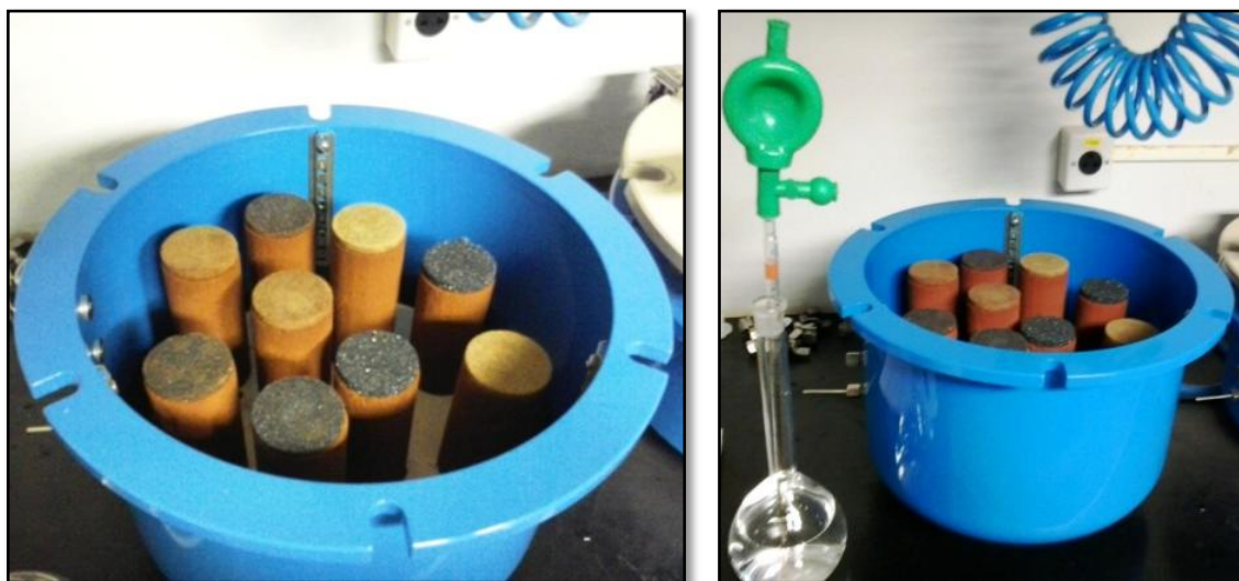
Figura 5.23: Pré-equilíbrio de sucção dos corpos de prova para ensaios triaxiais não saturados
