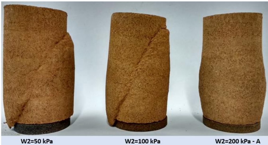
Figura 0-6 Corpos de prova ensaiados no ponto W2.
