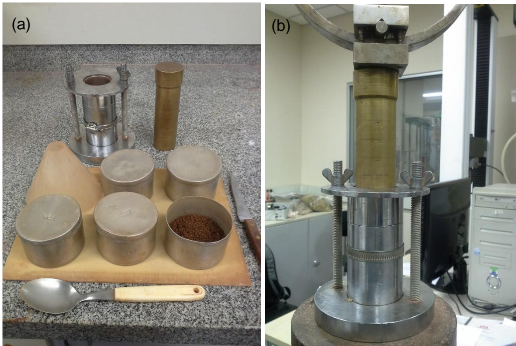
Figura 9-1 – Ferramentas para a moldagem do corpo de prova. (a) Molde cilíndrico tripartido. (b) Prensa, molde e gabarito para moldagem estática do corpo de prova.
