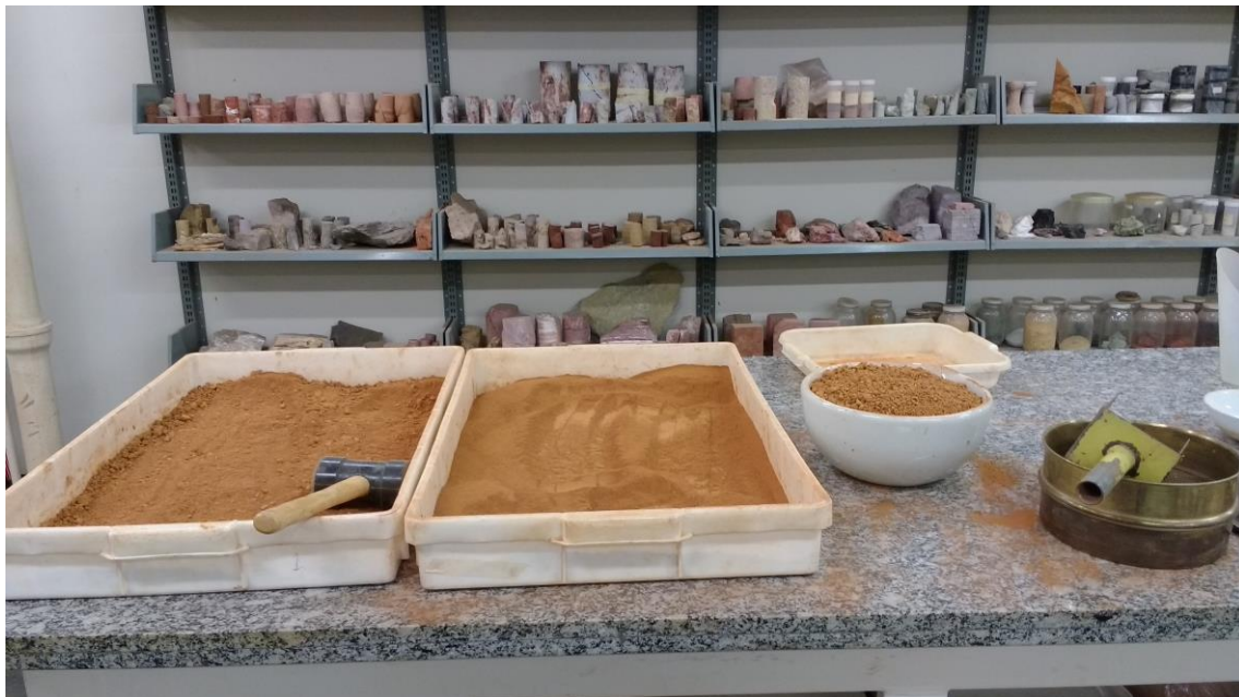
Figura 7-1 - Preparação do rejeito-Mir03 para iniciar os ensaios de caracterização.
