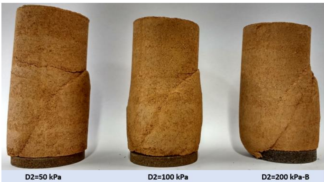
Figura 0-4 Corpos de prova ensaiados no ponto D2.
