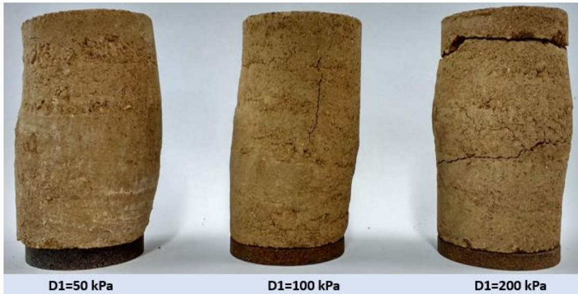
Figura 0-1- Corpos de prova ensaiados no ponto D1.
