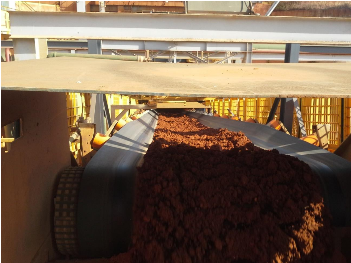
Figura 5-4 – Correia transportadora levando o minério bruto passando pelo extrator de sucatas - Unidade Mirai (Acervo pessoal, fev./2016).
