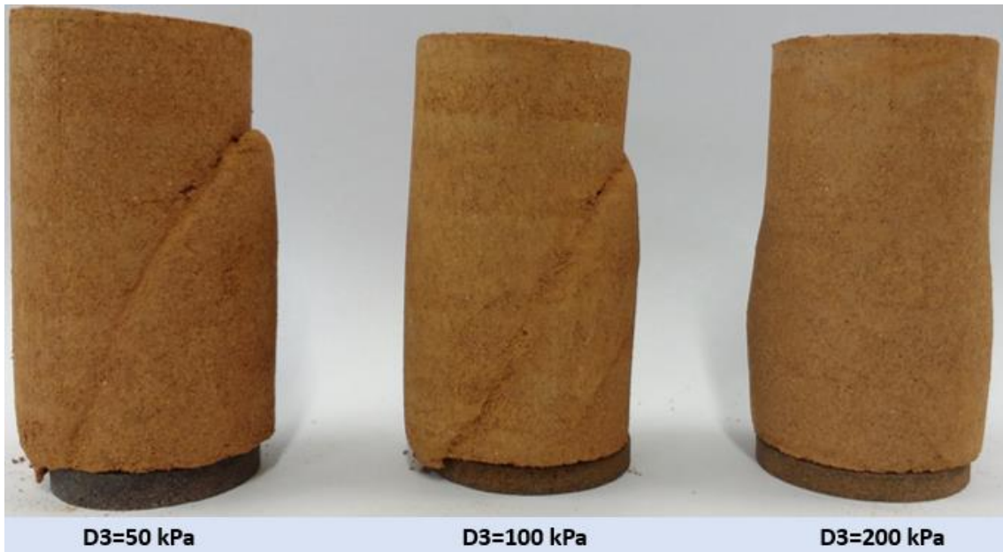
Figura 0-7 Corpos de prova ensaiados no ponto D3
