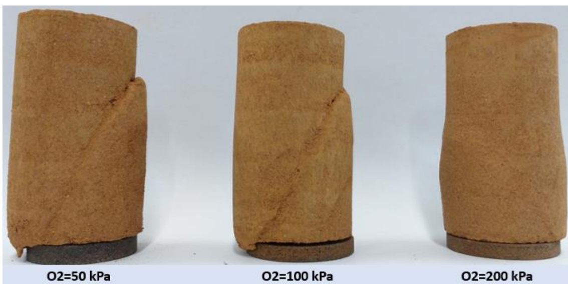
Figura 0-5 Corpos de prova ensaiados no ponto O2.
