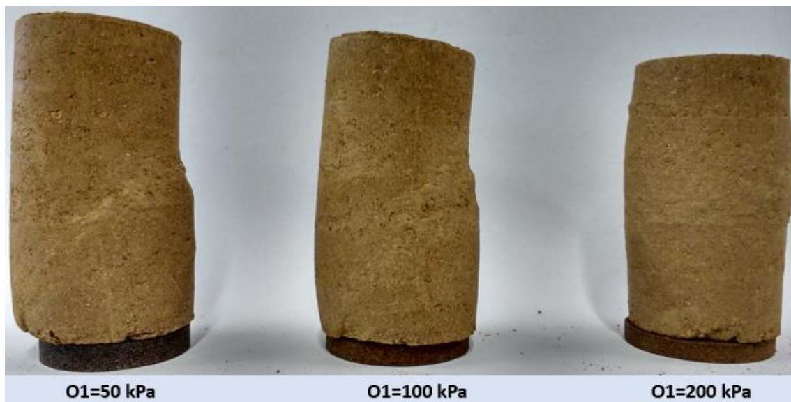
Figura 0-2 Corpos de prova ensaiados no ponto O1.
