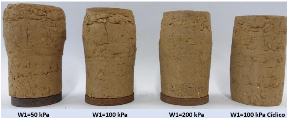
Figura 0-3 Corpos de prova ensaiados no ponto W1.
