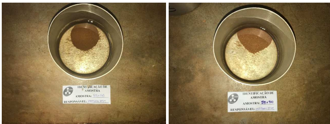
Figura 5.21 – Produto das esferas das amostras km 513+243 (a esquerda) e km 519+900 (a direita) imersas em água
