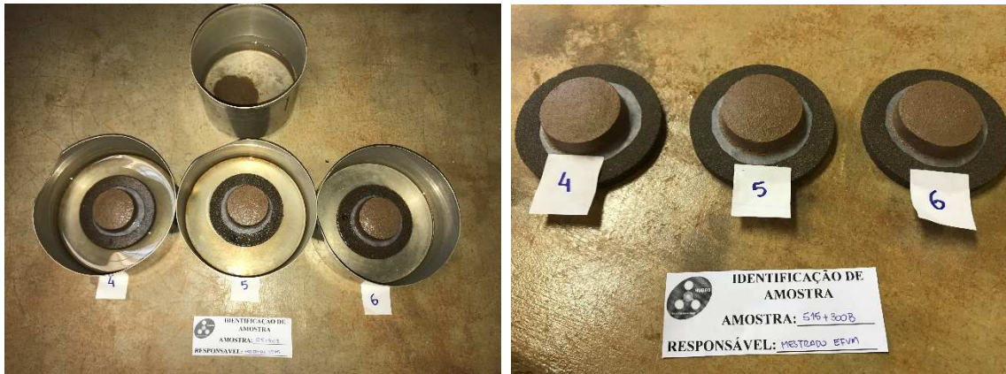
Figura 5.19 – Pastilhas sobre placa porosa saturada com água destilada e papel filtro (a esquerda) e após as 3 h de ensaio (amostra referente ao talude do km 515+300)
