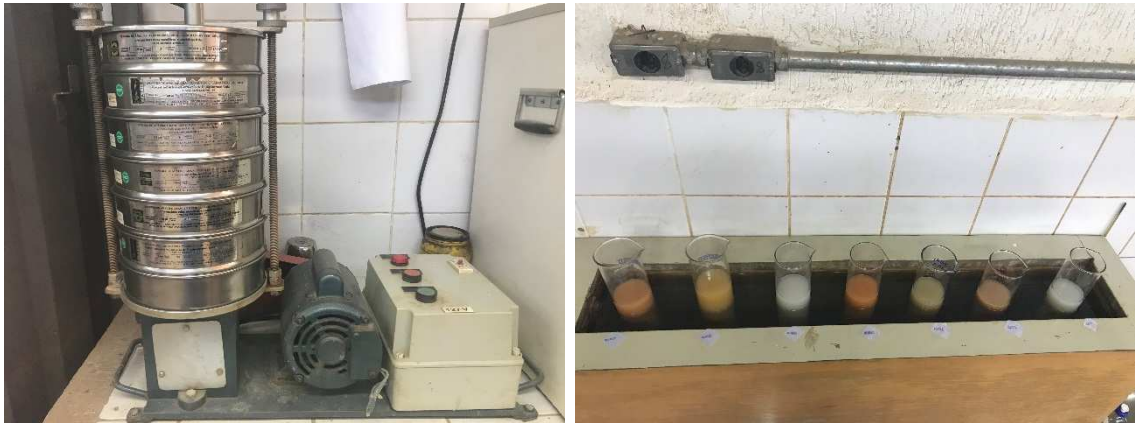
Figura 5.14 – Ensaio de peneiramento (a esquerda) e sedimentação no tanque para banho (a direita)
