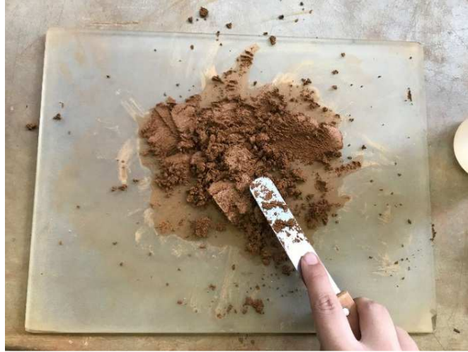
Figura 5.17 – Espatulação da amostra sobre placa de vidro fosca.
