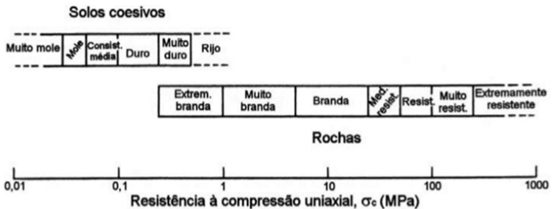
Figura 3.14 – Classificação de solo e rocha a partir da resistência à compressão uniaxial de acordo com a ISRM (1978) (adaptado de Pinho, 2003)
