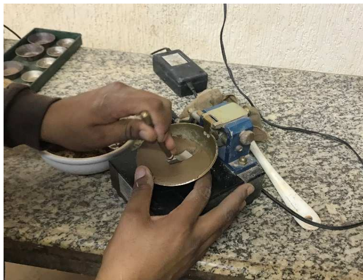
Figura 5.15 – Ensaio para determinação do limite de liquidez
