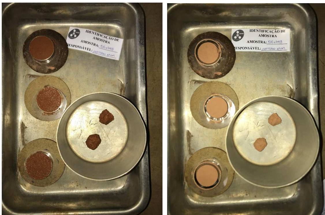
Figura 5.18 – Pastilhas e esferas moldadas na condição de moldagem do ensaio (a esquerda) e após a secagem em estufa a 60° C (a direita)
