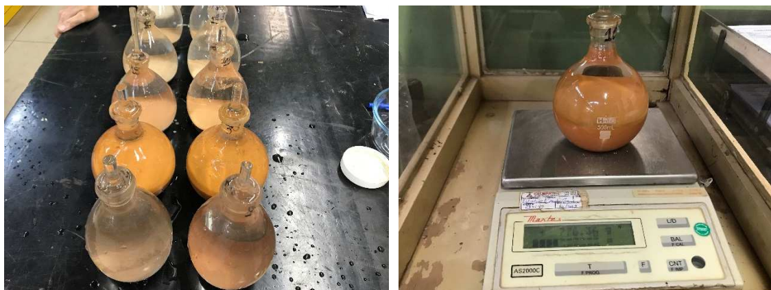
Figura 5.16 – Ensaio para determinação da massa específica real dos grãos
