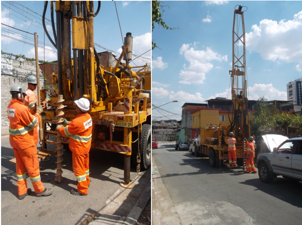
Figura 3.3 – Execução do ensaio piezocone na Ilha de ensaio 5221.
